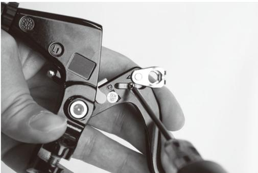
2. Den Modusschalter an der Position der montierten Bremse ausrichten.
