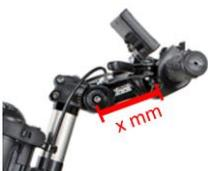
**Einstellbare Lenkerverbindung 130 mm**
