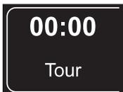
Die Zeit, in der Sie eine oder mehrere Touren gefahren sind; ein Stillstand des Pedelecs wird nicht mitgerechnet. Die Berechnung der Fahrzeit erfolgt ab jedem „Tour-Reset“.
