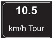
Ihre durchschnittliche Geschwindigkeit pro Tour. Die Berechnung der Durchschnittsgeschwindigkeit erfolgt ab jedem „Tour-Reset“ und wird nach einer Fahrzeit von 10 Minuten angezeigt.
