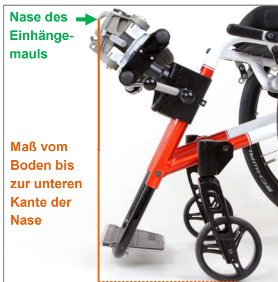
Abbildung 9: Maß vom Boden bis zur unteren Kante der Nase des Einhängemauls
