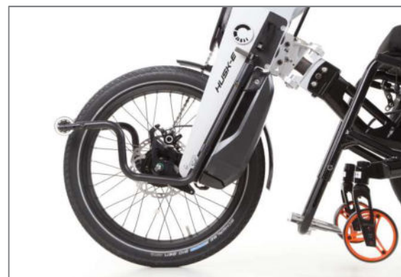
Abbildung 8: Abstellständer in Passivposition
