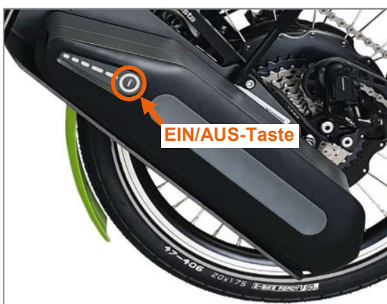
Abbildung 36: Ein- und Ausschalttaste am neodrives Akku
