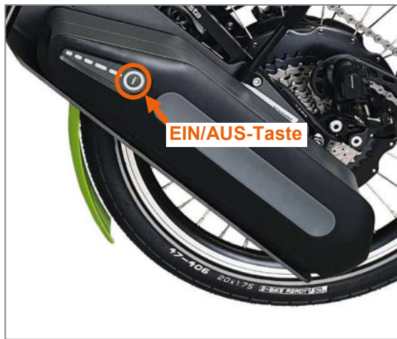
Abbildung 41: Ein- und Ausschalttaste am Akku
