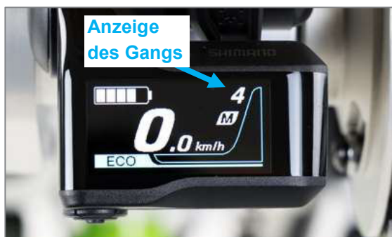
Abbildung 25: Anzeige des aktuellen Gangs im Display (Shimano)
