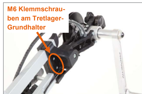
Abbildung 20: M6 Klemmschrauben am Tretlager-Grundhalter für die Verstellung der Länge
