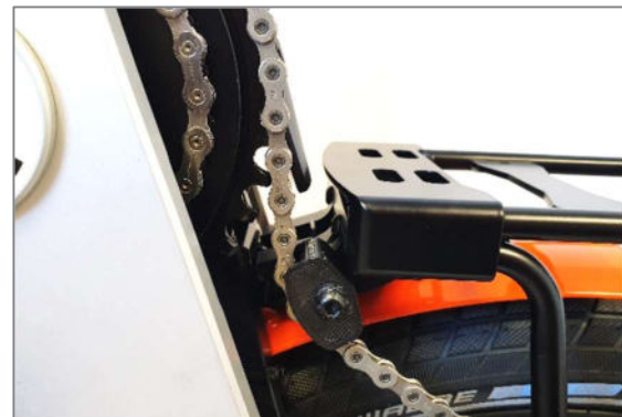
Abbildung 54: Gepäckträger angebracht, Kettenumlenkschuh spannt Kette
