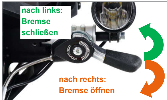
Abbildung 30: Feststellbremse über Rasthebel
