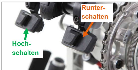
Abbildung 28: Kinnbedienung über Taster
