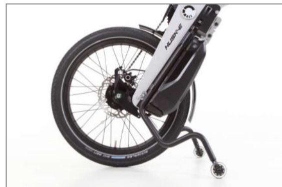
Abbildung 7: Abstellständer in Aktivposition
