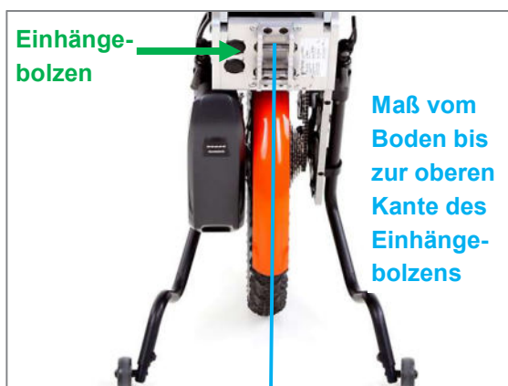
Abbildung 10: Maß vom Boden bis zur oberen Kante des Einhängebolzens
