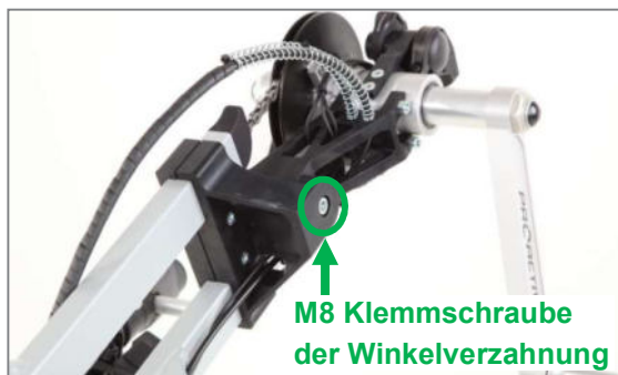
Abbildung 17: M8 Klemmschraube der Winkelverzahnung zur Winkelverstellung der Tretlagerposition
