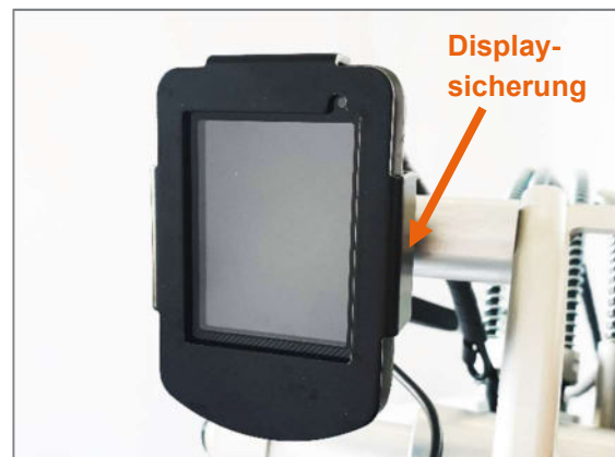
Abbildung 43: Display mit Displaysicherung
