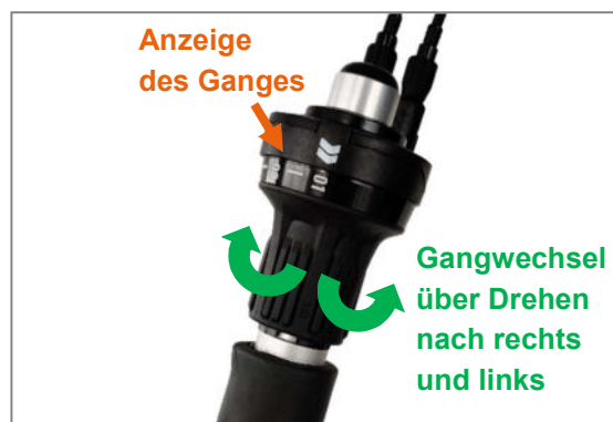
Abbildung 27: Schalten über Drehgriff bei Pinion-Getriebeschaltung
