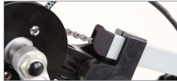
Abbildung 19: Kunststoff-Kettenführungen im Rechteckrohr
