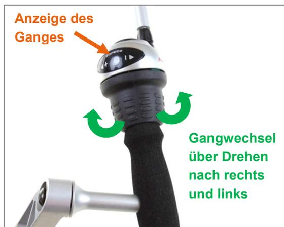
Abbildung 17: Schalten über Drehgriff bei Shimano Nexus Nabenschaltung
