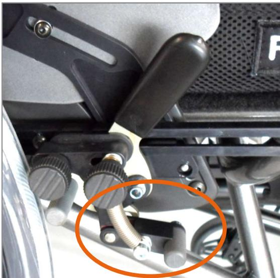
Abbildung 2: Rückrollsicherung
