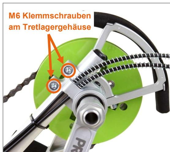
Abbildung 13: M6 Klemmschrauben am Tretlagergehäuse für die Höhenverstellung der Tretlagerposition und den Austausch der Tretlagerstütze
