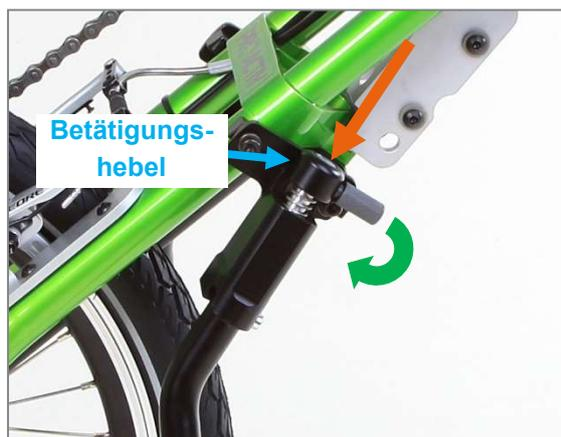
Abbildung 6: Nach unten Drücken und Drehen des Betätigungshebels
