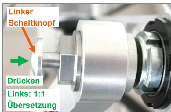
Abbildung 18: Linker Schaltknopf der Tretlagerschaltung
