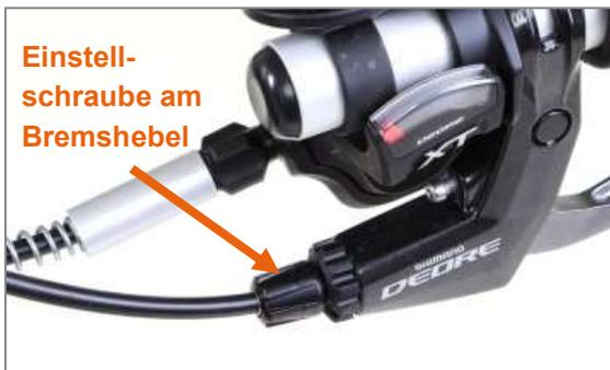
Abbildung 22: Einstellschraube am Bremshebel
