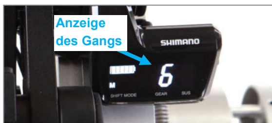
Abbildung 26: Anzeige des aktuellen Gangs im Display (neodrive)
