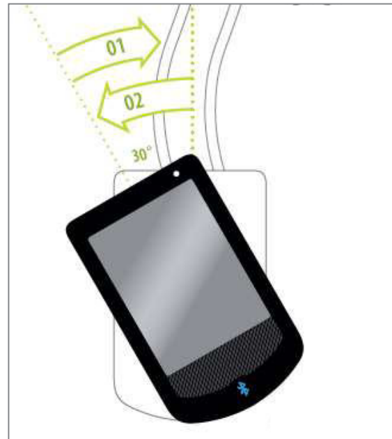
Abbildung 42: Anbringung und Abnahme des Displays
