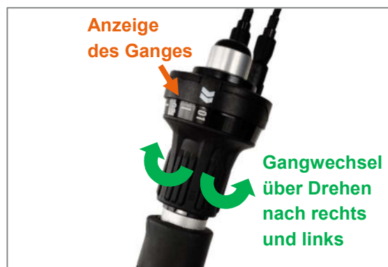
Abbildung 27: Schalten über Drehgriff bei Pinion-Getriebeschaltung
