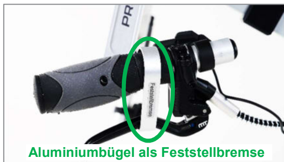
Abbildung 31: Aluminiumbügel als Feststellbremse
