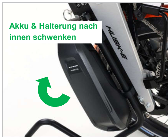
Abbildung 38: Zur Befestigung Akku & Halterung nach innen schwenken
