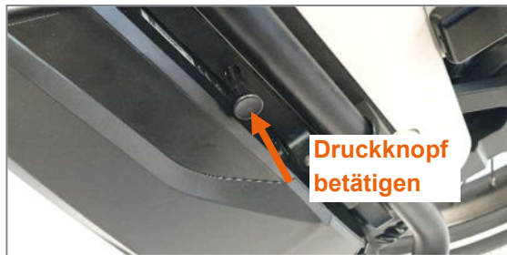
Abbildung 37: Druckknopf der schwenkbaren Akkuhalterung betätigen
