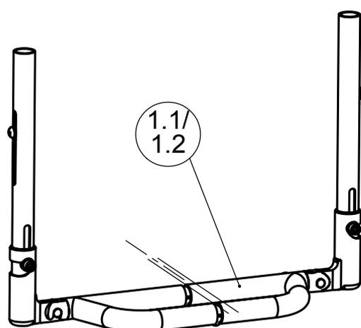
**Fußbügel durchgehend, einseitig hochklappbar, nach außen schwenkbar, höhenverstellbar**
