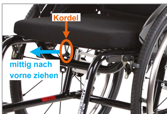
Abbildung 54: Kordel für die Betätigung der Rastbolzen
