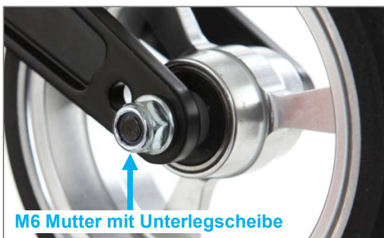
Abbildung 82: M6 Mutter der Lenkradachse (Ansicht von Produktinnenseite)
