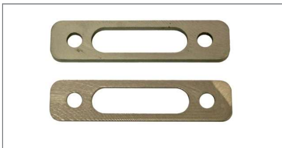
Abbildung 67: Zwei Spurdistanzen mit unterschiedlicher Materialstärke
