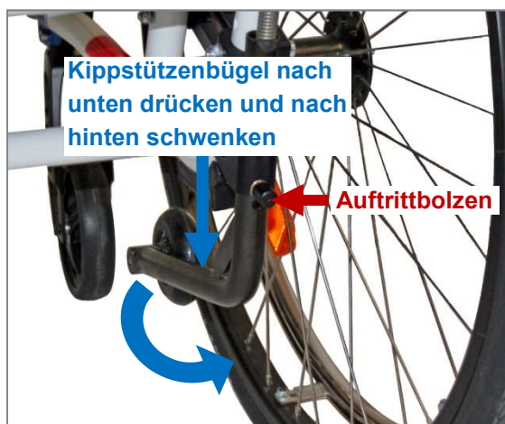
Abbildung 123: Kippstütze in Betriebsstellung bringen (Ansicht von hinten)
