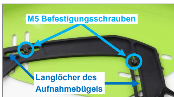
Abbildung 58: M5 Befestigungsschrauben und Langlöcher des Aufnahmebügels
