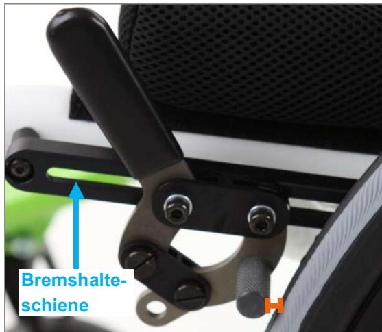
Abbildung 135: Abstand zwischen Bremsbolzen und Bereifung von ca. 3 bis maximal 4 mm bei geöffneter Bremse
