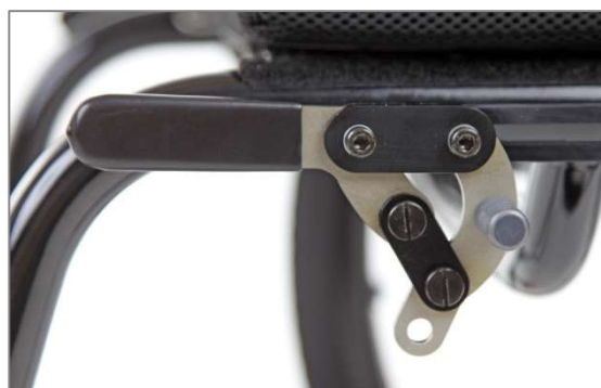
Abbildung 131: Kniehebelbremssystem mit Bremshebel Standard
