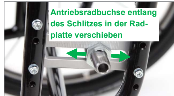
Abbildung 18: Antriebsradbuchse entlang des Schlitzes in der Radplatte verschieben (Ansicht von Produktaußenseite)
