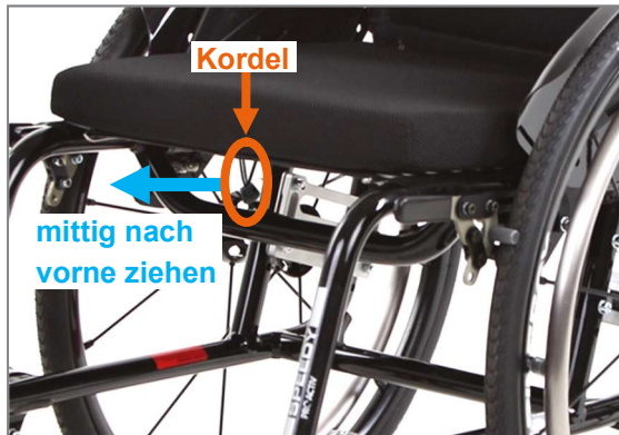
Abbildung 22: Kordel für die Betätigung der Rastbolzen und damit zur Verstellung des Rückenlehnenwinkels
