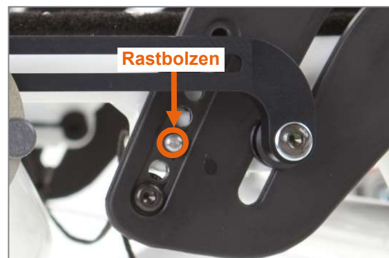
Abbildung 21: Rastbolzen greift in das Arretierloch im Seitenteil (Ansicht von Produktaußenseite, ohne Kleiderschutz)
