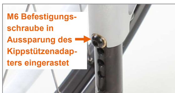
Abbildung 124: Kippstütze ordnungsgemäß eingerastet
