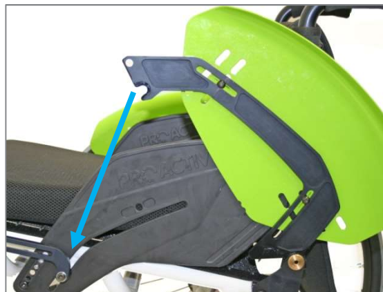
Abbildung 56: Aufnahmebügel auf Rückengelenkwelle aufgesteckt (Ansicht ohne Antriebsrad)
