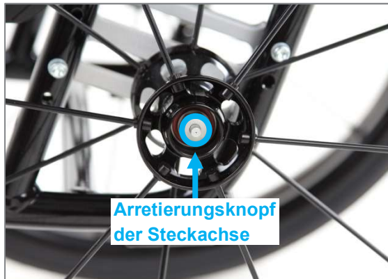
Abbildung 62: Arretierungsknopf der Steckachse in der Mitte der Radachse
