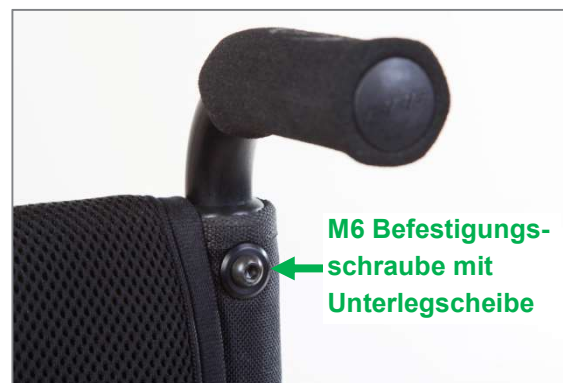
Abbildung 141: Aluminium-Schiebegriffe fest im Rückenrohr montiert
