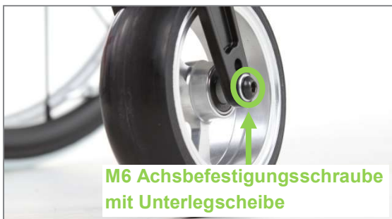
Abbildung 81: M6 Achsbefestigungsschraube der Lenkradachse (Ansicht von Produktaußenseite)
