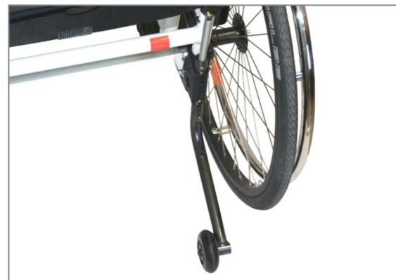
Abbildung 121: Betriebsstellung der Kippstütze (Ansicht von hinten)
