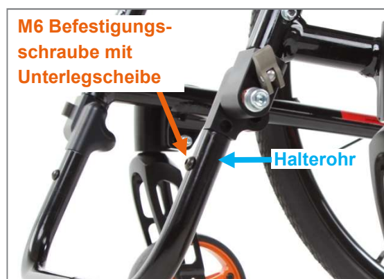
Abbildung 107: M6 Befestigungsschraube mit Unterlegscheibe zur Einstellung der Unterschenkelänge
