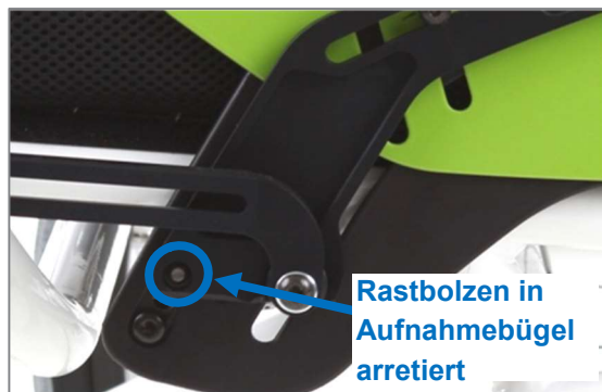
Abbildung 52: Rastbolzen in Aufnahmebügel des Kleiderschutzes arretiert (Ansicht mit Kleiderschutz)
