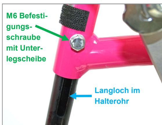
Abbildung 102: M6 Befestigungsschraube mit Unterslegscheibe und Langloch im Fußstützen-Halterohr zur Einstellung der Unterschenkellänge
