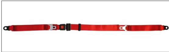
Abbildung 150: Beckengurt mit Gurtschloss, den Befestigungsbeschlägen zur Anbindung an die Kraftknoten und zwei Schlosszungen zur wahlweisen Befestigung des Schulterschräggurtes
