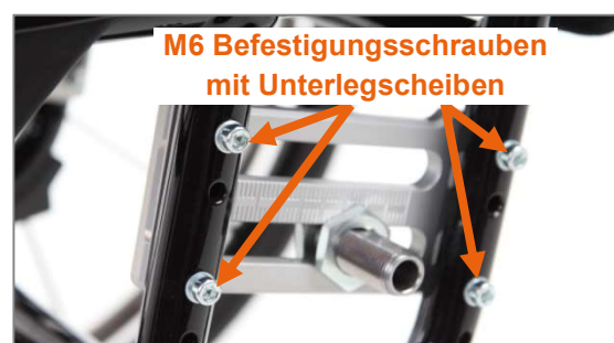
Abbildung 7: M6 Befestigungsschrauben der Radplatte
