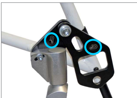
Abbildung 157: Lenkradlagerblockzwischenplatte mit Gurtöse für Retraktor vorne
