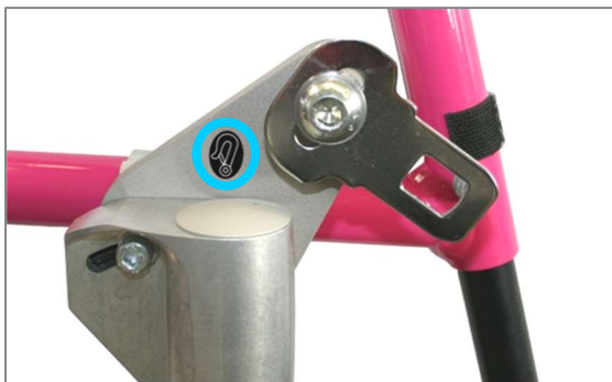
Abbildung 156: Lenkradlagerblockzwischenplatte mit Schlosszunge für Retraktor vorne
