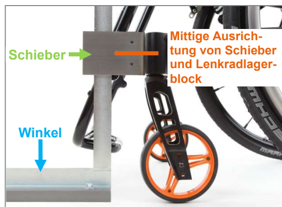
Abbildung 90: Überprüfung der Einstellung der Lenkradgabel-drehachsen
