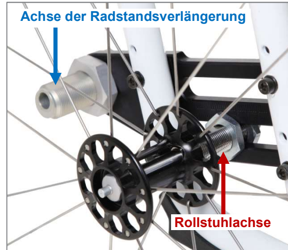
Abbildung 76: Radstandsverlängerung über verlängerte Radplatte
