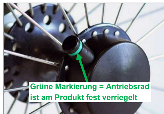
Abbildung 65: Tetra-Clip mit verriegelter Steckachse
