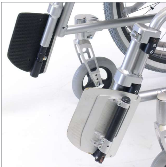
Abbildung 116: Beide Fußstützenteile hochgeklappt und nach außen gedreht
