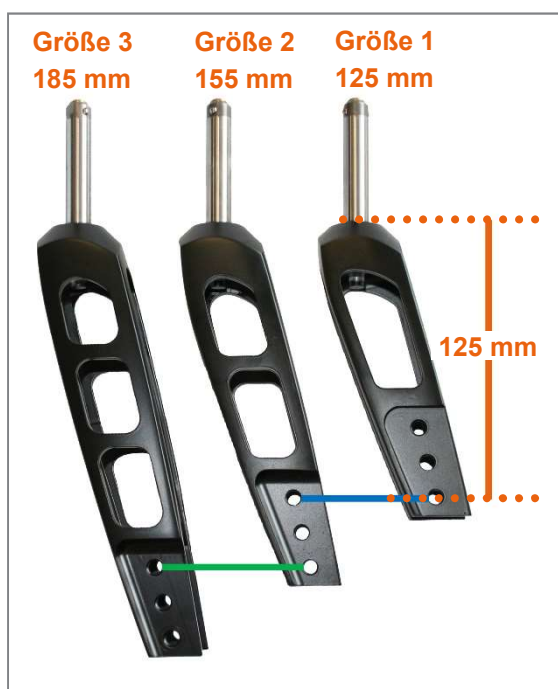
Abbildung 14: Lenkradgabelgrößen mit Kennzeichnung der gleichen Sitzhöhereinstellungen bei verschiedenen Lenkradgabelgrößen
