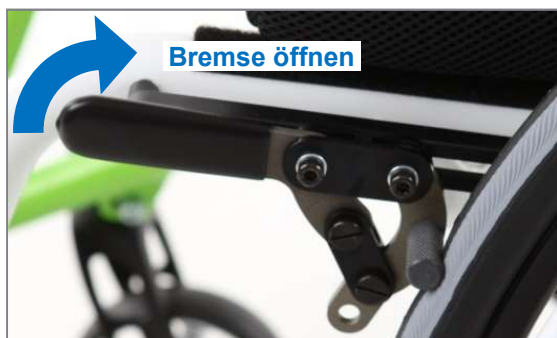
Abbildung 133: Bremse geschlossen; Öffnen erfolgt durch nach hinten-oben Ziehen des Bremshebels
