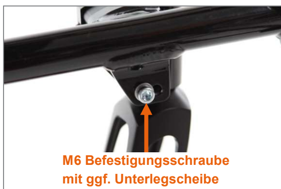
Abbildung 92: M6 Befestigungsschraube an der Rahmeninnenseite, Unterlegscheibe bei G-Form-Rahmen vorhanden, bei V-Form-Rahmen nicht
