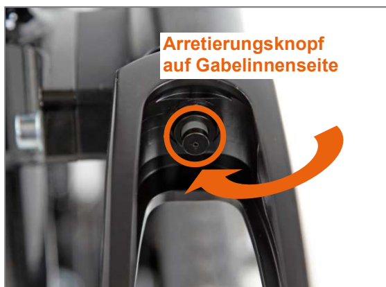
Abbildung 89: Lenkradgabel mit Steckachse und Arretierungsknopf
