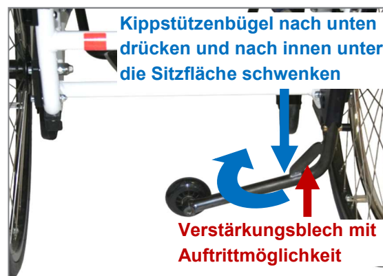
Abbildung 125: Kippstütze in Passivstellung bringen (Ansicht von hinten)
