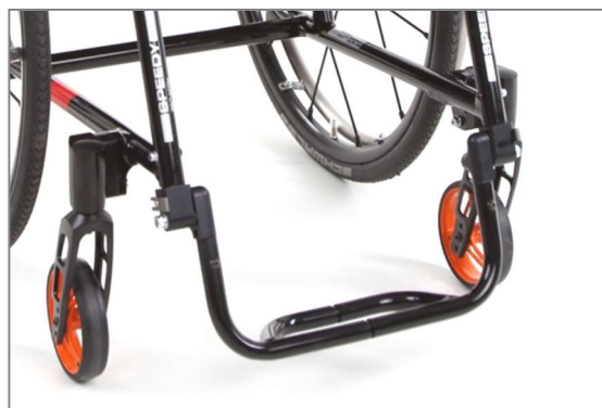
Abbildung 103: Fußstütze nach hinten hochfaltbar, in Standardposition
