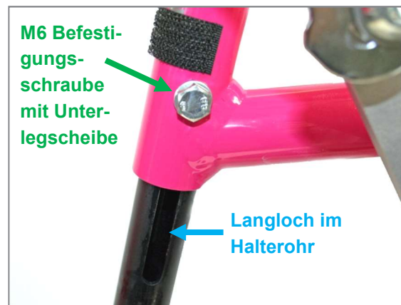
Abbildung 114: M6 Befestigungsschraube mit Unterslegscheibe und Langloch im Fußstützen-Halterohr zur Einstellung der Unterschenkellänge
