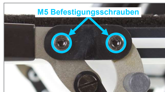
Abbildung 134: M5 Befestigungsschrauben an der Bremshalteschiene
