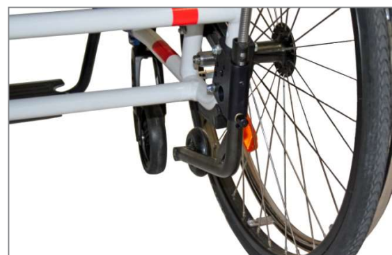
Abbildung 122: Passivstellung der Kippstütze (Ansicht von hinten)
