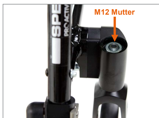
Abbildung 88: Alu-Kappe abgenommen und M12 Mutter sichtbar
