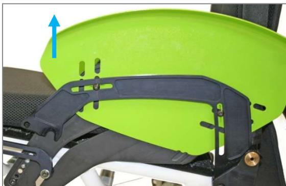
Abbildung 55: Kleiderschutz vorne aus der Seitenblechführung gezogen (Ansicht ohne Antriebsrad)
