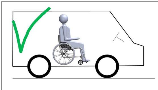
Abbildung 161: Richtige Ausrichtung des Rollstuhls im Fahrzeug
