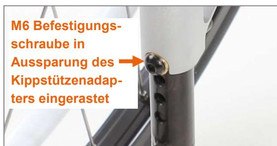
Abbildung 124: Kippstütze ordnungsgemäß eingerastet
