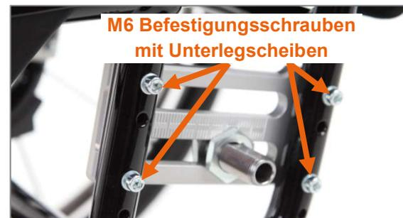
Abbildung 7: M6 Befestigungsschrauben der Radplatte
