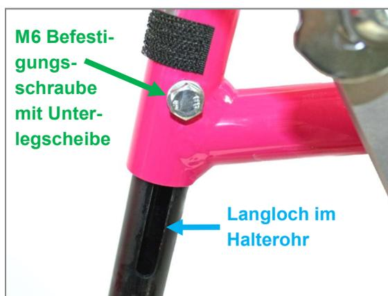
Abbildung 102: M6 Befestigungsschraube mit Unterlegscheibe und Langloch im Fußstützen-Halterohr zur Einstellung der Unterschenkellänge
