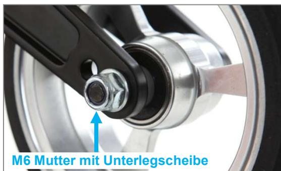
Abbildung 82: M6 Mutter der Lenkradachse (Ansicht von Produktinnenseite)
