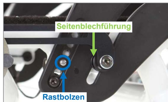
Abbildung 51: Rastbolzen greift in das Arretierungsloch im Seitenteil (Ansicht ohne Kleiderschutz)
