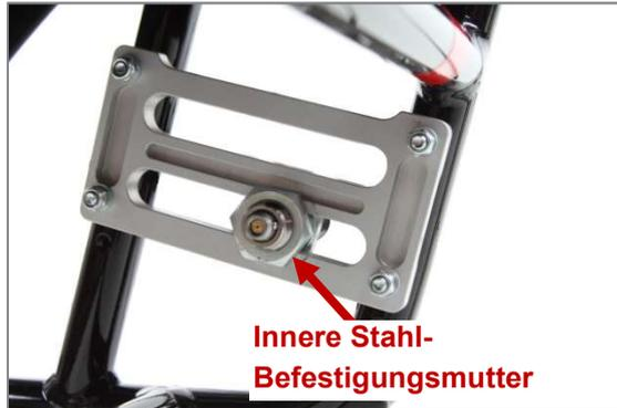
Abbildung 5: Innere Stahl-Befestigungsmutter (Ansicht von Produktinnenseite, Antriebsrad abgenommen)
