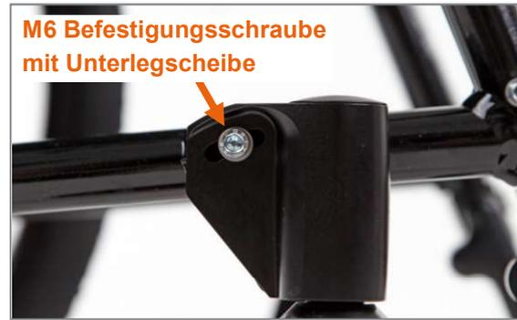
Abbildung 93: M6 Befestigungsschraube an der Rahmenaußenseite
