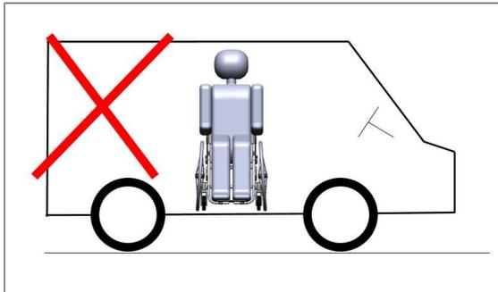
Abbildung 160: Falsche Ausrichtung des Rollstuhls im Fahrzeug
