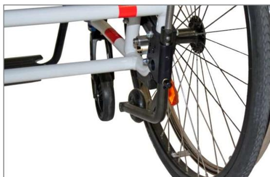
Abbildung 122: Passivstellung der Kippstütze (Ansicht von hinten)
