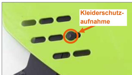
Abbildung 57: Kleiderschutzaufnahme
