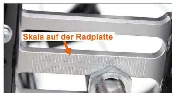
Abbildung 19: Skala auf der Radplatte
