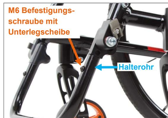
Abbildung 107: M6 Befestigungsschraube mit Unterlegscheibe zur Einstellung der Unterschenkellänge
