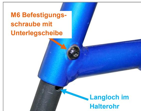
Abbildung 96: M6 Befestigungsschraube mit Unterlegscheibe und Langloch im Fußstützen-Halterohr zur Einstellung der Unterschenkelhöhe
