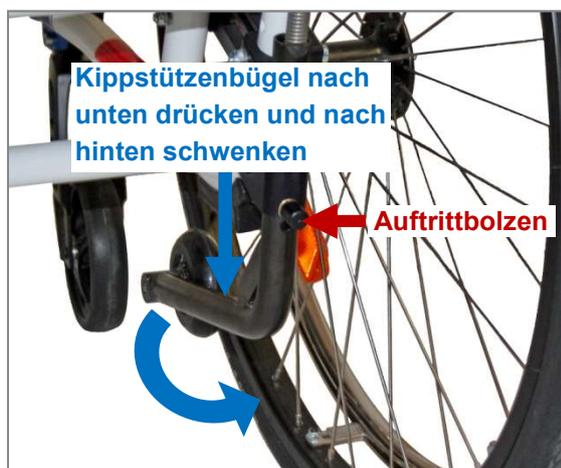
Abbildung 123: Kippstütze in Betriebsstellung bringen (Ansicht von hinten)
