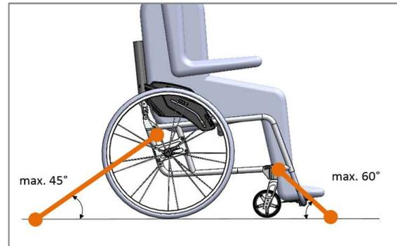
Abbildung 162: Verlauf der Retraktoren vorne und hinten mit maximalem Abspannwinkel und Anbindepunkten (Ansicht von der Seite)
