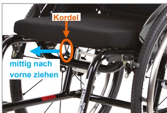
Abbildung 54: Kordel für die Betätigung der Rastbolzen
