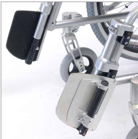
Abbildung 116: Beide Fußstützenteile hochgeklappt und nach außen gedreht
