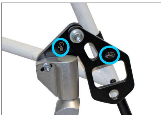
Abbildung 157: Lenkradlagerblockzwischenplatte mit Gurtöse für Retraktor vorne
