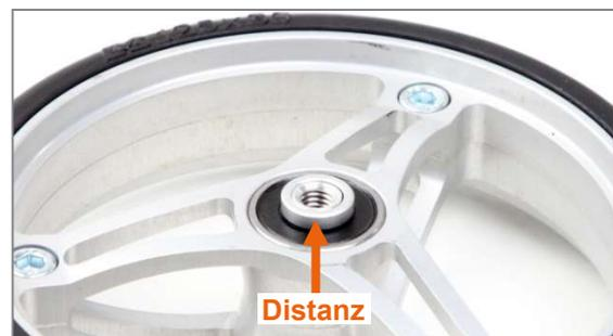
Abbildung 80: Distanz am Lenkrad
