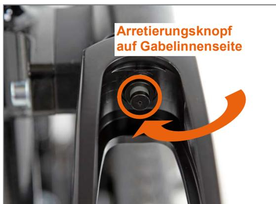
Abbildung 89: Lenkradgabel mit Steckachse und Arretierungsknopf
