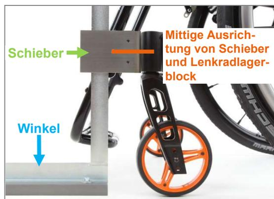
Abbildung 90: Überprüfung der Einstellung der Lenkradgabel-drehachsen
