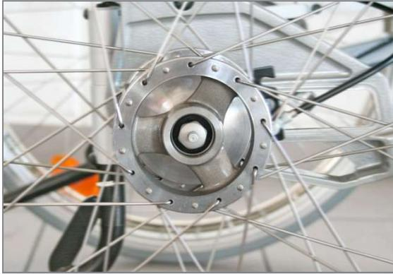
Abbildung 138: Trommelbremse
