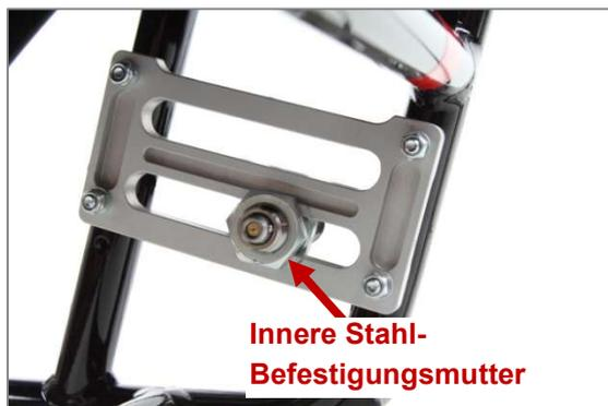
Abbildung 17: Innere Stahl-Befestigungsmutter (Ansicht von Produktinnenseite, Antriegsrad abgenommen)
