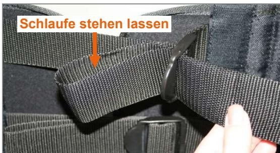
Abbildung 38: Schritt 7: Doppelte Durchführung
