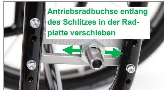
Abbildung 18: Antriegsradbuchse entlang des Schlitzes in der Radplatte verschieben (Ansicht von Produktaußenseite)
