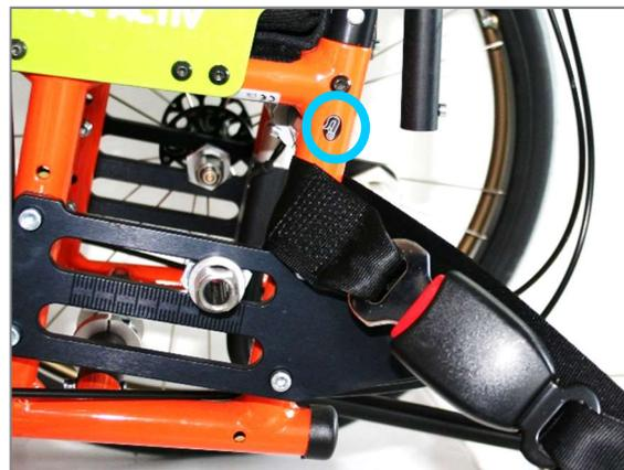
Abbildung 159: Symbol für hintere Befestigung und Umschlaufung des Rollstuhls hinten
