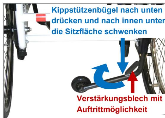
Abbildung 125: Kippstütze in Passivstellung bringen (Ansicht von hinten)
