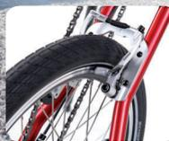
Effektive Bremsen. Die integrierte Rücktrittbremse in der Nabenschaltung sorgt für einfache und intuitive Bedienung. Zusätzlich bietet eine hochwertige Felgenbremse zuverlässige Bremskraft.
