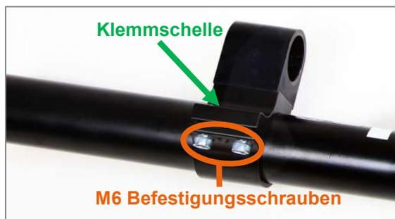
Abbildung 26: M6 Befestigungsschrauben zur horizontalen Positionierung der Zentrierzapfenaufnahme entlang des Aufnahmerohres
