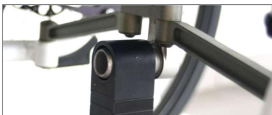
Abbildung 10: Zentrierzapfen mit aufgesteckter Zentrierzapfenaufnahme
