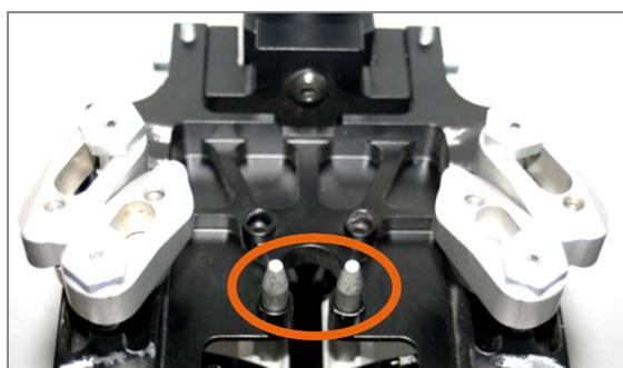
Abbildung 30: Zentrierstifte montiert für schmales Mittelteil
