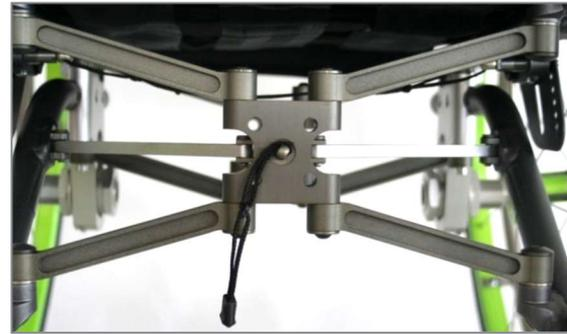
Abbildung 16: Position Auslöseschnur falsch, Bohrungen für Zentrierstifte unten links verdeckt
