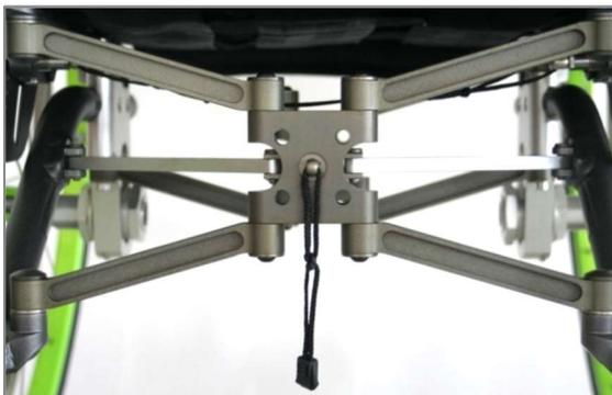
Abbildung 15: Position Auslöseschnur richtig, Bohrungen für Zentrierstifte frei
