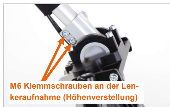
Abbildung 23: M6 Klemmschrauben für die Höhenverstellung der Lenkerposition
