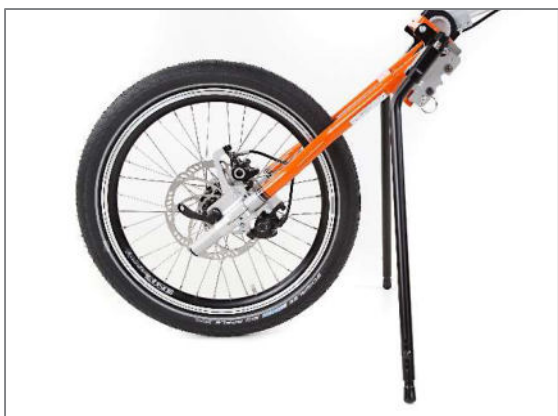
Abbildung 17: Abstellständer in Aktivposition
