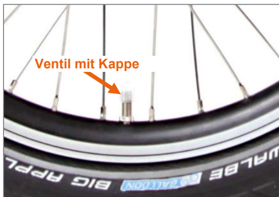
Abbildung 13: Ventil mit Kappe
