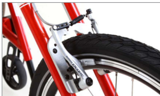
Abbildung 10: Felgenbremse eingehängt und Zuglänge richtig eingestellt
