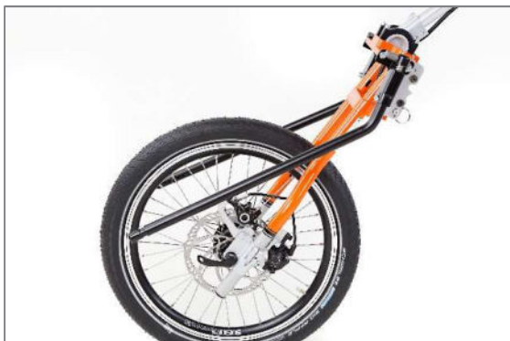
Abbildung 18: Abstellständer in Passivposition
