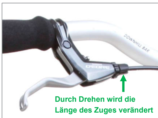
Abbildung 3: Bremshebel mit Verstellmöglichkeit der Zuglänge
