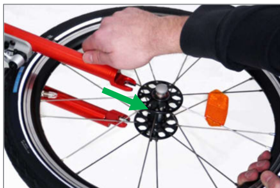
Abbildung 8: Rad nach unten herausziehen
