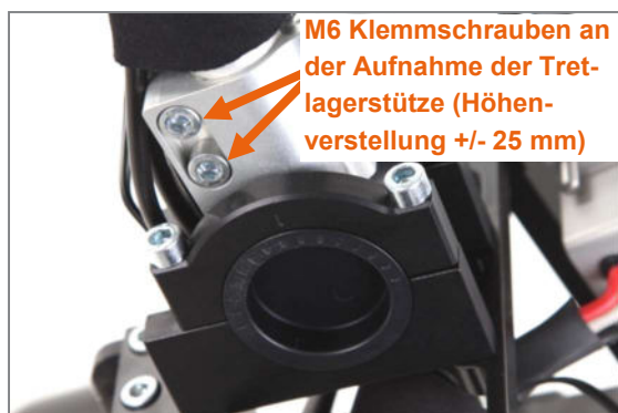
Abbildung 15: M6 Klemmschrauben für die Höhenverstellung der Tretlagerposition
