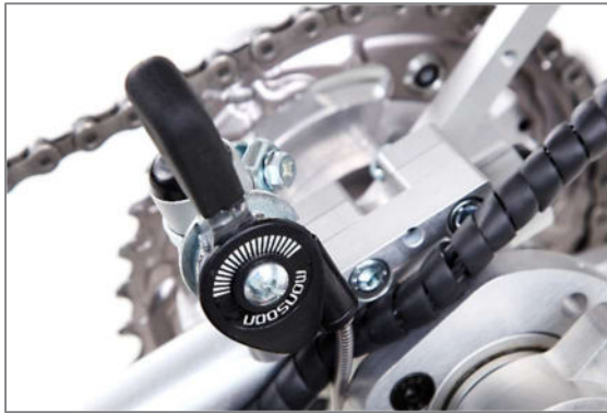
Abbildung 37: Feststellbremse über Rasthebel
