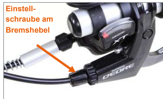
Abbildung 35: Einstellschraube am Bremshebel
