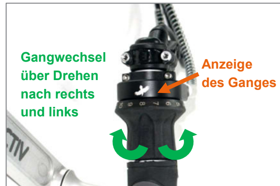
Abbildung 23: Schalten über Drehgriff bei Rohloff Nabenschaltung
