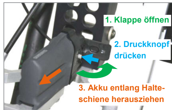
Abbildung 28: Akku zum Laden entnehmen
