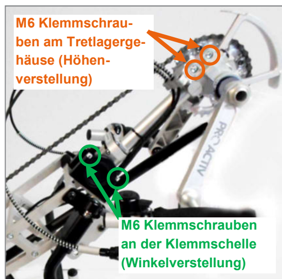
Abbildung 14: M6 Klemmschrauben für Winkel- und Höhenverstellung der Tretlagerposition
