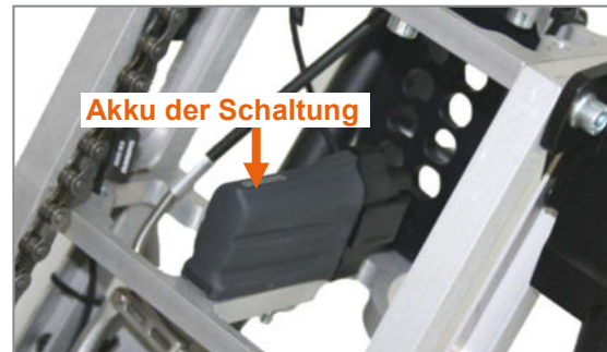
Abbildung 27: Akku der elektronischen Schaltung Alfine Di2
