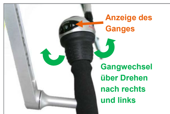
Abbildung 24: Schalten über Drehgriff bei Shimano Nexus Nabenschaltung
