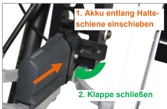
Abbildung 30: Akku nach dem Laden wieder anschließen
