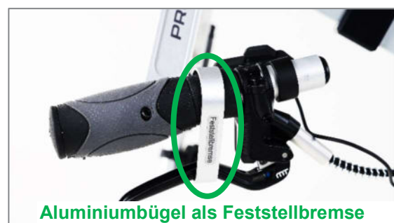
Abbildung 36: Aluminiumbügel als Feststellbremse
