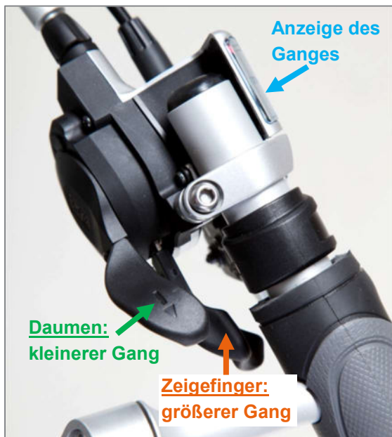
Abbildung 25: Schalten über Daumen-Zeigefinger-Schaltarmatur bei Shimano Alfine Nabenschaltung
