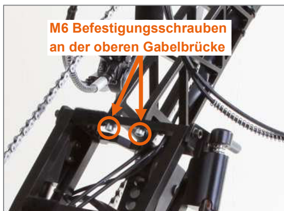
Abbildung 12: M6 Befestigungsschrauben an der oberen Gabelbrücke
