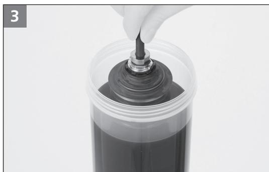
Die inneren Komponenten für ca. 90 Sekunden eingetaucht lassen.
