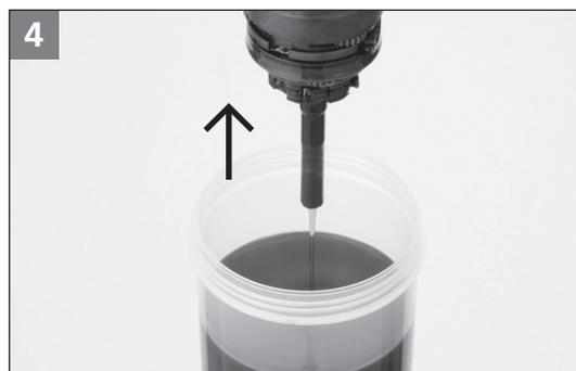
Die inneren Komponenten aus dem Öl entnehmen.
