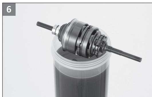
Nach abgeschlossener Schmierung in der üblichen Weise remontieren.
