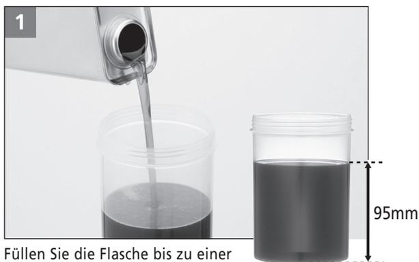
Füllen Sie die Flasche bis zu einer Höhe von 95 mm mit WB-Öl.
