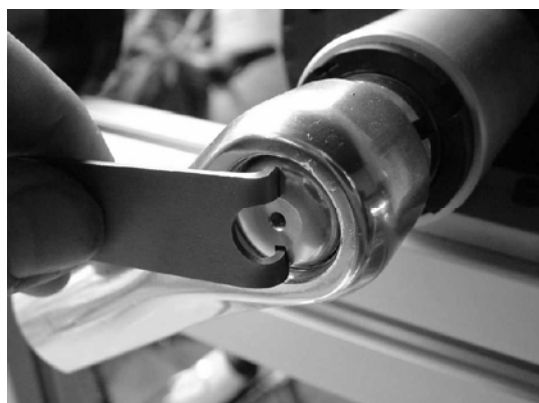
Abb. 6: Schaltknopf mit Spezialschlüssel halten und mit 1.5mm Bit Konterschraube festziehen
