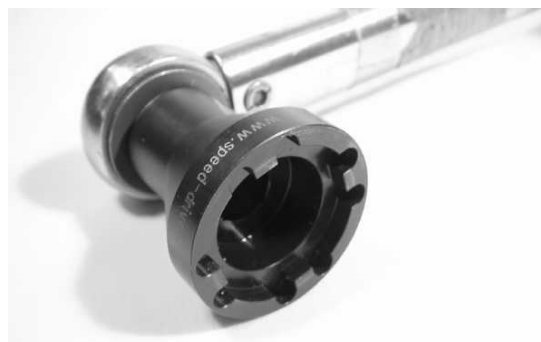
Abb. 5: Steckschlüssel mit Drehmomentschlüssel kombinieren für einfaches und sicheres Festziehen.
