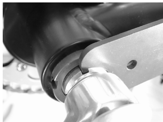
Abb. 8: Spiel nachstellen: Keine Vorspannung, nur allfälliges Spiel aufheben!!
