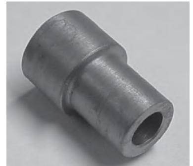
Röhrchen zum Abdrücken der Kurbel mit Standard-Kurbelabdrücker
