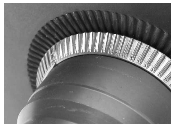
Abb. 4: Stahlkonus für Aluminium-Tretlager
