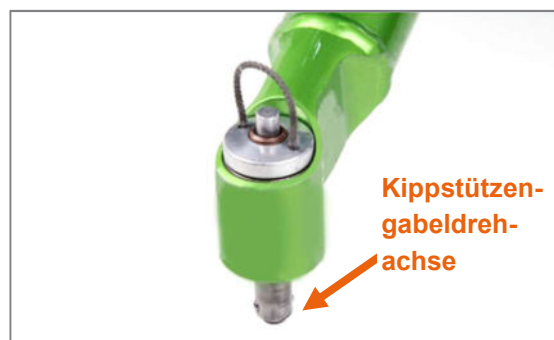
Abbildung 68: Kippstützengabel mit Steckachse, Gabel abgenommen
