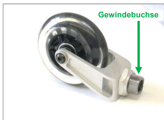
Abbildung 56: Kippstützengabel abgenommen (Kippstützengabel mit Steckachse)
