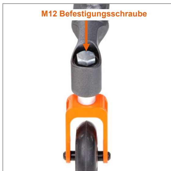
Abbildung 66: Kappe abgenommen und M12 Befestigungsschraube sichtbar
