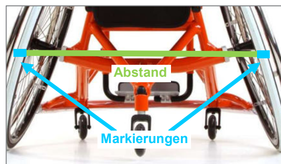
Abbildung 34: Abstand zwischen den Markierungen der Reifen (auf Achshöhe), hinten
