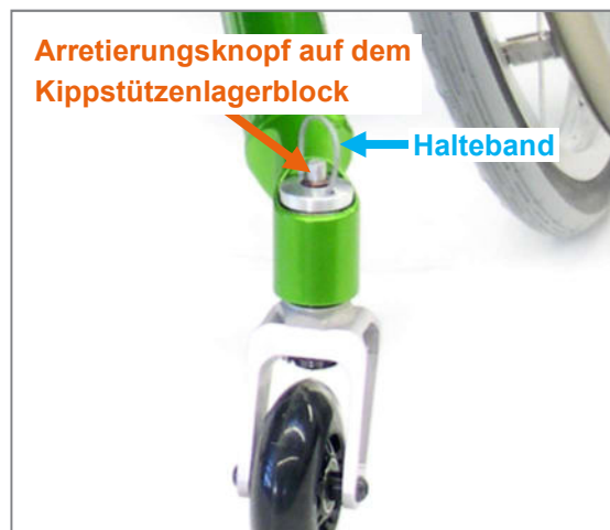
Abbildung 67: Kippstützengabel mit Steckachse
