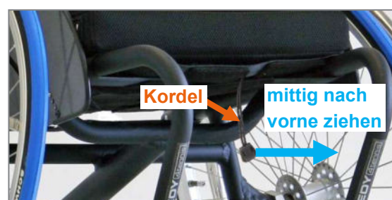
Abbildung 7: Kordel für die Betätigung der Rastbolzen und damit zur Verstellung des Rückenlehnenwinkels
