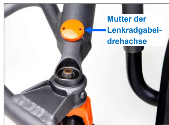
Abbildung 47: Mutter der Lenkradgabeldrehachse vollständig entfernt
