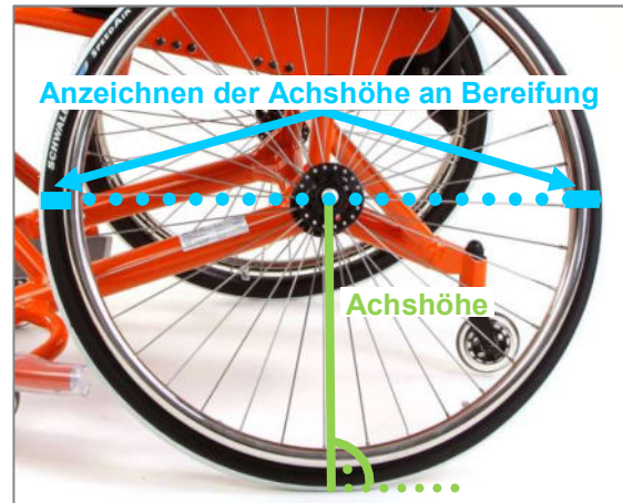
Abbildung 33: Anzeichnen der Achshöhe vorne und hinten auf beiden Reifen
