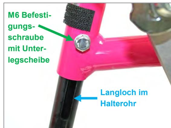
Abbildung 119: M6 Befestigungsschraube mit Unterlegscheibe und Langloch im Fußstützen-Halterohr zur Einstellung der Unterschenkelänge
