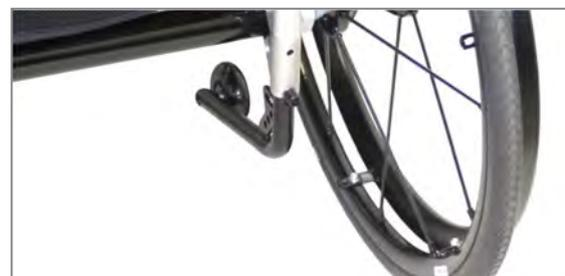
Abbildung 139: Passivstellung der Kippstütze (Ansicht von hinten)
