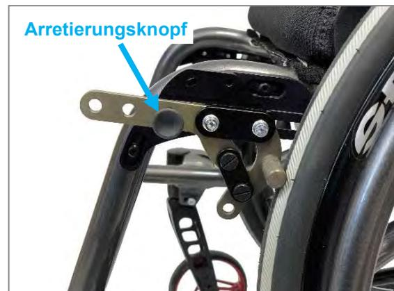
Abbildung 175: Kniehebelbremse mit Arretierung
