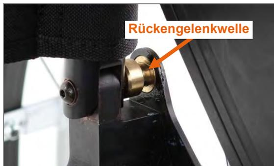
Abbildung 47: Rückgelenkwelle
