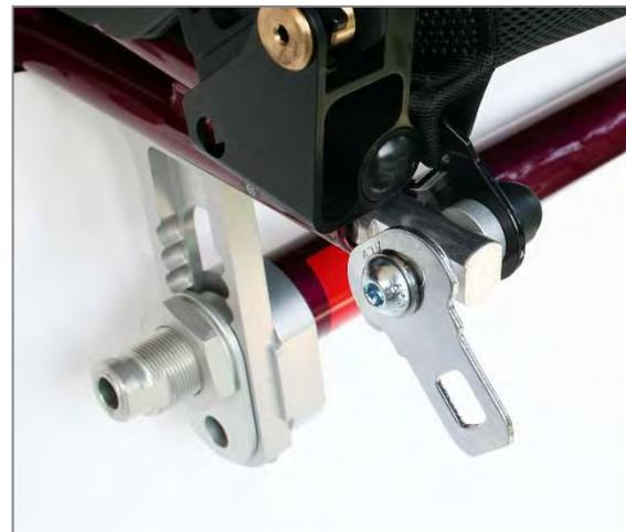
Abbildung 205: Kraftknotenbindung am hinteren Rahmen mit Schlosszungen für Retraktor hinten und Beckengurt (Ansicht von der schräg hinten)
