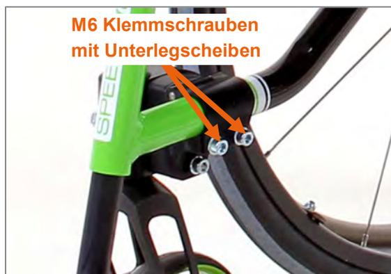
Abbildung 110: M6 Klemmschrauben beim geklemmten Lenkradlagerblock
