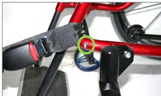
Abbildung 209: Symbol für vordere Befestigung und Umschlaufung des Rollstuhls vorne (Beispiel SPEEDY 4you Ergo)
