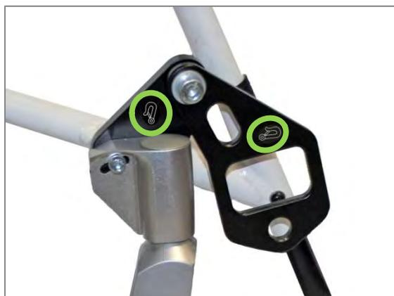
Abbildung 208: Lenkradlagerblockzwischenplatte mit Gurtöse für Retraktor vorne
