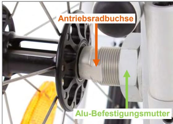
Abbildung 81: Antriebsradbuchse und Alu-Befestigungsmutter (Ansicht von hinten)
