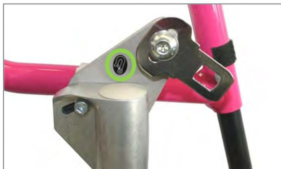
Abbildung 207: Lenkradlagerblockzwischenplatte mit Schlosszunge für Retraktor vorne
