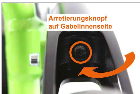
Abbildung 105: Lenkradgabel mit Steckachse und Arretierungsknopf
