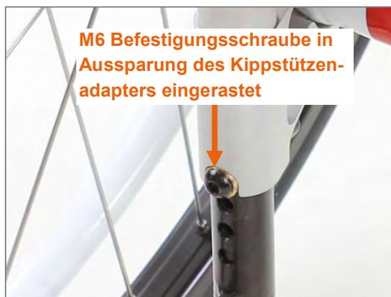
Abbildung 141: Kippstütze ordnungsgemäß eingerastet
