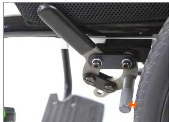
Abbildung 159: Abstand zwischen Bremsbolzen und Bereifung ca. 3 bis maximal 4 mm bei geöffneter Bremse
