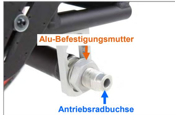
Abbildung 2: Alu-Befestigungsmutter und Antriebsradbuchse (Ansicht von Produktaußenseite)
