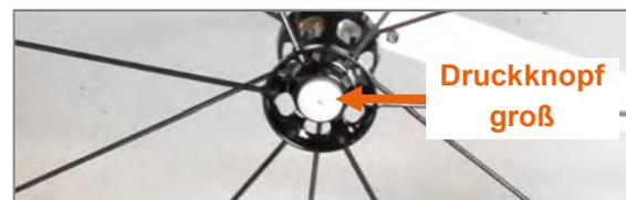
Abbildung 76: Steckachse mit Bedienungsunterstützung, Druckknopf groß
