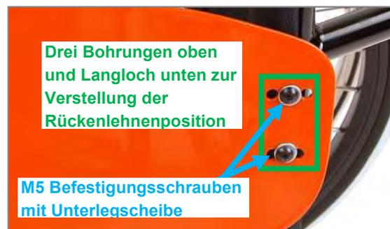
Abbildung 17: Verstellung der Rückenlehnenposition über Bohrungen im Seitenteil
