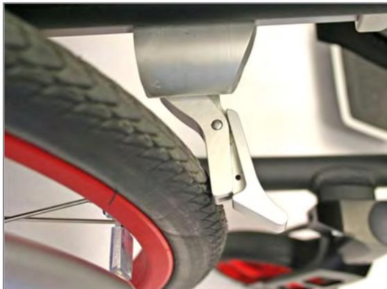
Abbildung 168: Bremsenelement an der Bereifung anliegend
