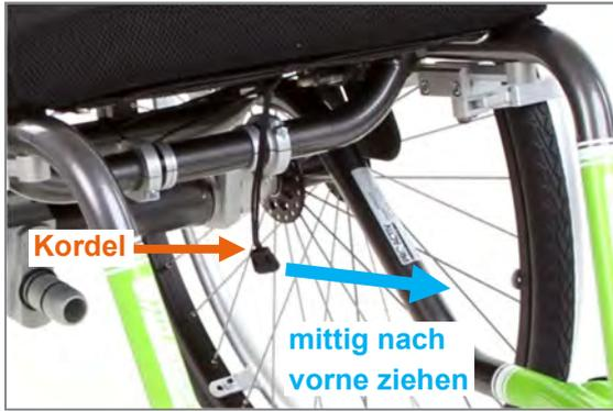
Abbildung 57: Kordel für die Betätigung der Rastbolzen
