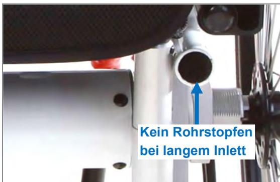
Abbildung 13: Kein Rohrstopfen am Rahmenende bedeutet "langes Inlett" (Ansicht von hinten)
