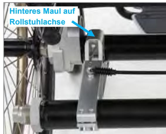
Abbildung 92: Radstandsverlängerung angebracht (Ansicht von hinten)
