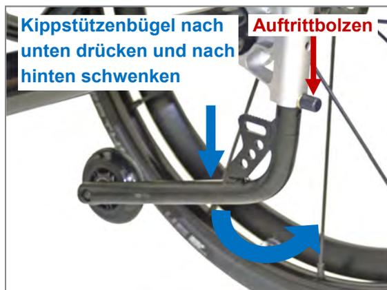
Abbildung 140: Kippstütze in Betriebsstellung bringen (Ansicht von hinten)
