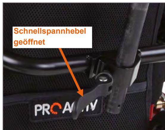
Abbildung 194: Geöffneter Schnellspannhebel
