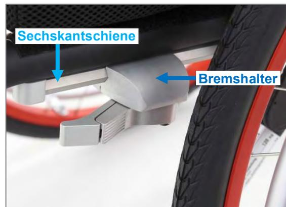
Abbildung 166: Sechskantschiene und Bremshalter
