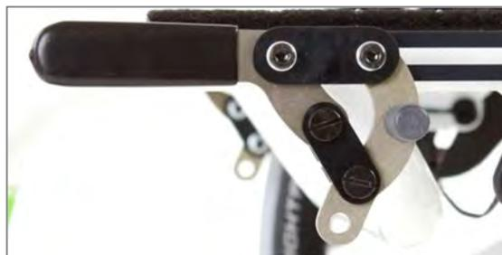
Abbildung 151: Kniehebelbremssystem mit Bremshebel Standard
