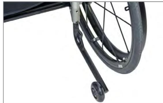
Abbildung 138: Betriebsstellung der Kippstütze (Ansicht von hinten)
