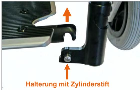
Abbildung 116: Fußbrettauflage aus Halterung gehoben (Produktansicht von vorne)
