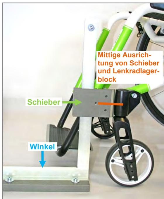
Abbildung 106: Überprüfung der Einstellung der Lenkradgabeldehachsen
