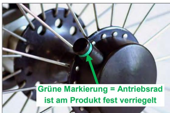
Abbildung 77: Tetra-Clip mit verriegelter Steckachse
