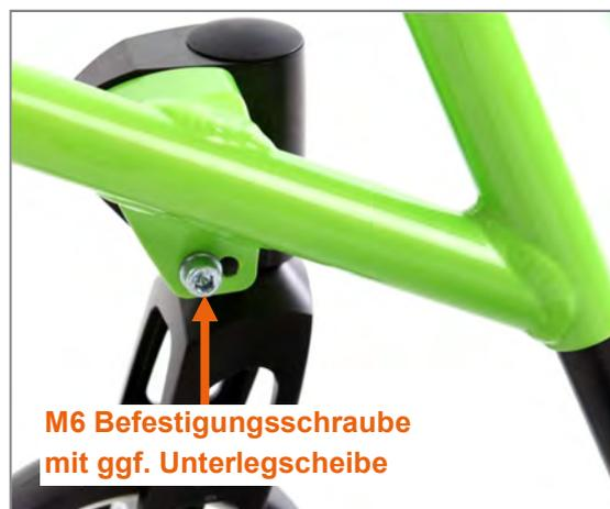
Abbildung 108: M6 Befestigungsschraube an der Rahmeninnenseite, Unterlegscheibe bei G-Form-Rahmen vorhanden, bei V-Form-Rahmen nicht
