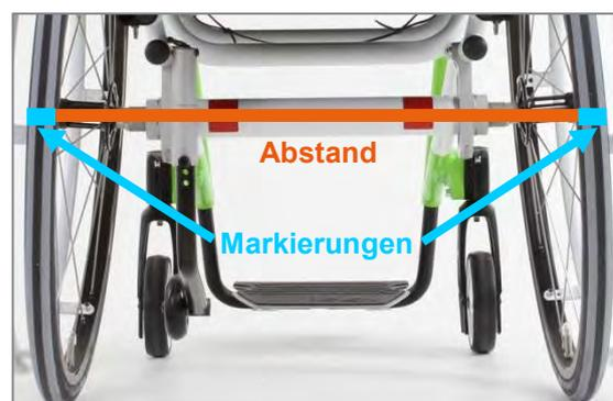
Abbildung 80: Abstand zwischen den Markierungen der Reifen (auf Achshöhe), hinten
