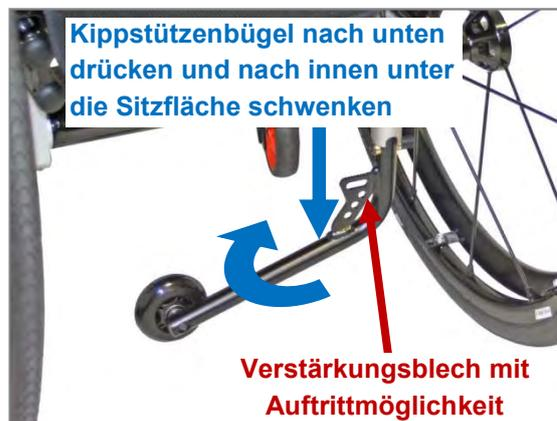
Abbildung 142: Kippstütze in Passivstellung bringen (Ansicht von hinten)
