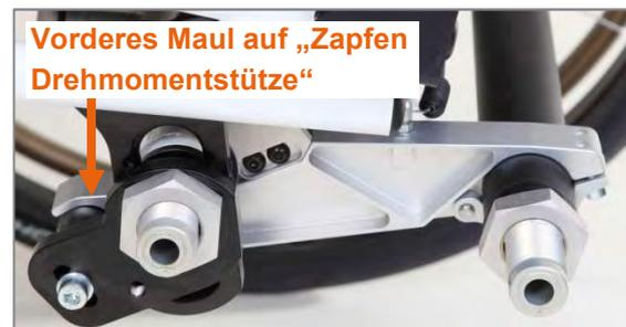
Abbildung 91: Radstandsverlängerung angebracht (Ansicht von der Produktaußenseite ohne Antriebsrad)
