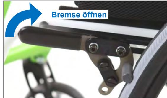
Abbildung 153: Bremse geschlossen; Öffnen erfolgt durch nach hinten-oben Ziehen des Bremshebels
