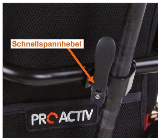
Abbildung 193: Geschlossener Schnellspannhebel
