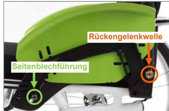
Abbildung 49: Kleiderschutz am Produkt angebracht (Ansicht ohne Antriebsrad)
