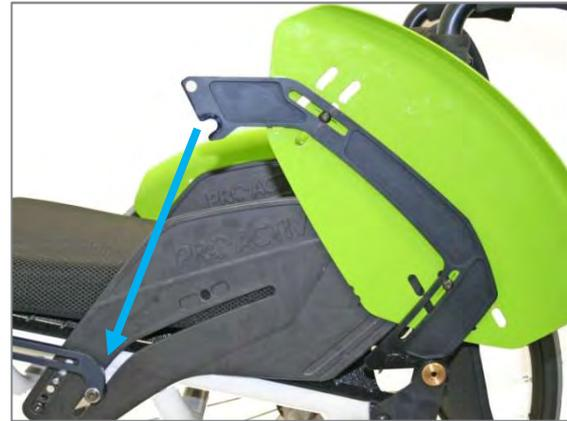
Abbildung 59: Aufnahmebügel auf Rückgelenkwelle aufgesteckt (Ansicht ohne Antriebsrad)
