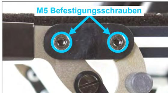
Abbildung 154: M5 Befestigungsschrauben an der Bremshalteschiene
