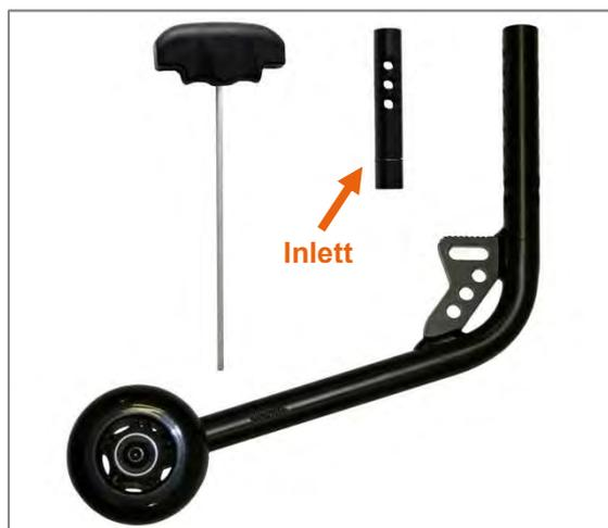
Abbildung 150: Inlett des Kippstützenbügels und Schraubendreher
