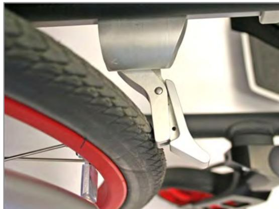
Abbildung 172: Bremsenelement an der Bereifung anliegend
