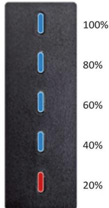
Die Batteriedauer und der entsprechende Wert der Anzeige variiert je nach Verwendungsart des Triride, nach Gewicht des Benutzers und nach Art der Strecke.
