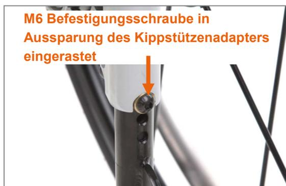
Abbildung 133: Kippstütze ordnungsgemäß eingerastet
