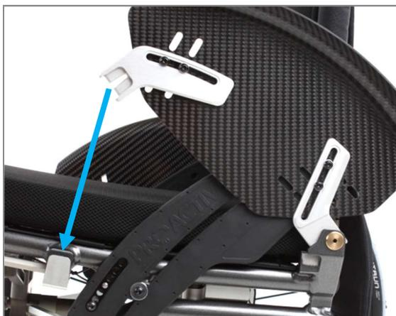
Abbildung 55: Hintere Seitenteilaufnahme auf Rückengelenkwelle aufgesteckt (Ansicht ohne Antriebsrad)
