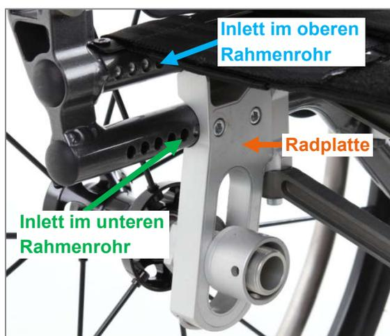
Abbildung 14: Inletts und Radplatte (Ansicht von Produktinnenseite)
