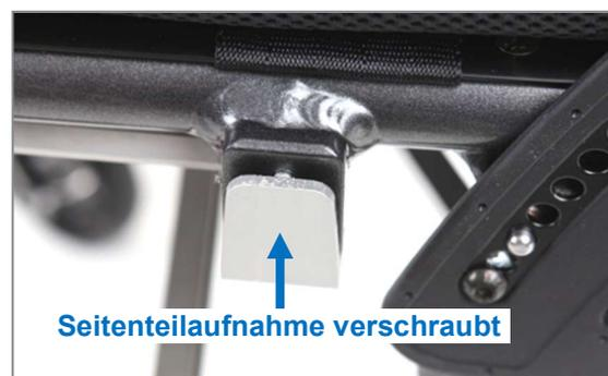
Abbildung 53: „Seitenteilaufnahme verschraubt“ (Ansicht ohne Kleiderschutz)
