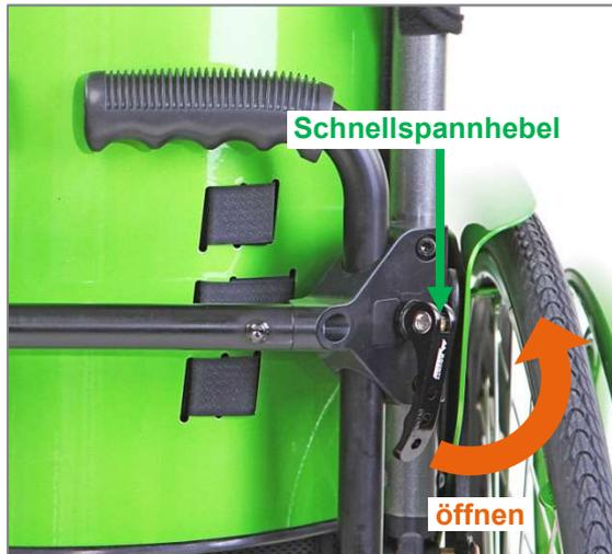
Abbildung 168: Geschlossener Schnellspannhebel
