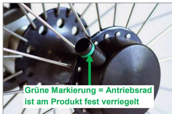
Abbildung 70: Tetra-Clip mit verriegelter Steckachse
