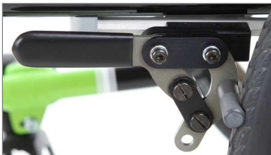
Abbildung 143: Kniehebelbremssystem mit Bremshebel Standard
