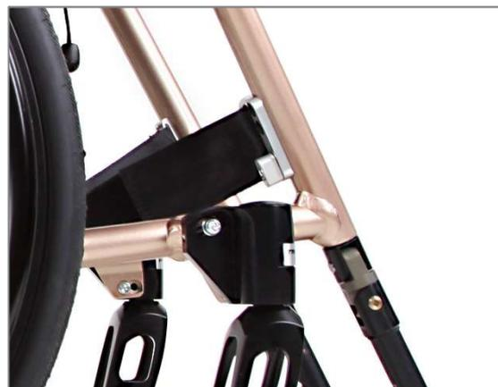
Abbildung 104: Schieber in Standardposition, Fußstütze verriegelt
