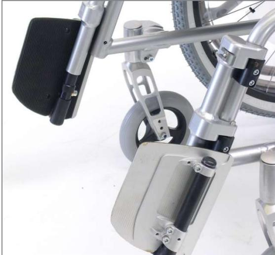
Abbildung 125: Beide Fußstützenteile hochgeklappt und nach außen gedreht
