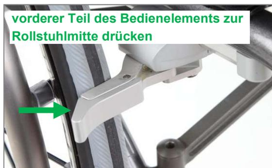
Abbildung 153: Integralbremse geschlossen; Öffnen erfolgt durch Drücken des Bedienelements zur Rollstuhlmitte
