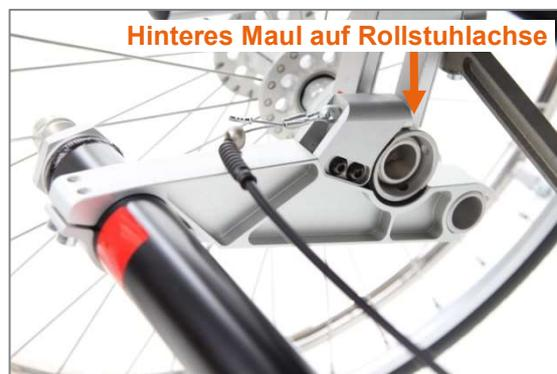
Abbildung 85: Radstandsverlängerung angebracht (Ansicht von Produktinnenseite)
