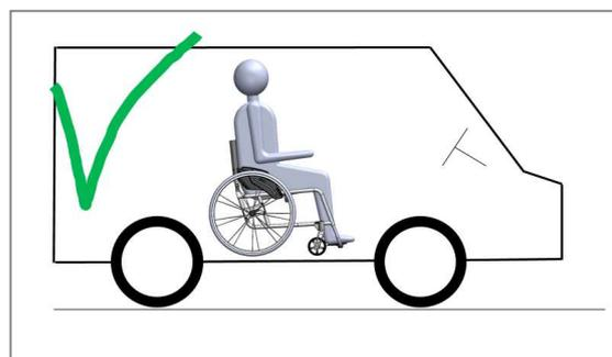
Abbildung 183: Richtige Ausrichtung des Rollstuhls im Fahrzeug
