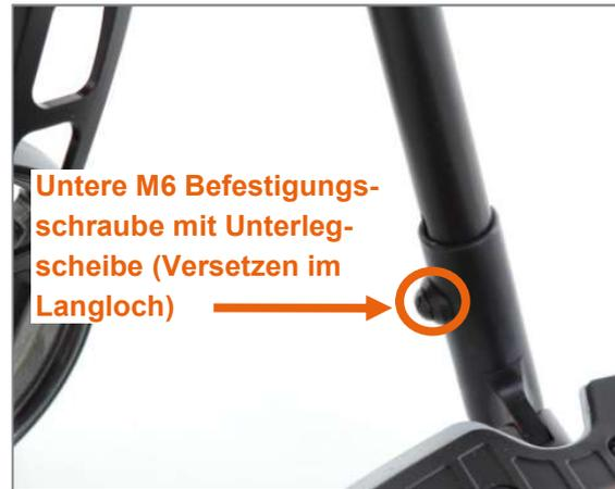
Abbildung 109: Untere M6 Befestigungsschraube kann im Langloch positioniert werden
