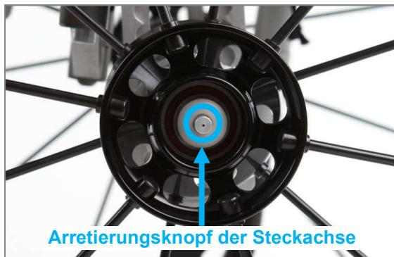
Abbildung 67: Arretierungsknopf der Steckachse in der Mitte der Radachse
