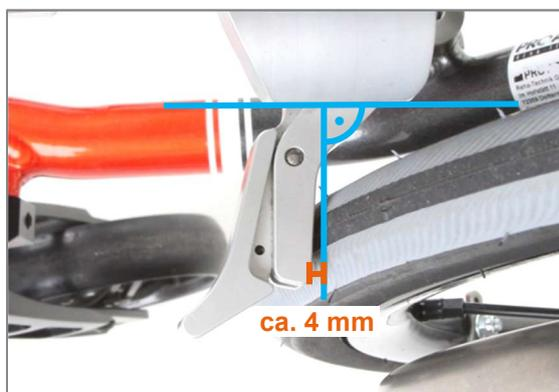
Abbildung 157: Bremsenelement nach richtiger Positionierung der Integralbremse
