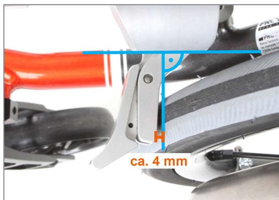
Abbildung 161: Bremsselement nach richtiger Positionierung der Integralbremse
