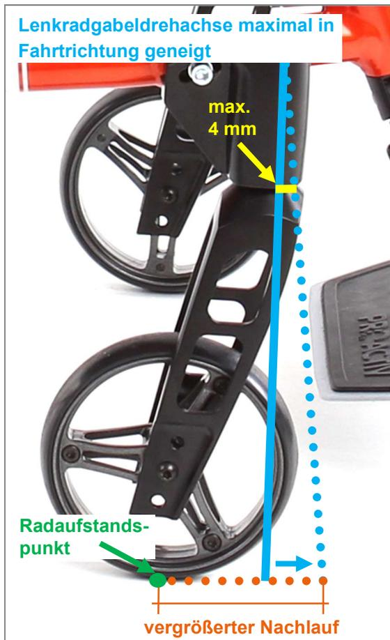
Abbildung 95: Nachlaufvergrößerung über Neigung der Lenkradgabeldrehachse
