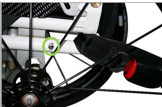
Abbildung 181: Symbol für hintere Befestigung und Umschlaufung des Rollstuhls hinten
