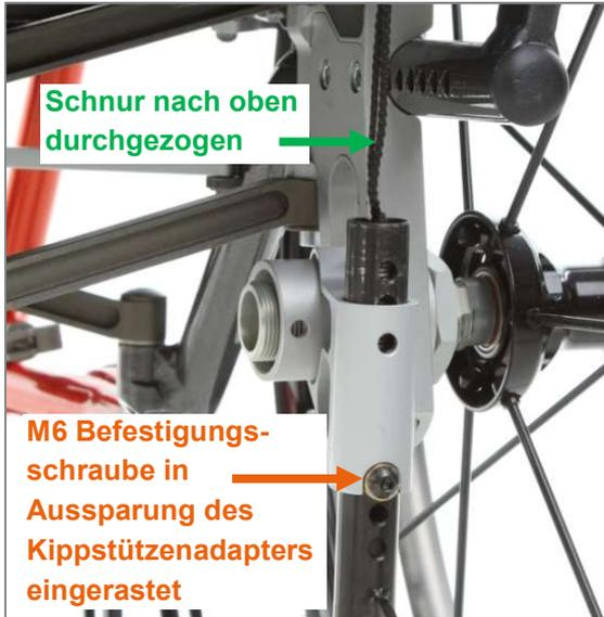
Abbildung 136: Kippstützenbügel in Kippstützenadapter eingesteckt
