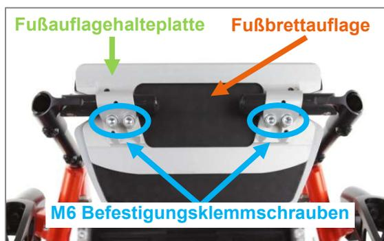
Abbildung 103: Fußstütze von unten
