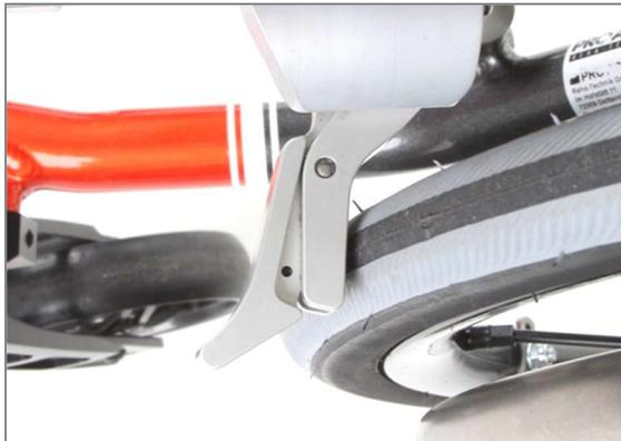
Abbildung 156: Bremsenelement an der Bereifung anliegend
