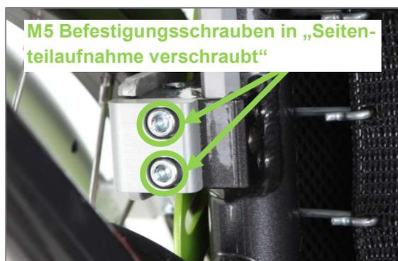
Abbildung 64: „Seitenteilaufnahme verschraubt“ mit Langlöchern und M5 Befestigungsschrauben am Grundkörper der Seitenteilaufnahme (Ansicht von unten)
