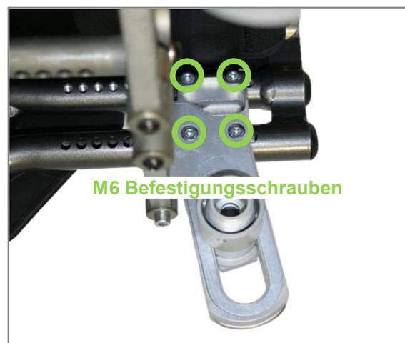
Abbildung 20: M6 Befestigungsschrauben der Radplatte (Ansicht von Produktinnenseite)
