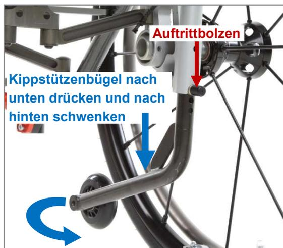
Abbildung 132: Kippstütze in Betriebsstellung bringen (Ansicht von hinten)
