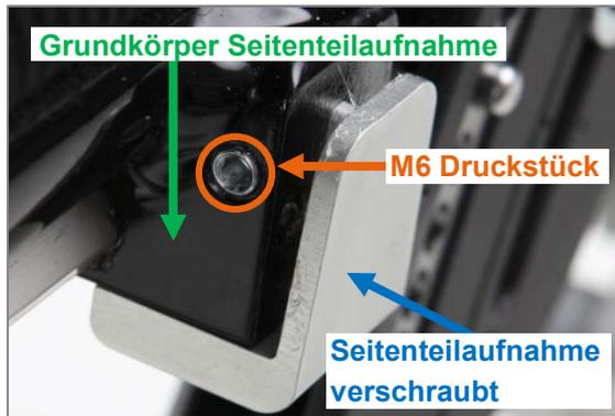
Abbildung 59: M6 Druckstück in "Grundkörper Seitenteilaufnahme" geschraubt
