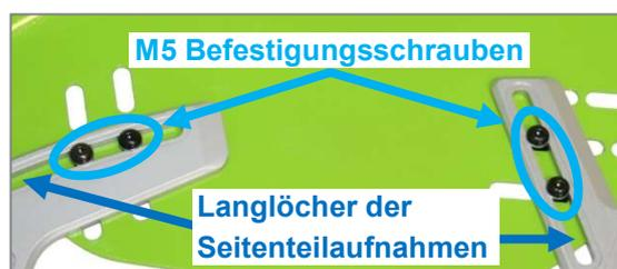
Abbildung 57: M5 Befestigungsschrauben und Langlöcher der Seitenteilaufnahmen
