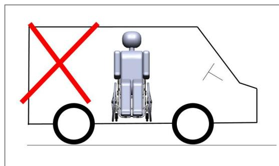
Abbildung 182: Falsche Ausrichtung des Rollstuhls im Fahrzeug
