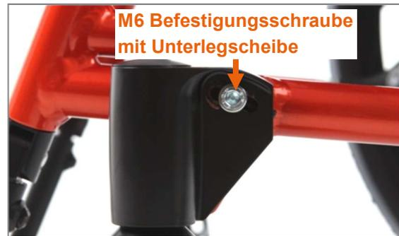
Abbildung 102: M6 Befestigungsschraube an der Rahmenaußenseite
