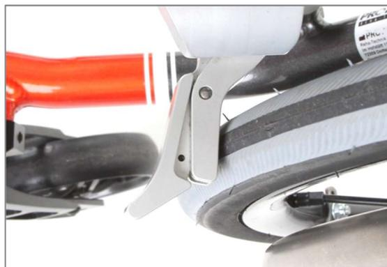
Abbildung 160: Bremsselement an der Bereifung anliegend
