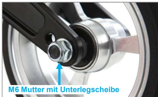
Abbildung 91: M6 Mutter der Lenkradachse (Ansicht von Produktinnenseite)
