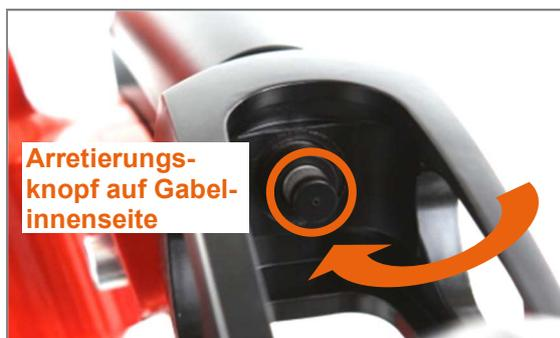
Abbildung 98: Lenkradgabel mit Steckachse und Arretierungsknopf
