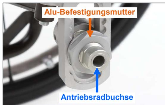
Abbildung 7: Alu-Befestigungsmutter und Antriebsradbuchse (Ansicht von Produktaußenseite)
