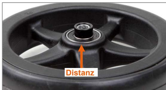
Abbildung 93: Distanz am Lenkrad
