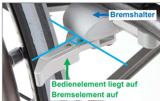
Abbildung 152: Integralbremse geschlossen; Bremselement senkrecht zum Bremshalter
