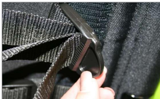
Abbildung 39: Schritt 5: Zurückführen des Gurtes durch die Spannöse um die geforderte "doppelte Durchführung" zu erhalten
