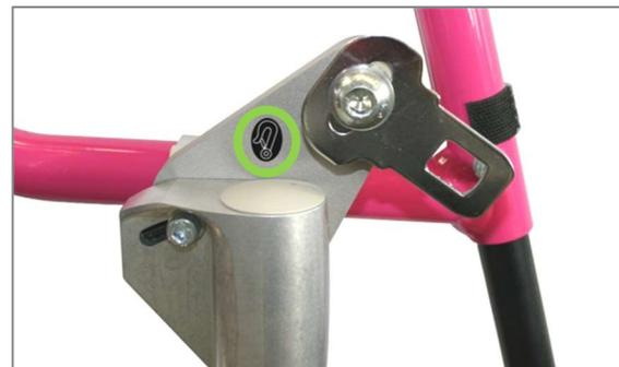
Abbildung 178: Lenradlagerblockzwischenplatte mit Schlosszunge für Retraktor vorne
