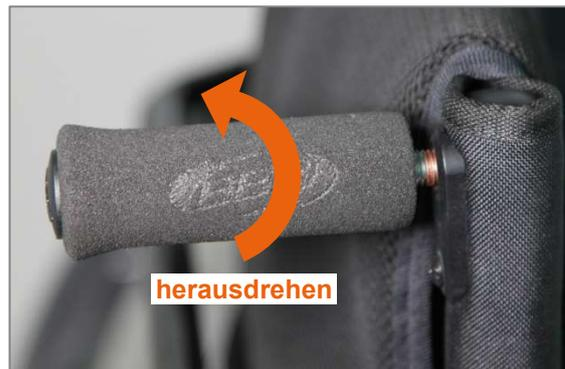
Abbildung 165: Schiebegriff horizontal aus dem Rückenrohr herausdrehen
