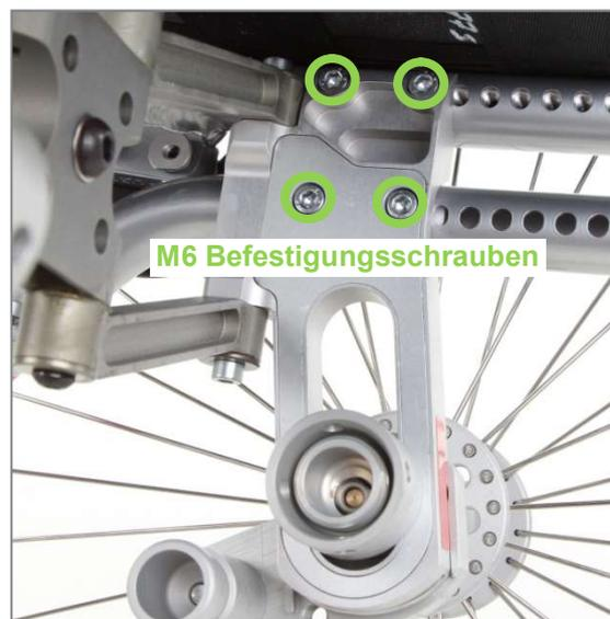
Abbildung 15: M6 Befestigungsschrauben der Radplatte (Ansicht von Produktinnenseite)
