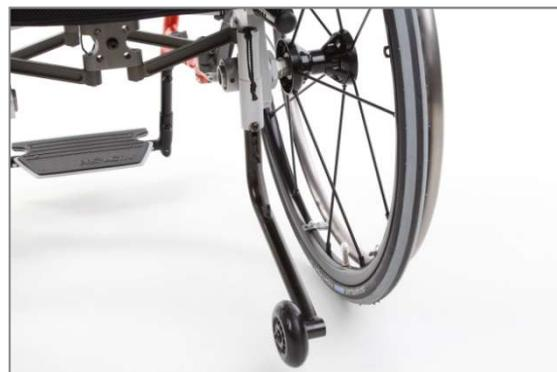
Abbildung 130: Betriebsstellung der Kippstütze (Ansicht von hinten)
