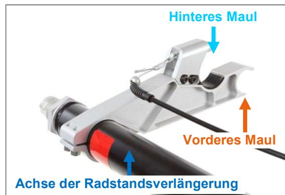
Abbildung 80: Bezeichnungsübersicht bei Radstandsverlängerung
