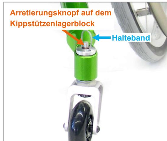
Abbildung 67: Kippstützengabel mit Steckachse
