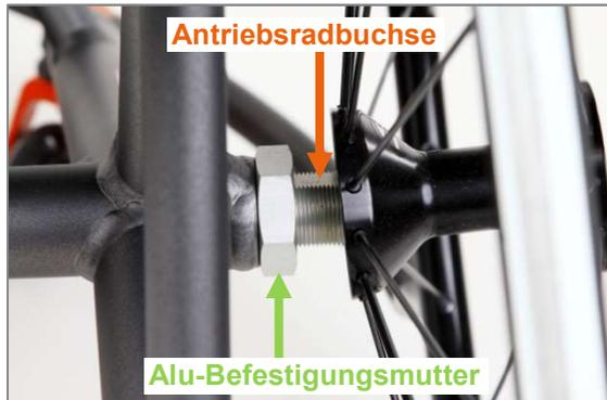
Abbildung 35: Antriebsradbuchse und Alu-Befestigungsmutter (Ansicht von hinten)
