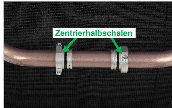
Abbildung 64: Zentrierhalbschalen am vorderen Rahmenquerrohr
