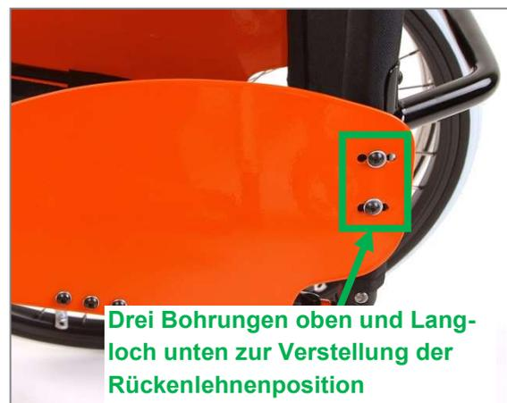
Abbildung 3. Verstellung der Rückenlehnenposition über Bohrungen im Seitenblech
