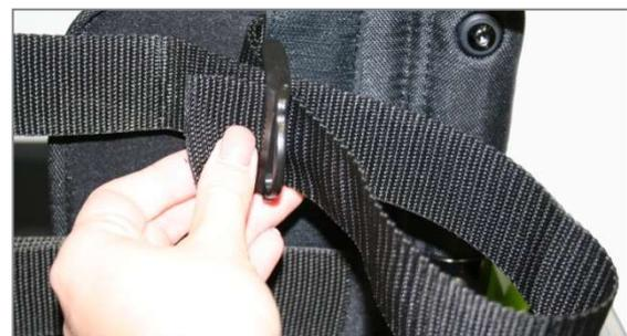
Abbildung 16: Schritt 2: Einfädeln des Gurtes
