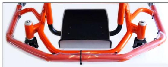
Abbildung 71: Offence Bügel mit Trapezform
