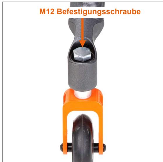
Abbildung 66: Kappe abgenommen und M12 Befestigungsschraube sichtbar
