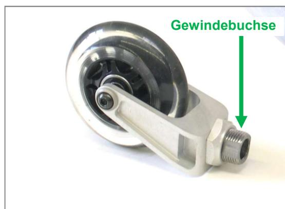
Abbildung 56: Kippstützengabel abgenommen (Kippstützengabel mit Steckachse)
