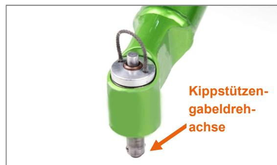
Abbildung 68: Kippstützengabel mit Steckachse, Gabel abgenommen
