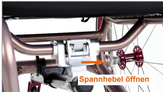
Abbildung 61: Spannhebel nach vorne ziehen zum Öffnen
