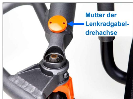
Abbildung 47: Mutter der Lenkradgabeldrehachse vollständig entfernt
