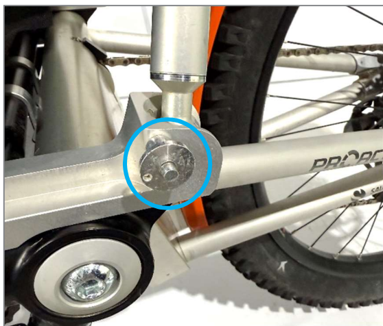
Abbildung 51: Quick-Pin der Rückenlehne am Gelenkschlitten (links)
