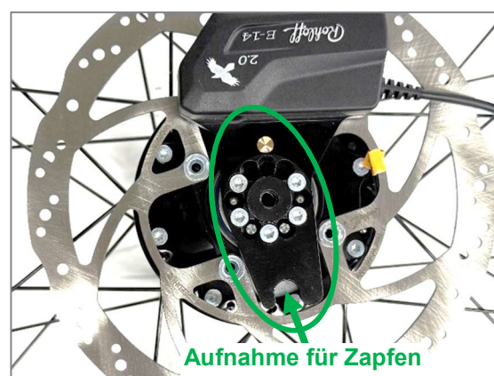
Abbildung 68: Drehmomentaufnahme mit Rohloff Schaltung am Antriebsrad (Ansicht Radinnenseite)
