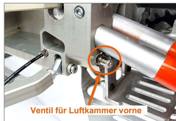
Abbildung 39: Ventil für Luftkammer vorne
