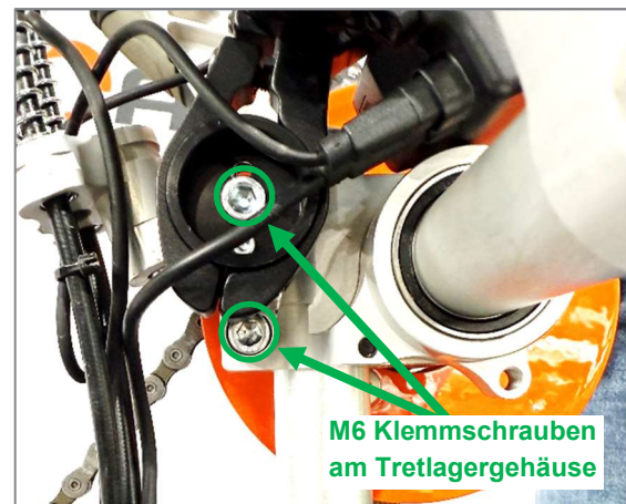
Abbildung 7: M6 Klemmschrauben am Tretlagergehäuse
