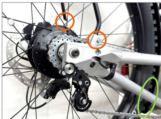
Abbildung 82: Position der M5 Zylinderschrauben der Schutzblechbefestigung
