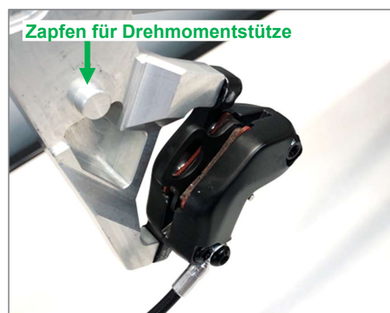
Abbildung 67: Ausfallende links bei Rohloff Nabe
