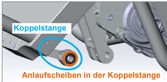
Abbildung 87: Koppelstange mit Anlaufscheiben aus der Umlenkung der Schwinge genommen
