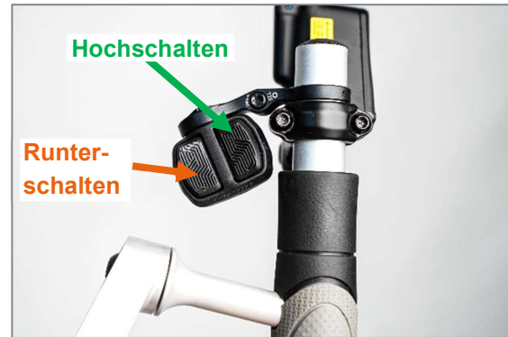
Abbildung 13: Taster zum Hoch- und Runterschalten der SRAM Schaltung
