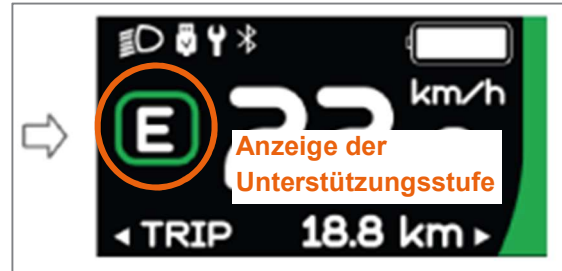
Abbildung 24: Anzeige mit Unterstützungsstufe „E“ für Eco (niedrigste Unterstützungsstufe)
