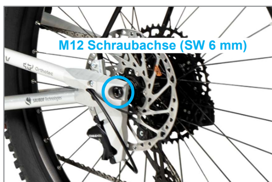
Abbildung 69: Schraubachse des Antriebsrads
