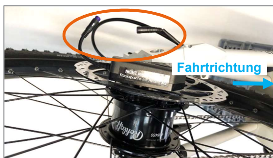
Abbildung 64: Steckverbindung gelöst (Ansicht von oben)
