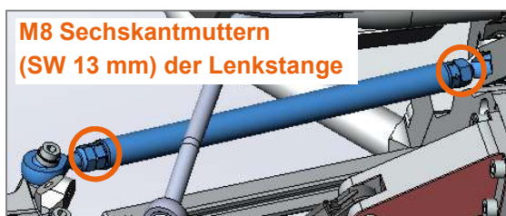
Abbildung 74: M8 Sechskantmutter an den unteren Lenkstangen rechts und links
