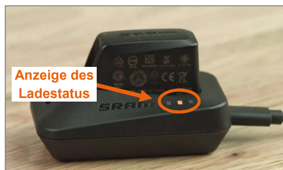
Abbildung 18: Akku im Ladegerät mit Anzeige des Ladestatus
