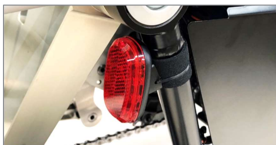
Abbildung 46: Beleuchtung hinten über Antriebssystem
