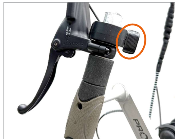
Abbildung 25: Hebel der Anfahrunterstützung
