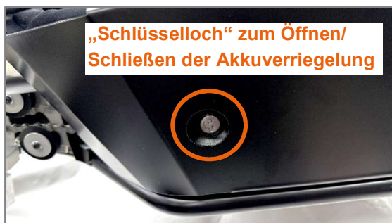
Abbildung 28: Schlüsselloch des Akkus von außen zugänglich durch Öffnung am Seitenblech
