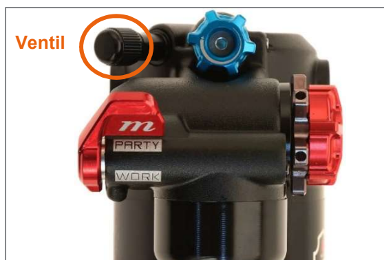
Abbildung 41: Hebelstellung "Open-Modus/Party-Modus" bei Dämpfer Manitou Mara Pro
