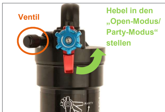
Abbildung 40: Hebelstellung "Open-Modus/Party-Modus" bei Dämpfer Manitou Mara Inline
