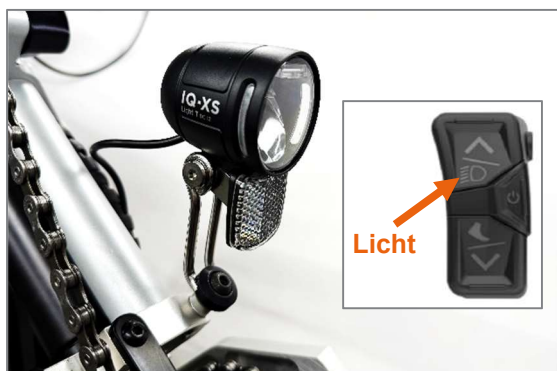
Abbildung 45: Beleuchtung vorne über Antriebssystem
