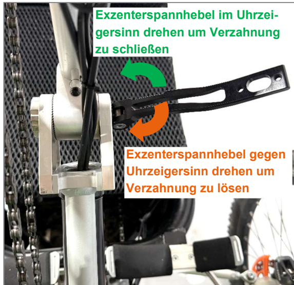
Abbildung 4: Lösen und Schließen der Verzahnung über den Exzentrerspannhebel
