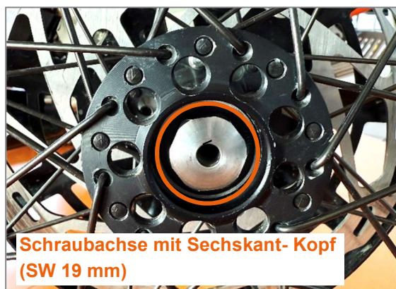
Abbildung 60: Radnabe mit Schraubachse
