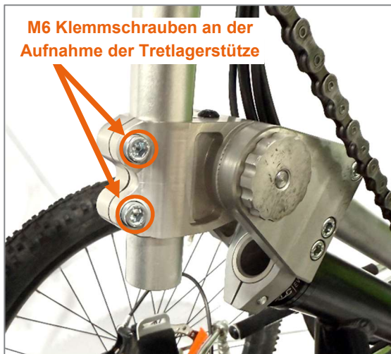
Abbildung 8: M6 Klemmschrauben für die Höhenverstellung der Tretlagerposition
