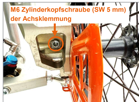
Abbildung 58: Achsklemmung am Radträger (Ansicht rechtes Laufrad)
