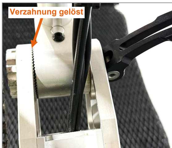
Abbildung 5: Exzentrerspannhebel offen, Verzahnung gelöst
