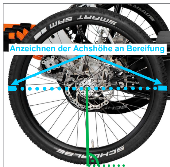
Abbildung 71: Anzeichnen der Achshöhe vorne und hinten auf beiden Bereifungen der Laufräder
