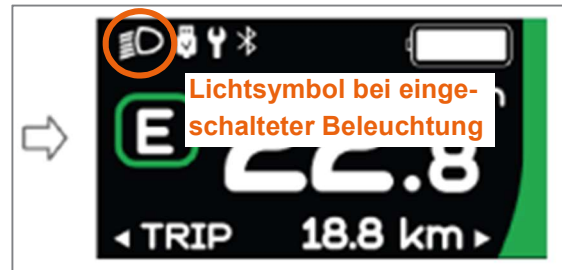
Abbildung 47: Anzeige auf Display bei eingeschalteter Beleuchtung
