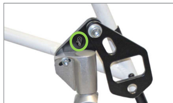
Abbildung 179: Lenkradlagerblockzwischenplatte mit Gurtöse für Retraktor vorne
