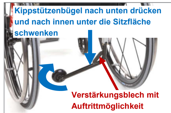
Abbildung 134: Kippstütze in Passivstellung bringen (Ansicht von hinten)
