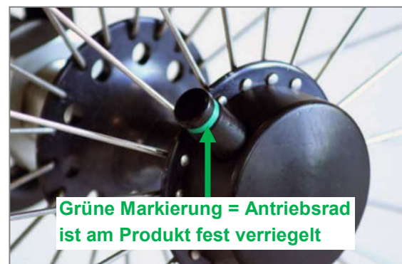
Abbildung 70: Tetra-Clip mit verriegelter Steckachse
