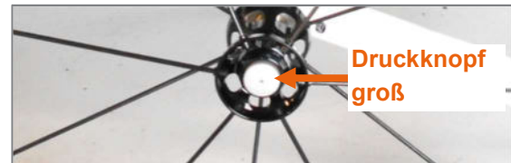
Abbildung 69: Steckachse mit Bedienungsunterstützung, Druckknopf groß
