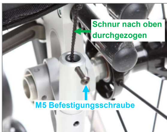
Abbildung 137: Federhütdom auf Kippstützenadapter aufgesetzt, Schnur nach oben durchgezogen und M5 Befestigungsschraube angesetzt
