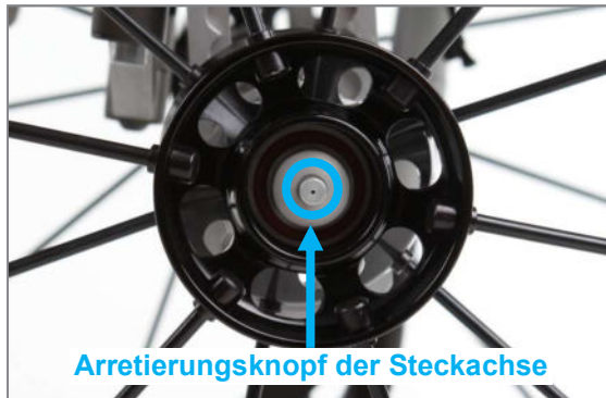
Abbildung 67: Arretierungsknopf der Steckachse in der Mitte der Radachse
