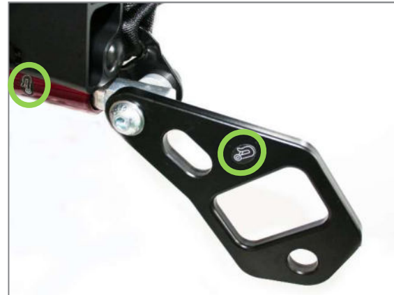
Abbildung 177: Kraftknotenverbindung am hinteren Rahmen mit Gurtöse für Retraktor hinten und Beckengurt
