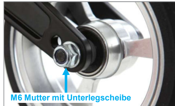
Abbildung 91: M6 Mutter der Lenkradachse (Ansicht von Produktinnenseite)
