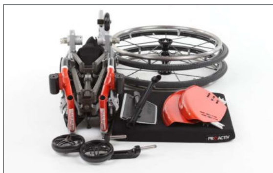
Abbildung 5: Kleinstes Packmaß nach Abnahme der ohne Werkzeug abnehmbaren Baugruppen
