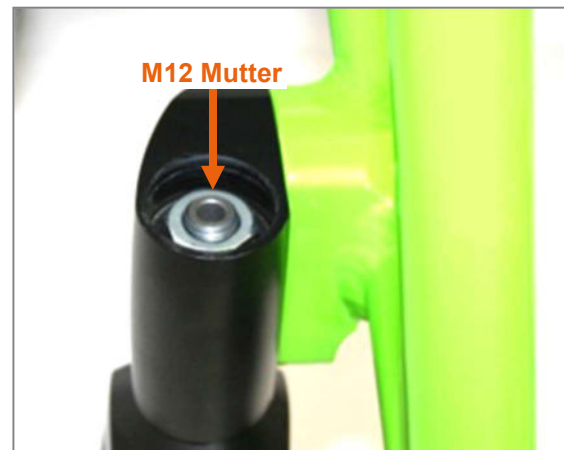
Abbildung 97: Alu-Kappe abgenommen und M12 Mutter sichtbar
