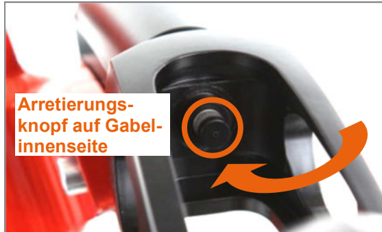
Abbildung 98: Lenkradgabel mit Steckachse und Arretierungsknopf
