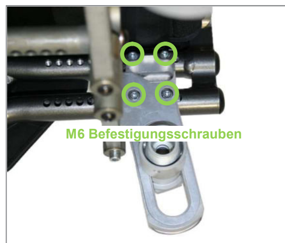
Abbildung 20: M6 Befestigungsschrauben der Radplatte (Ansicht von Produktinnenseite)
