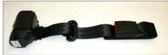
Abbildung 173: Schulterschräggurt automatisch mit Umlenkung und Gurtschloss
