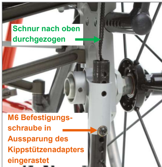
Abbildung 136: Kippstützenbügel in Kippstützenadapter eingesteckt
