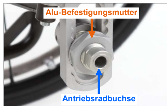
Abbildung 7: Alu-Befestigungsmutter und Antriebsradbuchse (Ansicht von Produktaußenseite)
