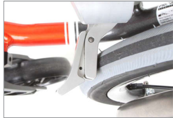
Abbildung 160: Bremselement an der Bereifung anliegend
