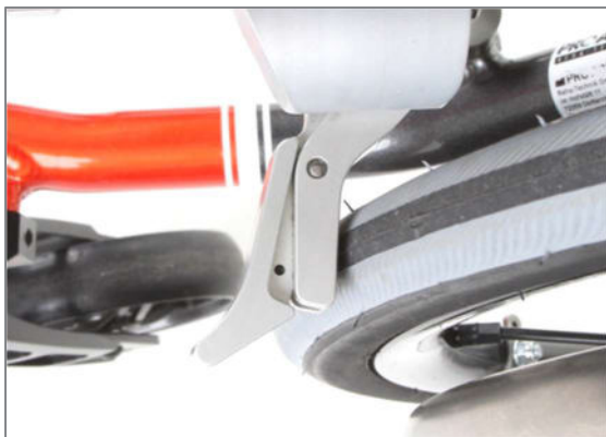
Abbildung 156: Bremsselement an der Bereifung anliegend
