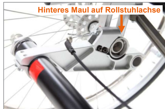
Abbildung 85: Radstandsverlängerung angebracht (Ansicht von Produktinnenseite)
