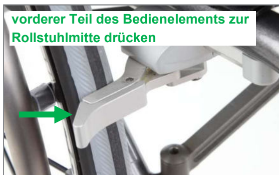
Abbildung 153: Integralbremse geschlossen; Öffnen erfolgt durch Drücken des Bedienelements zur Rollstuhlmitte
