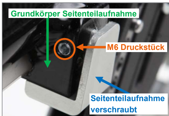
Abbildung 59: M6 Druckstück in "Grundkörper Seitenteilaufnahme" geschraubt
