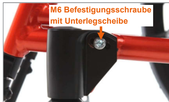
Abbildung 102: M6 Befestigungsschraube an der Rahmenaußenseite
