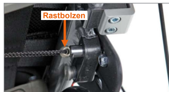
Abbildung 23: Rastbolzen mit Kordel verbunden (Ansicht von der Produktinnenseite)
