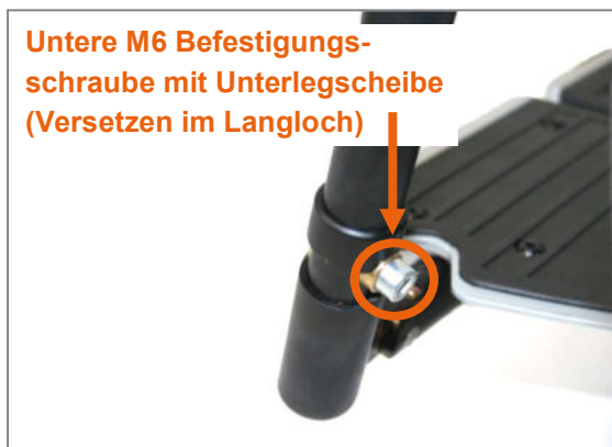
Abbildung 116: Untere M6 Befestigungsschraube (SW 5 mm) kann im Langloch positioniert werden
