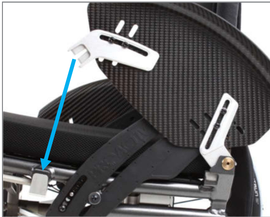
Abbildung 55: Hintere Seitenteilaufnahme auf Rückengelenkwelle aufgesteckt (Ansicht ohne Antriebsrad)
