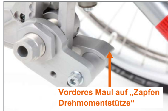
Abbildung 84: Radstandsverlängerung angebracht (Ansicht von der Produktaußenseite ohne Antriebsrad)
