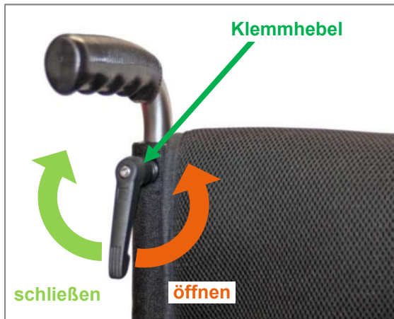
Abbildung 166: Sicherheitsschiebegriff stufenlos höhenverstellbar
