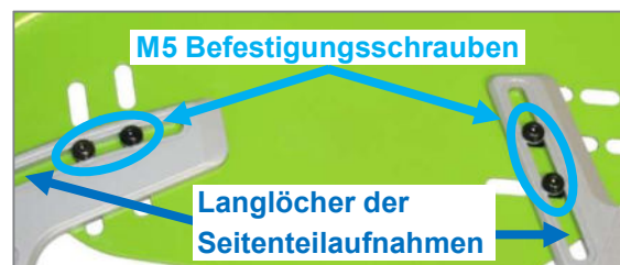
Abbildung 57: M5 Befestigungsschrauben und Langlöcher der Seitenteilaufnahmen
