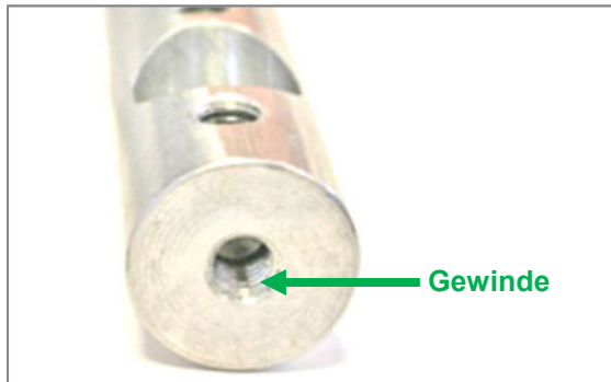
Abbildung 17: Kurzes Inlett mit Gewinde in der Stirnfläche
