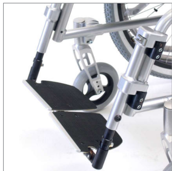
Abbildung 124: Fußstütze Swing away, in Standardposition
