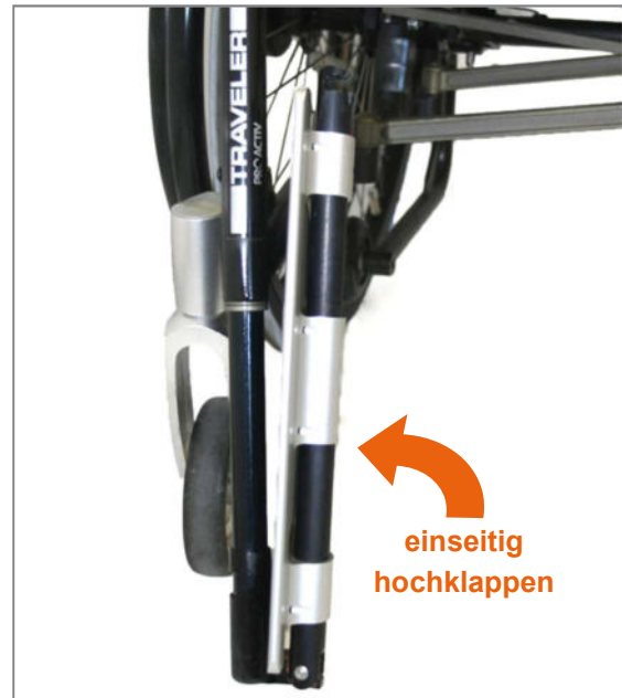
Abbildung 113: Fußstütze einseitig hochgeklappt (Produktansicht von vorne)
