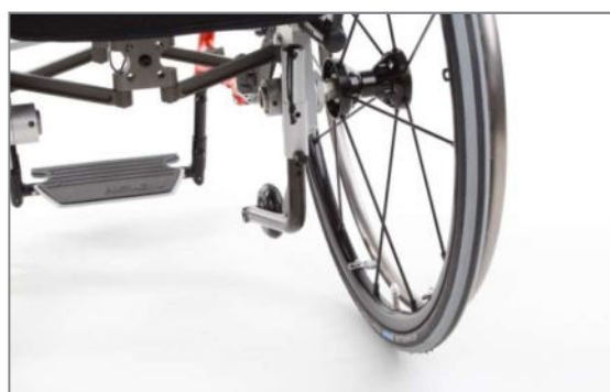
Abbildung 131: Passivstellung der Kippstütze (Ansicht von hinten)
