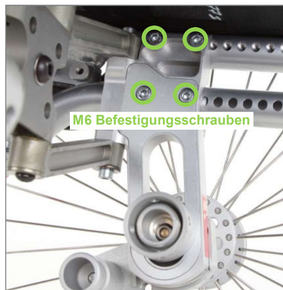
Abbildung 15: M6 Befestigungsschrauben der Radplatte (Ansicht von Produktinnenseite)
