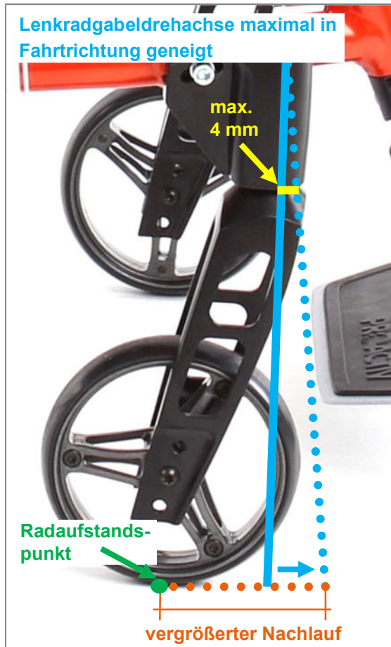
Abbildung 95: Nachlaufvergrößerung über Neigung der Lenkradgabeldrehachse
