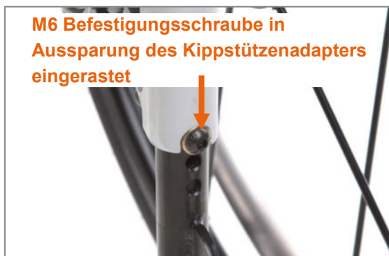
Abbildung 133: Kippstütze ordnungsgemäß eingerastet
