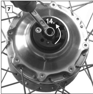
Mit einem Schraubenschlüssel SW8 die Schaltwelle entgegen dem Uhrzeigersinn über die einzelnen Rastungen hinweg bis Endanschlag drehen. Jetzt ist der 14. Gang eingelegt.
