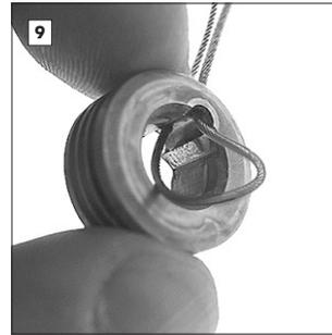
Danach das zweite Seilende durch die obere Bohrung der Seilrolle einfädeln. Auf gleiche Länge beider Seilenden achten.
