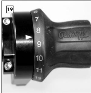
Griffelement mit montierten Zuganschlügen so drehen, dass Markierung am Griffgehäuse mittig zwischen Zahlen 8 und 9 liegt und in dieser Position halten.
