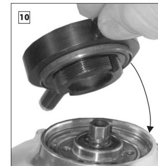
Werkzeug aufsetzen. Der neue Simmerring weist mit der offenen Seite in Richtung Nabe.
