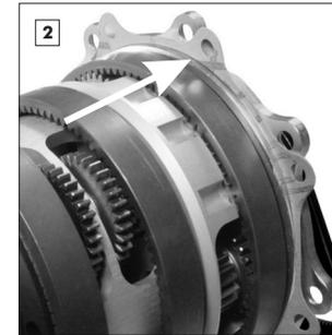
Neue Gehäusedichtung (Pfeil) über den Zentrierbund des Gehäusedeckels führen. Die Dichtung lässt sich besser montieren, wenn sie vor der Montage leicht gefettet wird. Schraubenlöcher von Gehäusedeckel und Gehäusedeckeldichtung in Deckung bringen.
