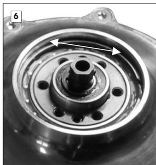
Passfläche zum Einpressen des neuen Simmerrings im Nabengehäuse mit Wattestift oder Lappenzipfel reinigen/entfetten (Bremsenreiniger, Waschbenzin).
