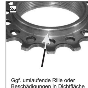
Ggf. umlaufende Rille oder Beschädigungen in Dichtfläche
