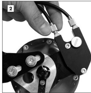
Bei den Versionen mit externer Schaltansteuerung befinden sich die Zugeinsteller an der Seilbox, die sich auf der linken Seite der Rohloff SPEEDHUB 500/14 befindet. Diese ist entweder entlang der Sattelstrebe oder entlang der Kettenstrebe ausgerichtet.
