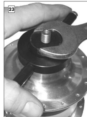
Ritzelabzieher auf Antreiber setzen und ggf. mit Achsmutter oder Schnellspanner sichern. Ring über den Ritzelabzieher auf das Antreibergewinde aufsetzen. Ring in Richtung Nabe bis zum Anschlag aufschrauben ggf. am Ritzelabzieher mit 24er Gabeschlüssel gehalten.
