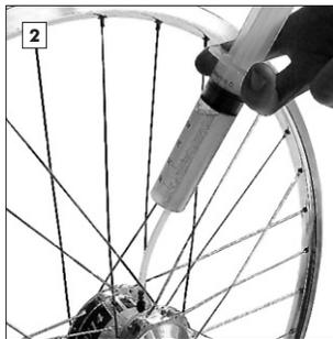
25 ml Spülöl auf Spritze aufziehen. Öleinfüllschlauch einschrauben und das Spülöl einfüllen. Ist das Spülöl vollständig eingefüllt, zum Druckausgleich etwas Luft aus der Nabe in die Spritze aufziehen und danach erst den Schlauch entfernen. Zum Spülen alte Ölablassschraube eindrehen.
