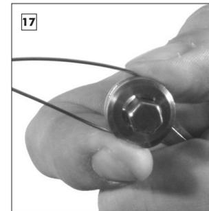
Schaltseile mit Daumen und Zeigefinger in Position halten.
