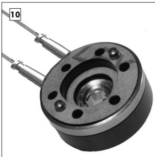
Falls vorhanden, beide Papierdichtungen von der Rückseite des Achsrings her entnehmen. Bei der späteren Montage werden neue Papierdichtungen eingesetzt.
