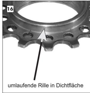
umlaufende Rille in Dichtfläche
