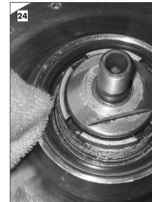
Ring und Ritzelabzieher abnehmen. Ggf. überschüssiges Dichtmittel mit Lappen entfernen.
