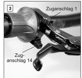
Schaltgriff auf rechtes Lenkerende (Lenkerdurchmesser 22 - 22.3mm) schieben und Griffgehäuse so drehen, dass die Zugansschläge gleichmäßig ober- und unterhalb des Bremsgriffes liegen.
