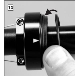
Vor der Montage des neuen Griffgummis den korrekten Sitz des O-Ring auf der Seiltrommel kontrollieren sowie leicht fetten.
