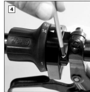
Beide Klemmschrauben (M3x12 - Torx TX20) mit leichter Drehbewegung so anziehen, dass der Spalt auf beiden Seiten der Klemmschelle etwa gleich ist. Dazu das TX20 Werkzeug mit zwei Fingern, am Schaft drehen. Anschließend jede Klemmschraube max. 1/2 Umdrehung anziehen. Der Drehgriff muß nun fest am Lenkerrohr fixiert sein.
