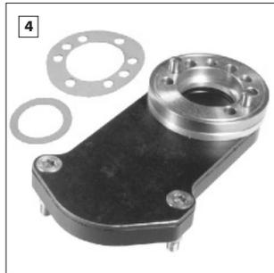
Neue Papierdichtungen einlegen. Die kleine Dichtung wird in die Vertiefung auf der Rückseite des Achsrings eingelegt. Die große Dichtung wird so über die herausragenden Passstiftenden gelegt, dass alle Bohrungen des Achsrings mit den Löchern in der Dichtung übereinstimmen.
