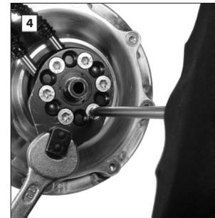
Zum Gegenhalten der Achse bei den Versionen mit langer Drehmomentstütze diese festhalten, bei den OEM und OEM2 Versionen Gabelschlüssel SW10 verwenden (siehe Kapitel "Montage", Abschnitt 4.3).
