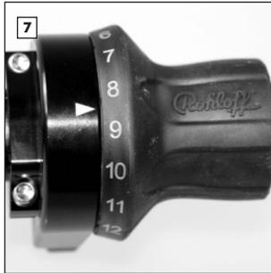
Griffelement so drehen, dass Markierung am Griffgehuse mittig **zwischen Zahlen 8 und 9** liegt und in dieser Position halten. **Schaltzug 14** komplett in das Gehuse einziehen, bis der Nippel sicher in der Seiltrommel fixiert ist.
