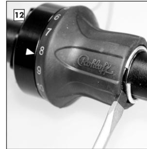
**Wechsel Griffelement:** Zum Austausch des Griffgummis mussen die Schaltzuge nicht ausgebaut werden. Das Griffgummi kann einzeln gewechselt werden. Mit einem schmalen Schlitzschraubendreher den Sicherungsring abhebeln.
