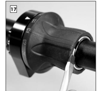
Sicherungsring wieder am Griffgehuse montieren. Prufen, ob sich Griffgummi leicht dreht.
