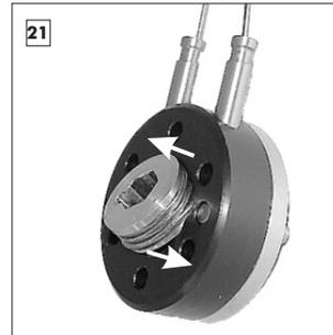
Gleichmäßig an beiden Schaltseilenden ziehend die Seilrolle bis an die Achsringbohrung heranziehen. Schaltseile weiter auf Spannung halten und die Seilrolle mit Daumen von außen und Zeigefinger von innen durch die Achsringbohrung in gerade Position drücken (Pfeile). Die Seilrolle 'springt' dann in die Achsringbohrung.
