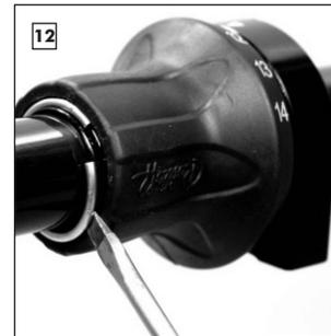
**Wechsel Griffelement:** Zum Austausch des Griffgummis müssen die Schaltzüge nicht ausgebaut werden. Das Griffgummi kann einzeln gewechselt werden. Mit einem schmalen Schlitzschraubendreher den Sicherungsring abhebeln.
