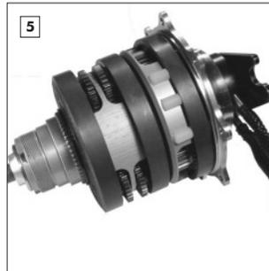
Getriebeblock beiseite legen und Restöl aus Nabengehäuse entfernen.
