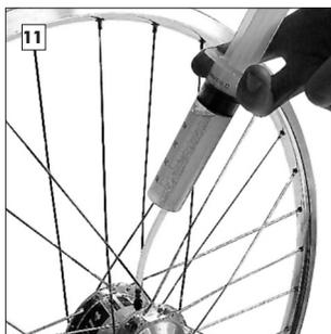
Getriebe mit 25 ml Rohloff *SPEEDHUB OIL* befüllen (siehe Kapitel Ölwechsel) und Ölablassschraube wieder einsetzen (Inbus SW3, Anzugsmoment: 0,5 Nm).
