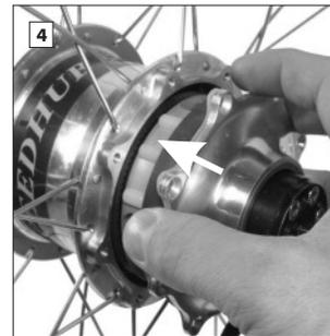
Getriebeblock am Gehäusedeckelrand greifen und bis Anschlag in das Nabengehäuse einschieben.
