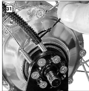
Damit sich die Faltenbälge befestigen lassen, die Schaltseile durch Ziehen an den Bajonetten auf gleiche Länge bringen.
