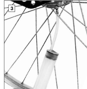
Ölablassschraube herausdrehen (Inbus SW3), Öleinfüllschlauch mit Spritze einschrauben. Ölablass nach unten stellen und Laufrad ca. 15 Minuten in dieser Position stehen lassen, damit sich das Öl sammelt. Öl langsam komplett absaugen. Abgesaugtes Öl in die leere Reinigungsölflasche einfüllen.
