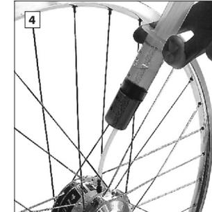
25 ml SPEEDHUB OIL auf Spritze aufziehen, Öleinfüllschlauch einschrauben und Öl in das Getriebe drücken. Zum Druckausgleich ca. 25 ml Luft aus der Nabe in die Spritze aufziehen. Öleinfüllschlauch
