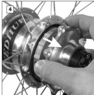
Getriebeblock aus dem Gehäuse ziehen. Bei Schwergängigkeit mit Kunststoffhammer leicht auf den Achszapfen der Ritzelseite klopfen. Vorsicht: Restöl kann auslaufen.
