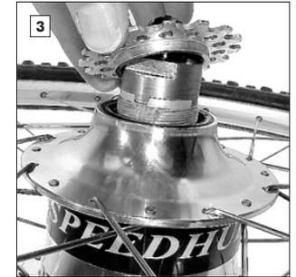
Das Ritzel lässt sich über den Abzieher abnehmen! Ritzel austauschen bzw. um 180° drehen. Vor der Montage Antrieber und Ritzel säubern und Ritzelgewinde fetten. Ritzel über den gesicherten Abzieher rechtsdrehend aufschrauben und mittels Kettenpeitsche im 14. Gang anziehen.
