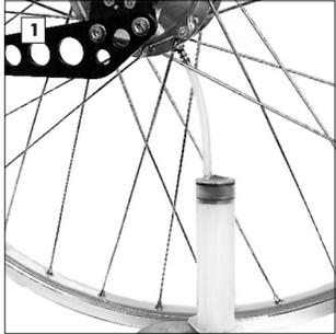
Der Ausbau des Getriebeblocks beginnt mit dem Spülen und Absaugen des Öls (siehe Kapitel "Ölwechsel"), Ölablassschraube danach nicht mehr einschrauben.
