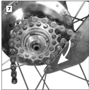
Ritzel auf den Antrieber aufschrauben und bis Anschlag mit der Kettenpeitsche festziehen.
