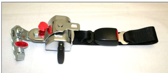
Abbildung 177: Retraktor hinten „Semi-Automatik“ mit Handrad, Gurtschloss und Schlosszunge
