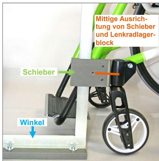
Abbildung 96: Überprüfung der Einstellung der Lenkradgabelrehachsen
