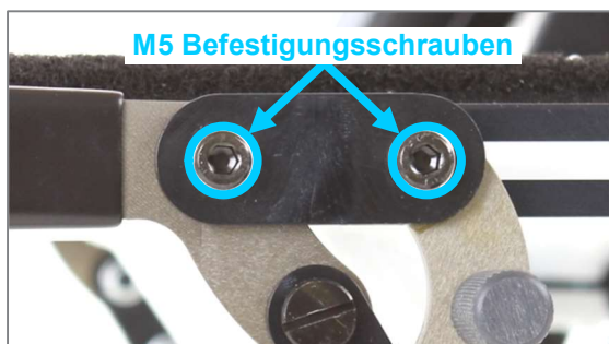
Abbildung 140: M5 Befestigungsschrauben an der Bremshalteschiene
