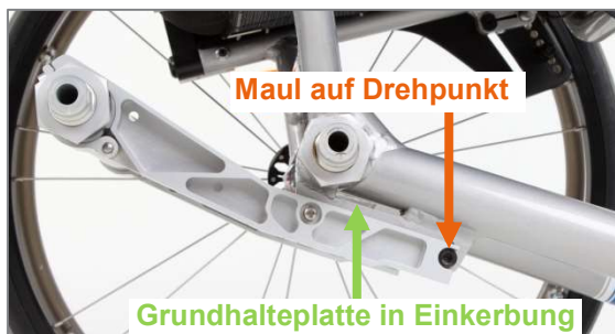
Abbildung 74: Radstandsverlängerung angebracht (Ansicht von der Produktaußenseite ohne Antriebsrad)
