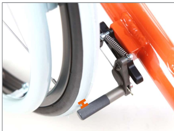
Abbildung 151: Abstand zwischen Bremsbolzen und Bereifung ca. 3 bis maximal 4 mm, bei geöffneter Bremse
