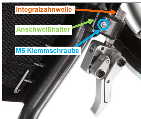
Abbildung 164: Bezeichnungsübersicht der Integralbremse (Produktansicht von unten)
