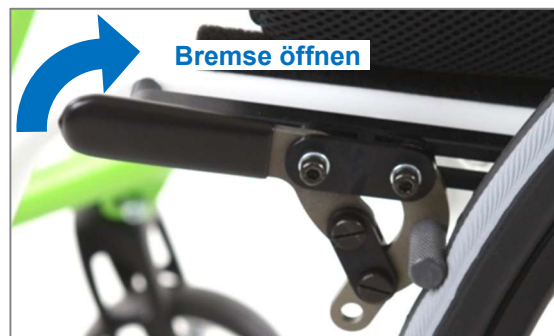
Abbildung 139: Bremse geschlossen; Öffnen erfolgt durch nach hinten-oben Ziehen des Bremshebels
