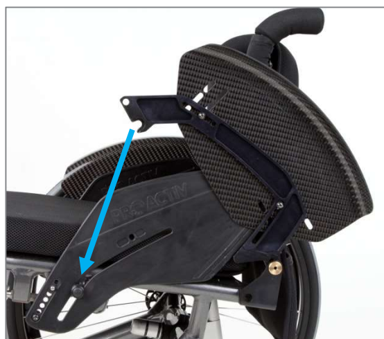
Abbildung 48: Aufnahmebügel auf Rückengelenkwelle aufgesteckt (Ansicht ohne Antriebsrad)
