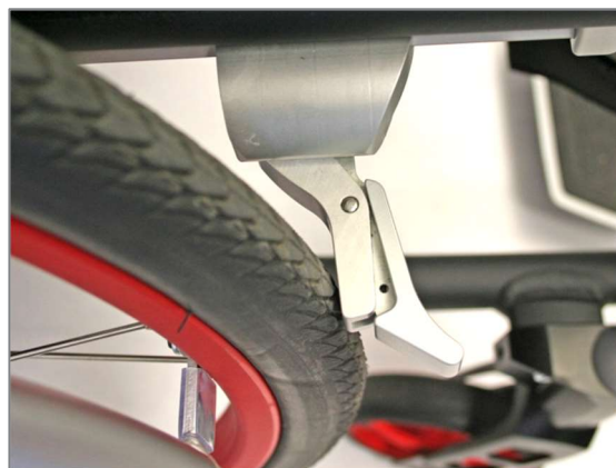
Abbildung 159: Bremselement an der Bereifung anliegend
