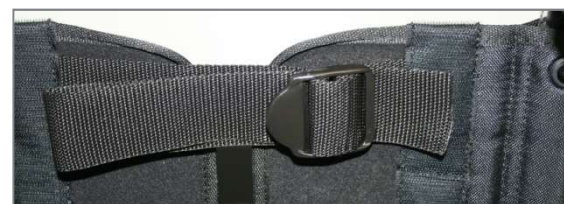
Abbildung 26: Schritt 9: Gurt fertig eingefädelt
