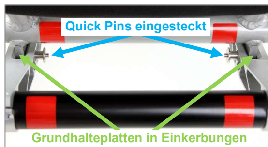
Abbildung 75: Radstandsverlängerung angebracht, Quick Pins eingesteckt (Ansicht von hinten)
