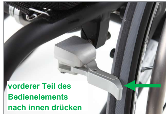
Abbildung 156: Integralbremse geschlossen; Öffnen erfolgt durch Drücken des Bedienelements zur Rollstuhlmitte
