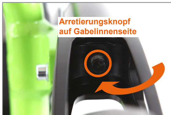
Abbildung 95: Lenkradgabel mit Steckachse und Arretierungsknopf
