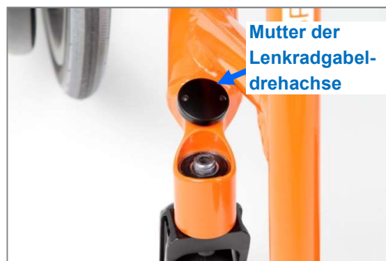
Abbildung 94: Mutter der Lenkradgabeldrehachse vollständig entfernt
