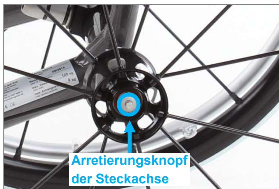
Abbildung 54: Arretierungsknopf der Steckachse in der Mitte der Radachse
