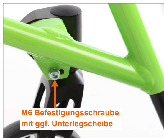
Abbildung 98: M6 Befestigungsschraube an der Rahmeninnenseite, Unterlegscheibe bei G-Form-Rahmen vorhanden, bei V-Form-Rahmen nicht
