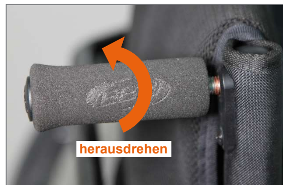
Abbildung 171: Schiebegriff horizontal aus dem Rückenrohr herausdrehen
