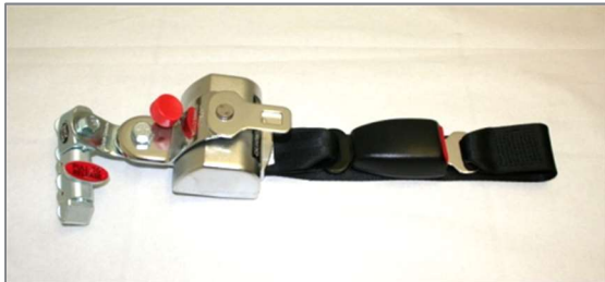
Abbildung 176: Retraktor vorne „Semi-Automatik“ mit Gurtschloss und Schlosszunge
