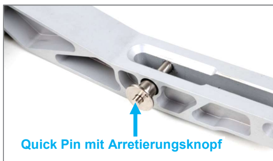
Abbildung 72: Quick Pin der Radstandsverlängerung mit Arretierungsknopf
