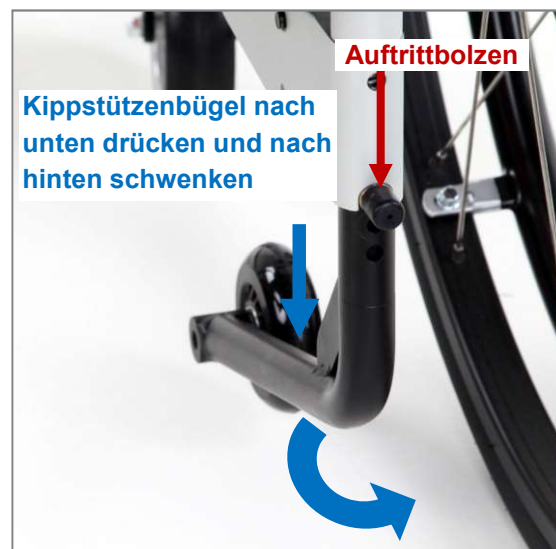
Abbildung 121: Kippstütze in Betriebsstellung bringen (Ansicht von hinten)
