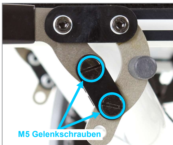
Abbildung 142: M5 Gelenkschrauben zur Einstellung der Betätigungskraft des Bremshebels
