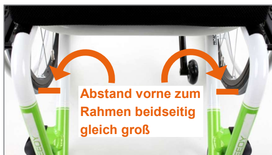
Abbildung 62: Abstand vorne zum Rahmen (SPEEDY F4 und F2 mit klassischer Rahmengeometrie)
