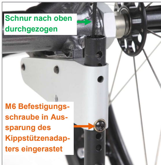
Abbildung 125: Kippstützenbügel in Kippstützenadapter eingesteckt
