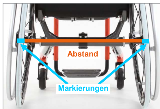
Abbildung 64: Abstand zwischen den Markierungen der Reifen (auf Achshöhe), hinten
