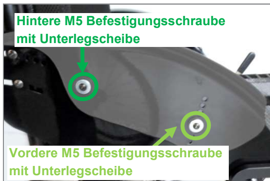
Abbildung 35: Seitenblech mit verschraubtem Kleiderschutz und M5 Befestigungsschrauben (Ansicht ohne Antriebsrad)
