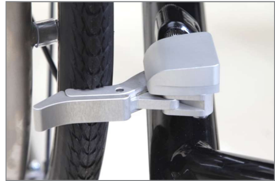
Abbildung 163: Anbringung der Integralbremse am unteren Rahmenrohr
