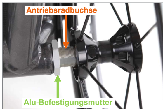
Abbildung 61: Antriebsradbuchse und Alu-Befestigungsmutter (Ansicht von hinten)
