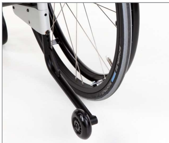
Abbildung 119: Betriebsstellung der Kippstütze (Ansicht von hinten)
