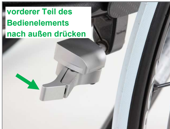
Abbildung 154: Integralbremse geöffnet; Schließen erfolgt durch nach außen Drücken des Bedienelements
