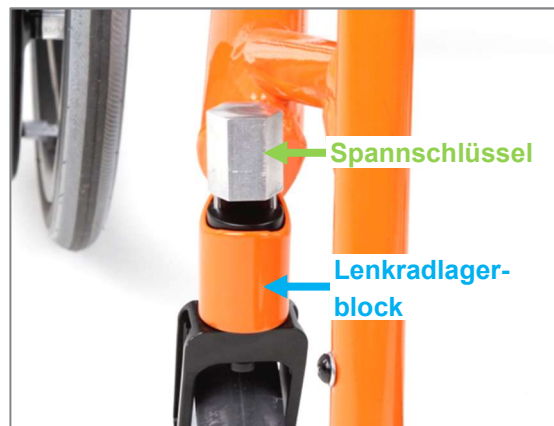
Abbildung 93: Lösen der Mutter der Lenkradgabeldrehachse mit dem Spannschlüssel
