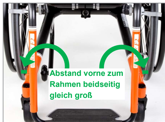
Abbildung 63: Abstand vorne zum Rahmen (SPEEDY F2 oversized)
