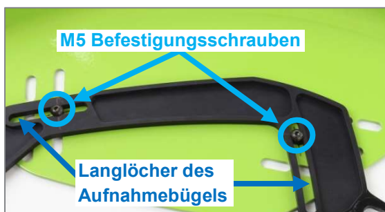
Abbildung 50: M5 Befestigungsschrauben und Langlöcher des Aufnahmebügels
