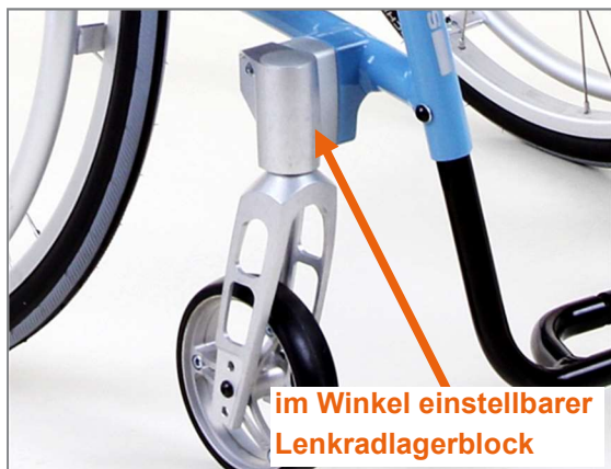
Abbildung 80: Im Winkel einstellbarer Lenkradlagerblock
