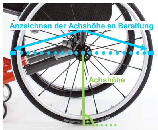
Abbildung 59: Anzeichnen der Achshöhe vorne und hinten auf beiden Reifen
