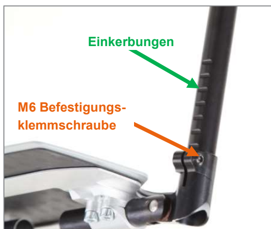
Abbildung 117: Einkerbungen und M6 Befestigungsklemmschraube zur Unterschenkellängeneinstellung (Ansicht von hinten)
