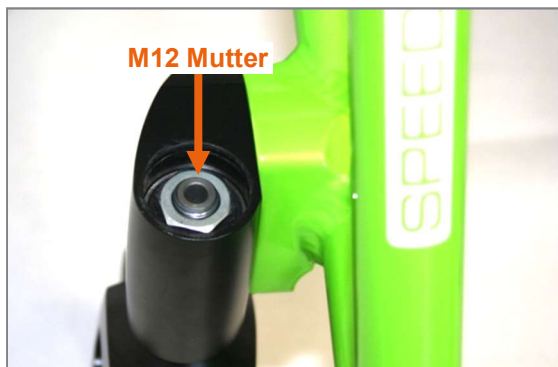
Abbildung 92: Alu-Kappe abgenommen und M12 Mutter sichtbar
