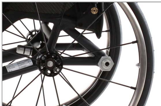
Abbildung 69: Radstandsverlängerung fest verschweißt (SPEEDY F2 oversized)
