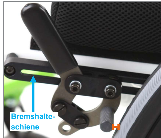
Abbildung 141: Abstand zwischen Bremsbolzen und Bereifung von ca. 3 bis maximal 4 mm bei geöffneter Bremse
