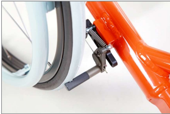
Abbildung 147: Bremse geschlossen; Bremsbolzen drückt Bereifung ca. 4 mm ein
