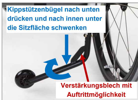
Abbildung 123: Kippstütze in Passivstellung bringen (Ansicht von hinten)
