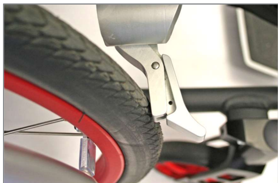
Abbildung 166: Bremsselement an der Bereifung anliegend
