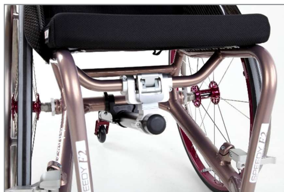
Abbildung 132: Mittelkippstütze abnehmbar (Ansicht von vorne)
