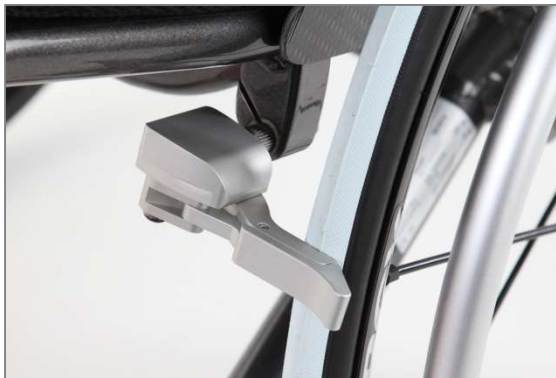
Abbildung 161: Anbringung der Integralbremse am oberen Rahmenrohr
