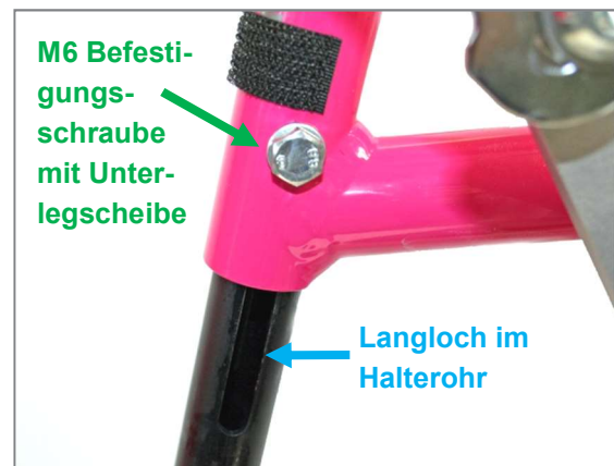
Abbildung 108: M6 Befestigungsschraube mit Unterlegscheibe und Langloch im Fußstützen-Halterohr zur Einstellung der Unterschenkelänge
