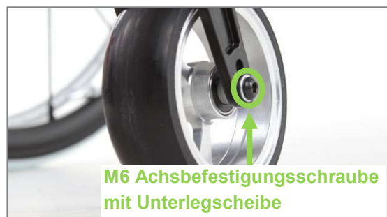
Abbildung 85: M6 Achsbefestigungsschraube der Lenkradachse (Ansicht von Produktaußenseite)
