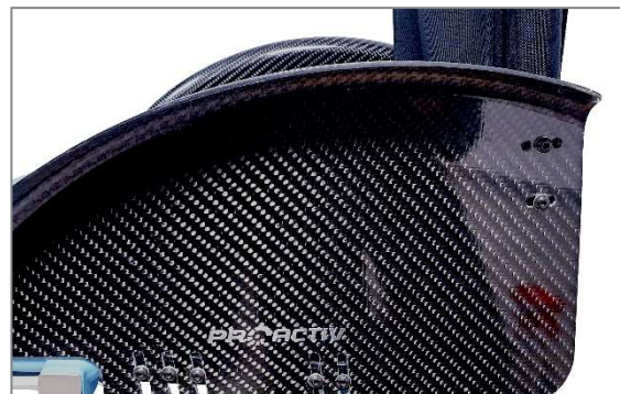
Abbildung 4: Rückenlehne fest über Seitenblech verschraubt, Ausstattung Seitenteil Carbon mit integriertem Kleiderschutz
