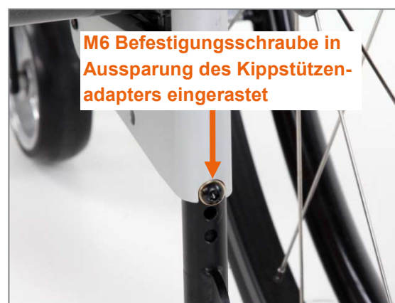
Abbildung 122: Kippstütze ordnungsgemäß eingerastet
