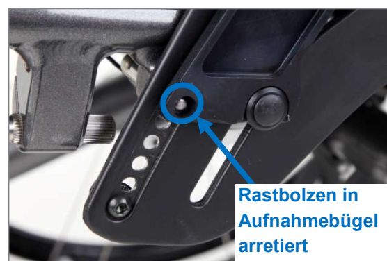
Abbildung 44: Rastbolzen in Aufnahmebügel des Kleiderschutzes arretiert (Ansicht mit Kleiderschutz)
