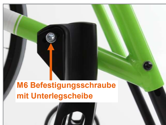
Abbildung 99: M6 Befestigungsschraube an der Rahmenaußenseite
