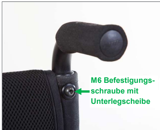
Abbildung 169: Aluminium-Schiebegriffe fest im Rückenrohr montiert
