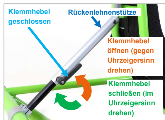
Abbildung 33: Winkelverstellung der Rückenlehne über Klemmhebel
