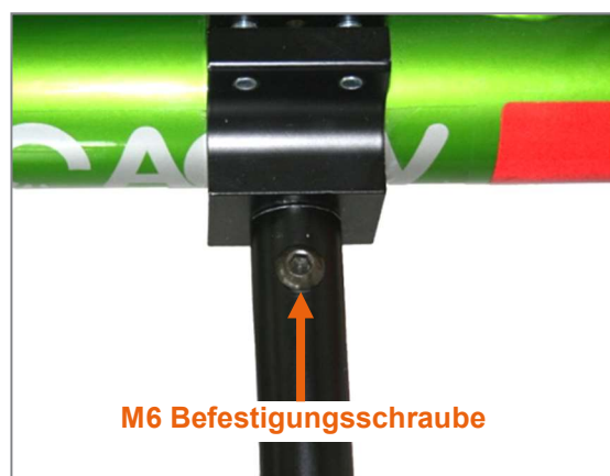
Abbildung 44: M6 Befestigungsschrauben an den Klemmschellen am Achsrohr
