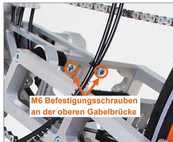
Abbildung 5: M6 Befestigungsschrauben an der oberen Gabelbrücke
