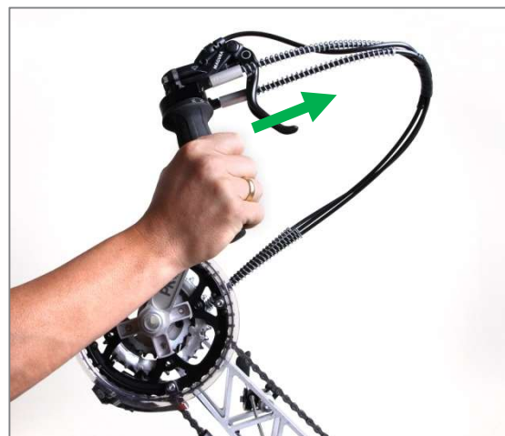
Abbildung 11: Richtiger Halt des Griffes bei der Rohloff Nabenschaltung
