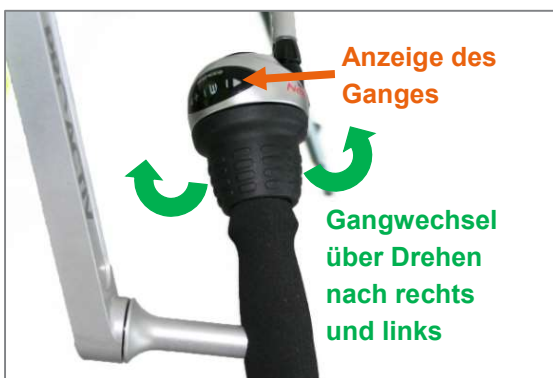
Abbildung 17: Schalten über Drehgriff bei Shimano Nexus Nabenschaltung
