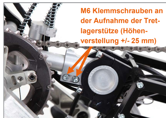
Abbildung 8: M6 Klemmschrauben für die Höhenverstellung der Tretlagerposition
