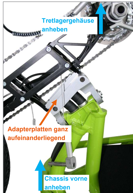
Abbildung 61: Adapterplatten von Antriebseinheit und Chassis aufeinander liegend
