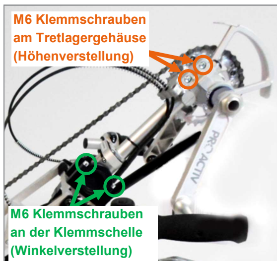
Abbildung 7: M6 Klemmschrauben für Winkel- und Höhenverstellung der Tretlagerposition
