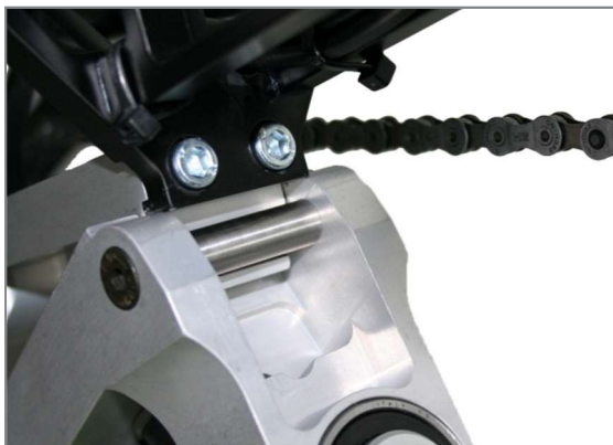
Abbildung 59: Einhängemaul der Antriebseinheit rutscht unter die Einhängewelle am Chassis
