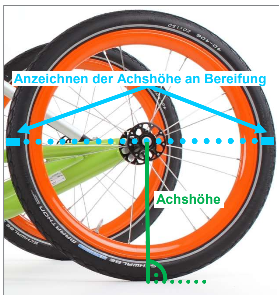
Abbildung 48: Anzeichnen der Achshöhe vorne und hinten auf beiden Bereifungen der Laufräder
