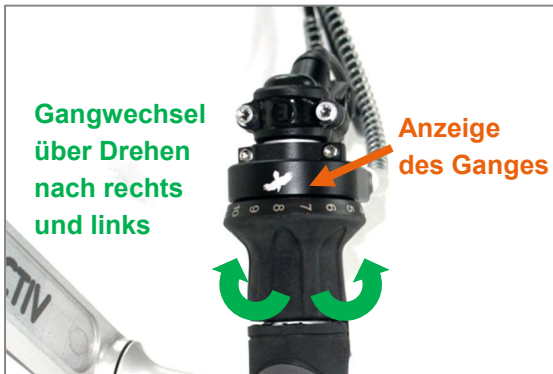
Abbildung 16: Schalten über Drehgriff bei Rohloff Nabenschaltung
