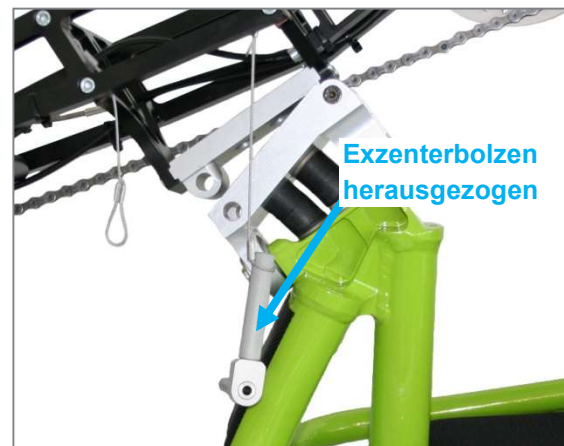
Abbildung 65: Exzenterbolzen aus den Adapterplatten herausgezogen, Chassis auf Boden abgelassen
