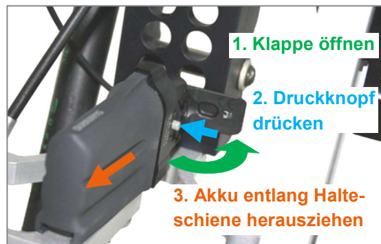
Abbildung 21: Akku zum Laden entnehmen
