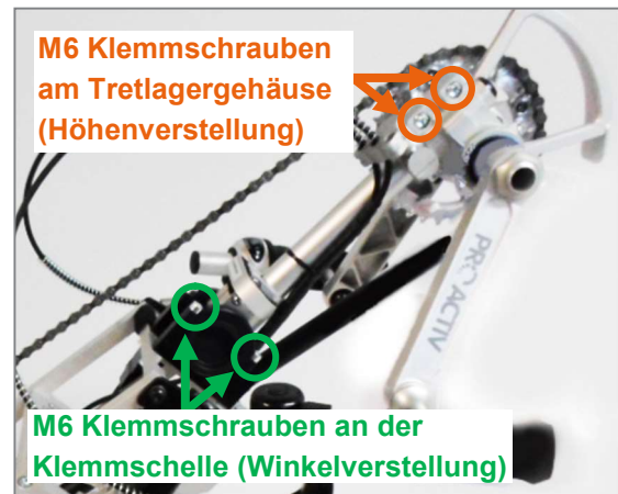
Abbildung 14: M6 Klemmschrauben für Winkel- und Höhenverstellung der Tretlagerposition
