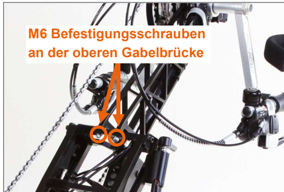
Abbildung 12: M6 Befestigungsschrauben an der oberen Gabelbrücke
