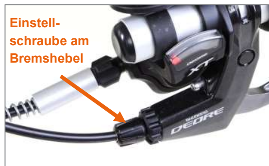
Abbildung 27: Einstellschraube am Bremshebel
