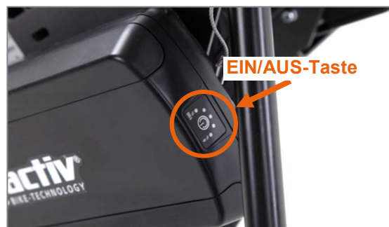
Abbildung 37: Ein- und Ausschalttaste am Akku
