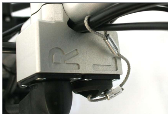
Abbildung 33: Buchsenhalter an der Lenksäule mit Kennzeichnung „R“ für rechten Akku und „L“ für linken Akku (Ansicht von oben)
