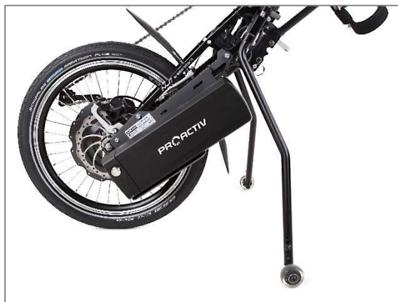
Abbildung 7: Abstellständer in Aktivposition
