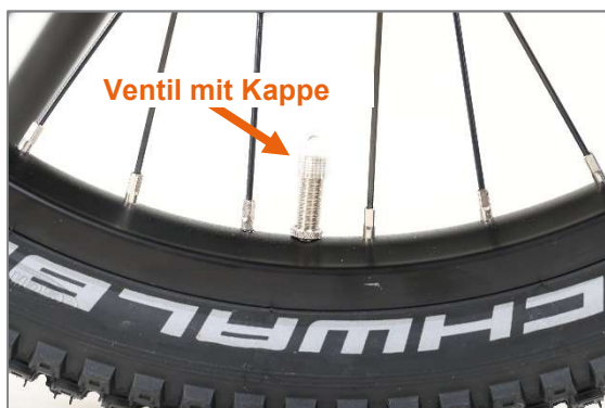
Abbildung 3: Ventil mit Kappe
