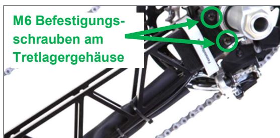
Abbildung 13: M6 Befestigungsschrauben am Tretlagergehäuse
