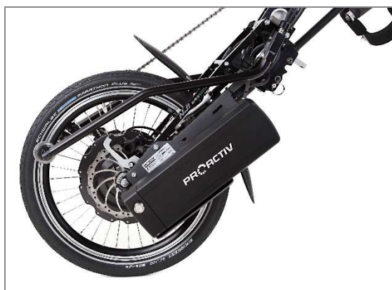
Abbildung 8: Abstellständer in Passivposition
