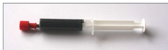
Abbildung 25: Original-Fließfett in der Spritze
