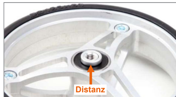
Abbildung 67: Distanz am Lenkrad
