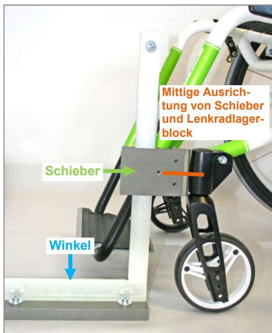
Abbildung 79: Überprüfung der Einstellung der Lenkradgabeldehachsen
