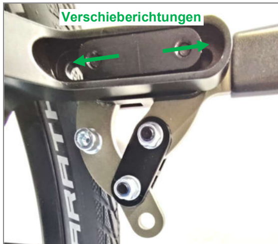
Abbildung 121: Verschieberichtungen (LIFT activ; Ansicht von Rollstuhlinnenseite)
