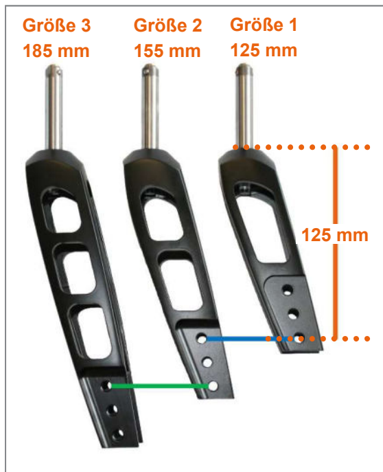
Abbildung 2: Lenkradgabelgrößen mit Kennzeichnung der gleichen Sitzhöheinstellungen bei verschiedenen Lenkradgabelgrößen
