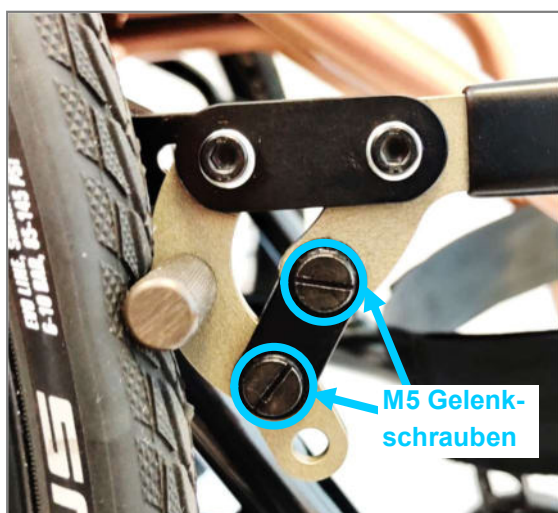
Abbildung 126: M5 Gelenkschrauben zur Einstellung der Betätigungskraft des Bremshebels (vorne montiert)
