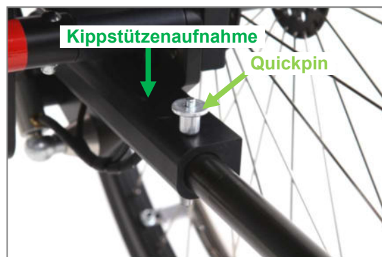
Abbildung 115: Kippstütze mit Quickpin (Ansicht von hinten)
