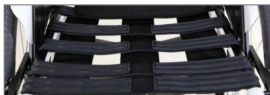
Abbildung 41: Offenes Gurtsystem mit Klett-Flasch-Bändern zur Einstellung des Durchhangs
