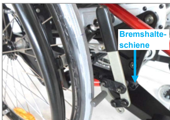
Abbildung 123: Kniehebelbremse (tief montiert), Bremshebel lang; LIFT solid
