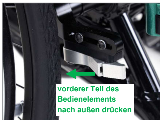
Abbildung 132: Integralbremse geöffnet; Schließen erfolgt durch nach außen Drücken des Bedienelements
