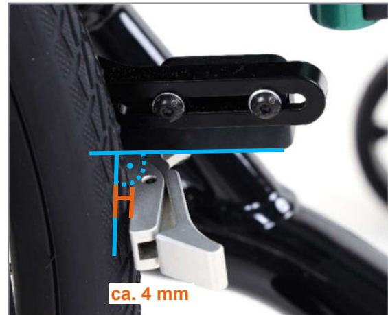
Abbildung 136: Bremselement nach richtiger Positionierung der Integralbremse
