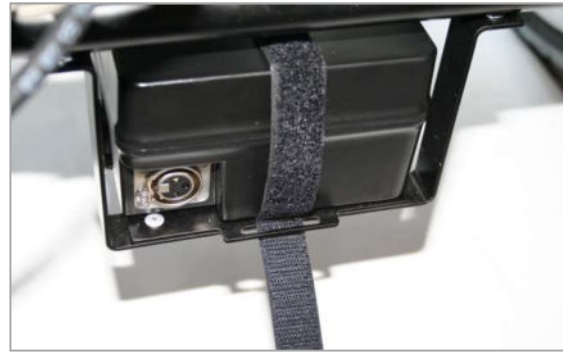
Abbildung 160: Klettband lösen, Schritt 1
