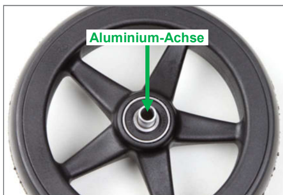
Abbildung 70: Lenkrad mit Aluminium-Achse
