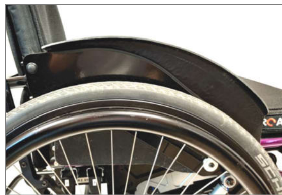
Abbildung 44: Kleiderschutz am Produkt angebracht (Ansicht mit Antriebsrad)
