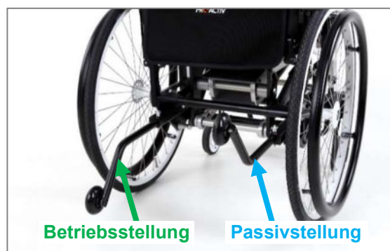
Abbildung 116: Betriebs- und Passivstellung der Kippstütze (Ansicht von hinten)
