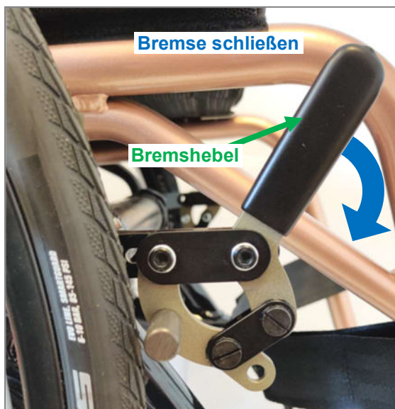
Abbildung 119: Bremse geöffnet; Schließen erfolgt durch nach vorne-unten Drücken des Bremshebels
