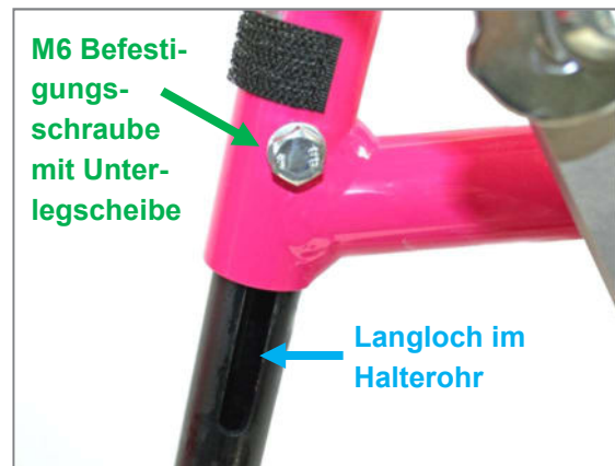
Abbildung 97: M6 Befestigungsschraube mit Unterlegscheibe und Langloch im Fußstützen-Halterohr zur Einstellung der Unterschenkelänge
