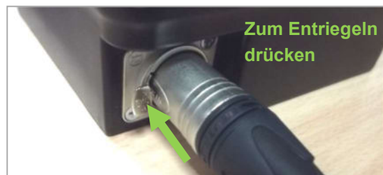
Abbildung 157: Entriegeln des Ladegerät-Steckers
