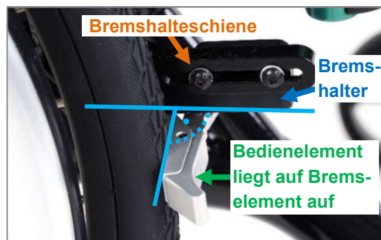
Abbildung 133: Integralbremse geschlossen; Bremsselement senkrecht zum Bremshalter
