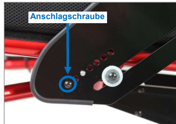
Abbildung 16: Anschlagschraube (Ansicht von Produktaußenseite)
