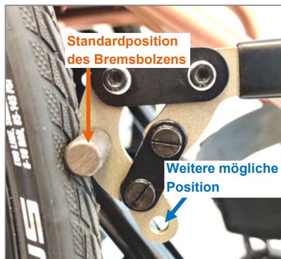
Abbildung 127: Positionen des Bremsbolzens (vorne montiert)
