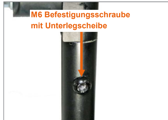
Abbildung 90: M6 Befestigungsschraube mit Unterlegscheibe zur Einstellung der Unterschenkelänge
