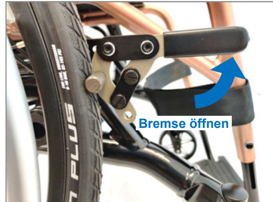
Abbildung 120: Bremse geschlossen; Öffnen erfolgt durch nach hinten-oben Ziehen des Bremshebels
