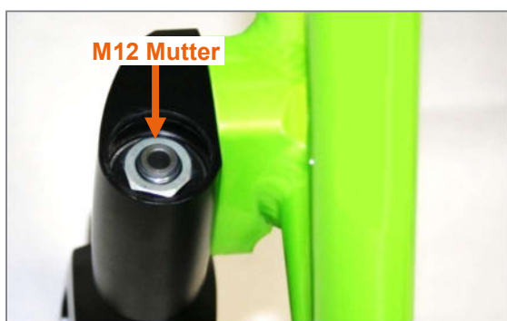
Abbildung 75: Alu-Kappe abgenommen und M12 Mutter sichtbar
