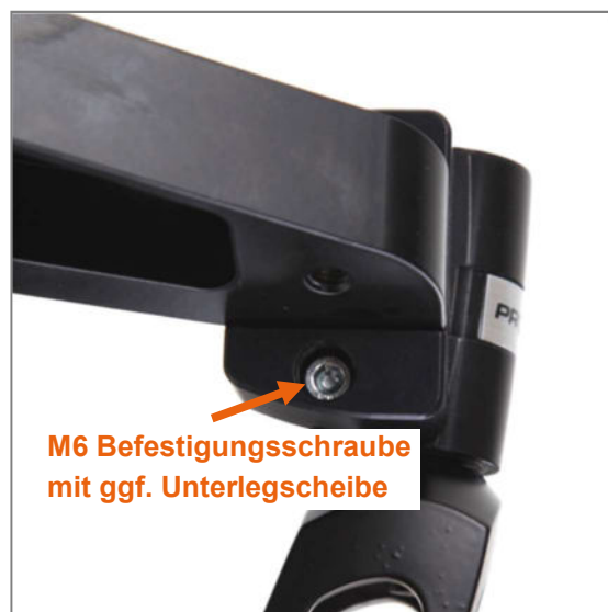
Abbildung 81: M6 Befestigungsschraube an der Rahmeninnenseite, Unterlegscheibe bei G-Form-Rahmen vorhanden, bei V-Form-Rahmen nicht
