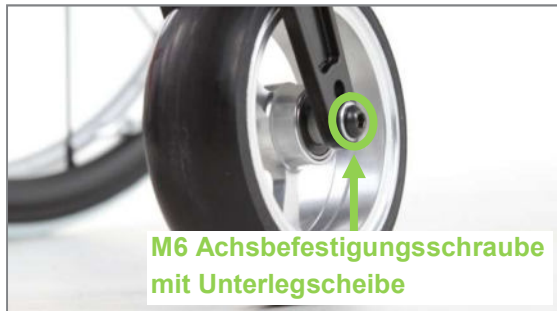
Abbildung 68: M6 Achsbefestigungsschraube der Lenkradachse (Ansicht von Produktaußenseite)
