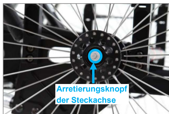
Abbildung 50: Arretierungsknopf der Steckachse in der Mitte der Radachse
