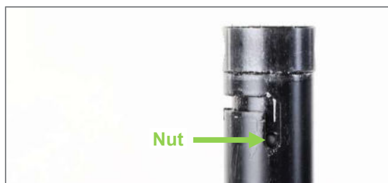
Abbildung 113: Dreheinstellung Kippstütze mit Nut
