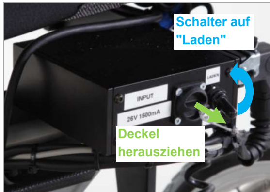
Abbildung 158: Vorbereitung für das Laden an der Rollstuhlrückseite
