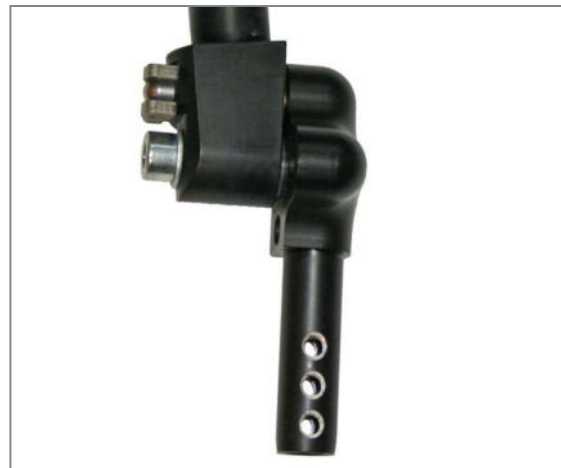
Abbildung 91: Inlett mit 3 Bohrungen (Ansicht ohne Fußstützen-Halterohr)
