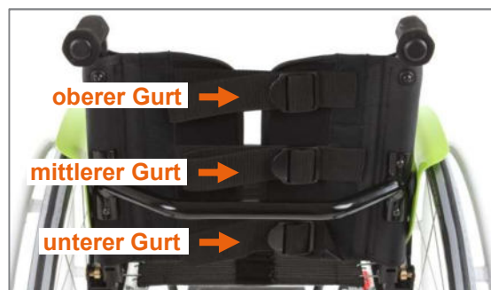
Abbildung 18: Gurtsystem der anpassbaren Rückenbespannung mit drei Gurten
