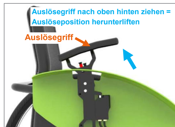
Abbildung 148: Auslösegriff in Auslöseposition herunterliften
