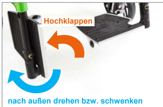
Abbildung 96: Ein Fußstützenteil hochgeklappt, Möglichkeit des nach außen Schwenkens eingezeichnet
