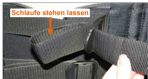
Abbildung 32: Schritt 7: Doppelte Durchführung
