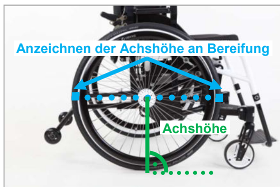
Abbildung 55: Anzeichnen der Achshöhe vorne und hinten auf beiden Reifen (LIFT solid)
