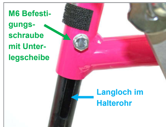
Abbildung 100: M6 Befestigungsschraube mit Unterscheibe und Langloch im Fußstützen-Halterohr zur Einstellung der Unterschenkellänge
