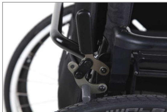
Abbildung 128: Kniehebelbremse hinten montiert (Ansicht von der Seite)
