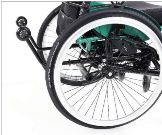
Abbildung 109: Passivstellung der Kippstütze (Ansicht von der Seite)
