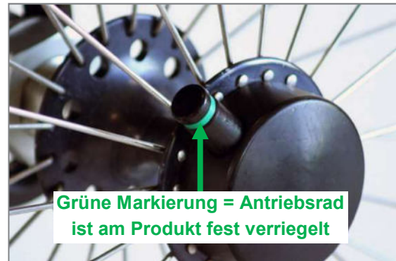
Abbildung 53: Tetra-Clip mit verriegelter Steckachse
