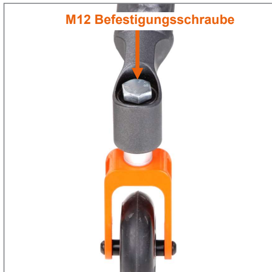
Abbildung 66: Kappe abgenommen und M12 Befestigungsschraube sichtbar
