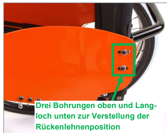
Abbildung 3. Verstellung der Rückenlehnenposition über Bohrungen im Seitenblech
