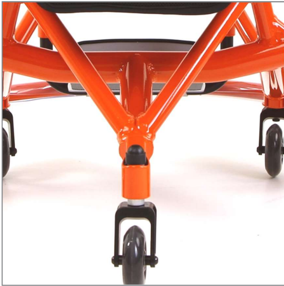
Abbildung 53: Mittelkippstütze oversized fest verschweißt (Ansicht von hinten)
