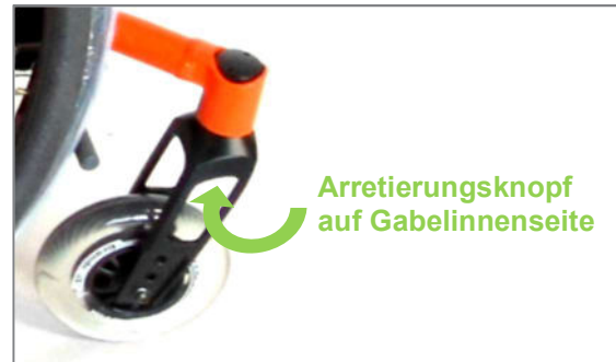
Abbildung 48: Lenkradgabel mit Steckachse und Arretierungsknopf
