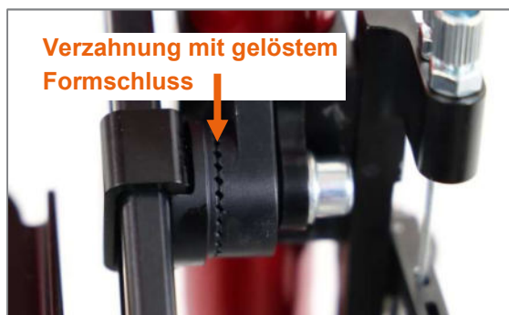
Abbildung 18: Verzahnung am Fußbügelspanner, gelöster Formschluss
