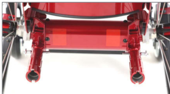
Abbildung 55: Kippstützen abgenommen und Quick Pins in Bohrungen der unteren Rahmenrohre eingesteckt
