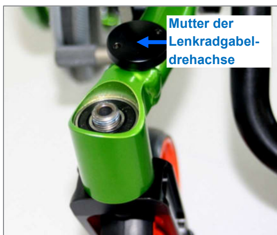
Abbildung 47: Mutter der Lenkradgabel-drehachse vollständig entfernt
