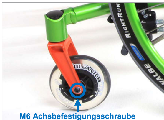
Abbildung 37: M6 Achsbefestigungsschraube der Lenkradachse (Ansicht von Produktaußenseite)
