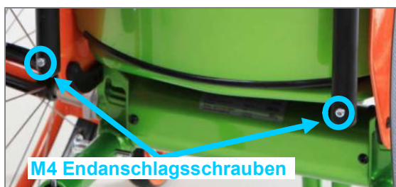
Abbildung 72: M4 Endanschlagsschrauben an den rückverlagerten Schiebegriffen unten angebracht
