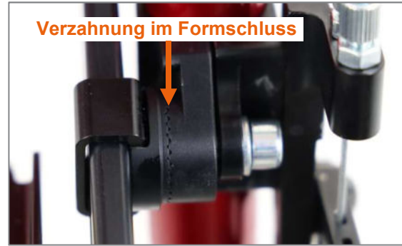
Abbildung 16: Verzahnung am Fußbügelspanner, im Formschluss
