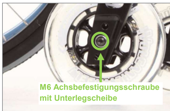
Abbildung 41: M6 Achsbefestigungsschraube der Lenkradachse (Ansicht von Produktaußenseite)
