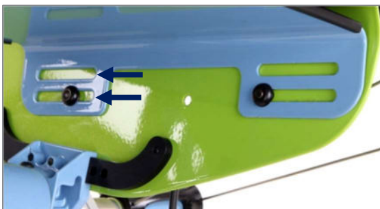
Abbildung 8: Langlöcher der Sitzplatte in unterschiedlichen Höhenpositionen
