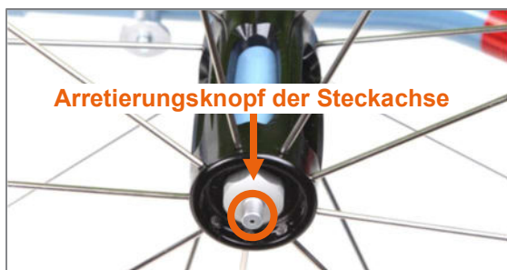
Abbildung 24: Arretierungsknopf der Steckachse in der Mitte der Radachse
