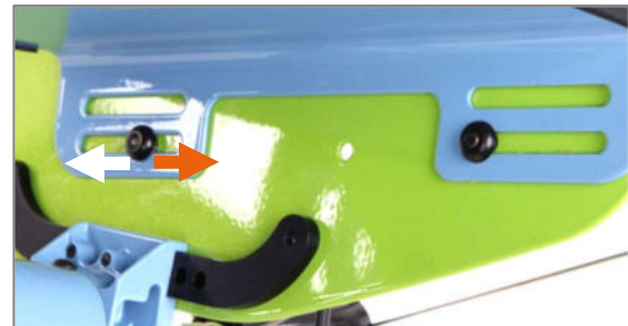
Abbildung 9: Verstellung der Sitztiefe durch Schieben der Sitzplatte entlang ihrer Langlöcher
