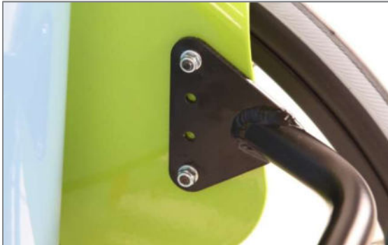
Abbildung 14: Anbindung des Rückenquerbügels bei LITTY 4all
