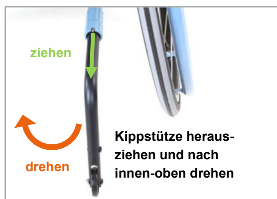
Abbildung 52: Kippstütze von Betriebs- in Passivstellung bringen (Ansicht von hinten)
