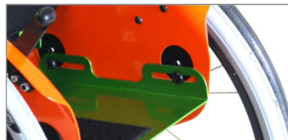
Abbildung 3: Sitzplatte in tiefer Position, Langlöcher oben
