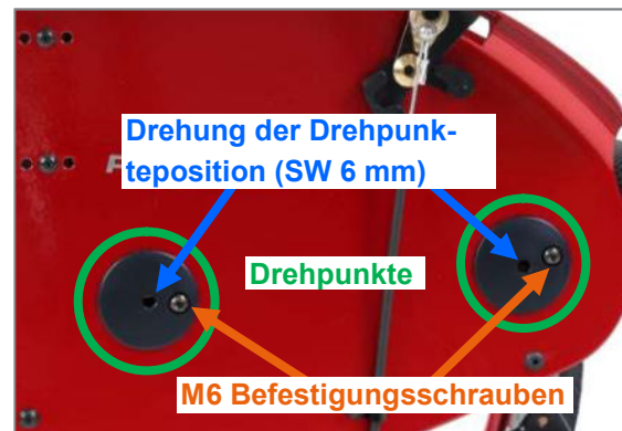
Abbildung 1: Verstellung der Sitzhöhen mithilfe der Drehpunkte
