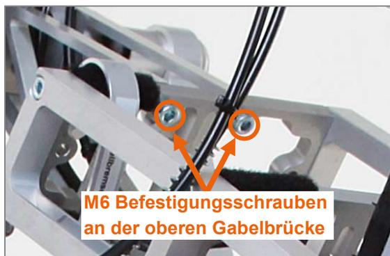
Abbildung 5: M6 Befestigungsschrauben an der oberen Gabelbrücke
