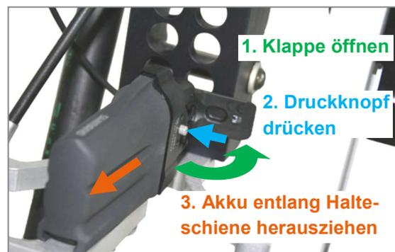
Abbildung 16: Akku zum Laden entnehmen
