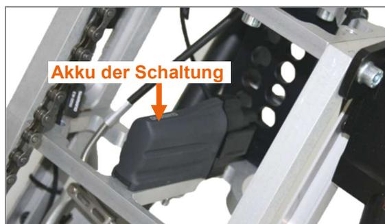
Abbildung 15: Akku der elektronischen Schaltung Alfine Di2
