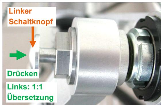
Abbildung 19: Linker Schaltknopf der Tretlagerschaltung
