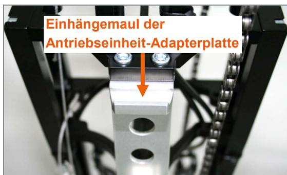
Abbildung 59: Einhängemaul der Antriebseinheit-Adapterplatte
