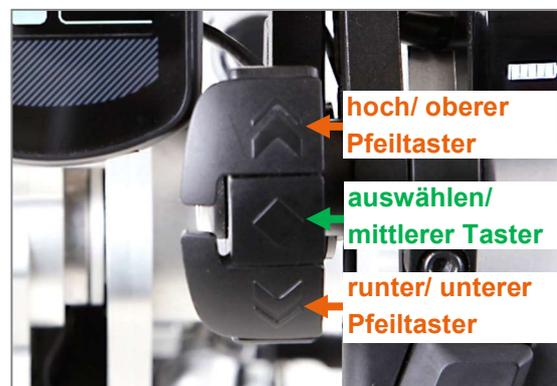
Abbildung 27: Taster des Controllers
