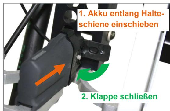
Abbildung 18: Akku nach dem Laden wieder anschließen
