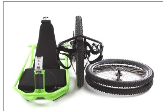
Abbildung 71: Packmaß: Chassis und Antriebseinheit getrennt und Laufräder abgenommen
