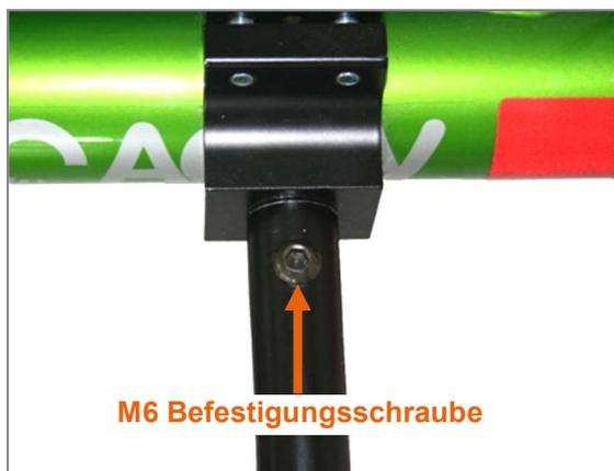
Abbildung 46: M6 Befestigungsschrauben an den Klemmschellen am Achsrohr
