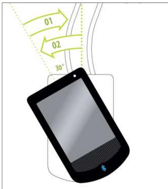
Abbildung 29: Anbringung und Abnahme des Displays
