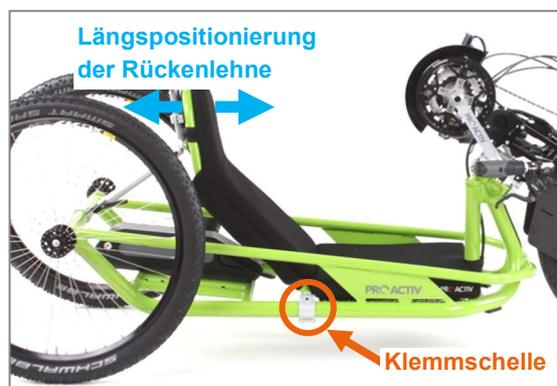
Abbildung 37: Klemmschelle für Längspositionierung der Rückenlehne
