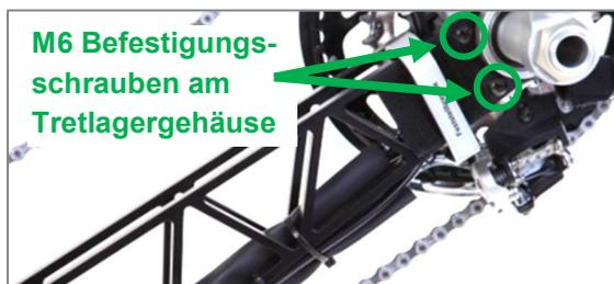
Abbildung 6: M6 Befestigungsschrauben am Tretlagergehäuse
