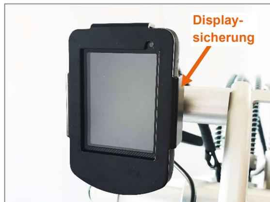
Abbildung 30: Display mit Displaysicherung
