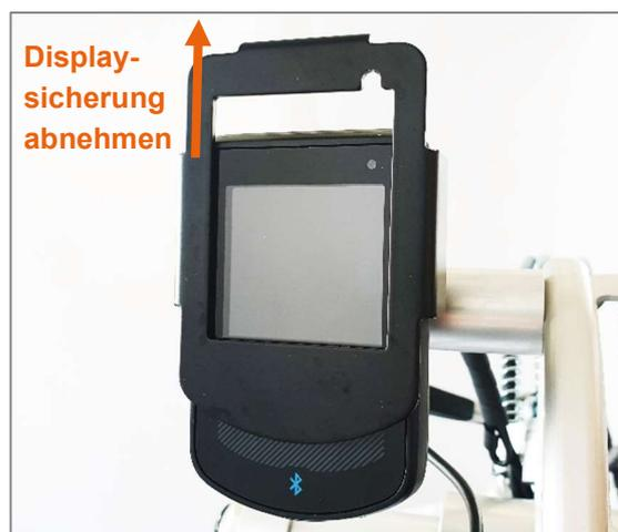
Abbildung 31: Abnahme Displaysicherung
