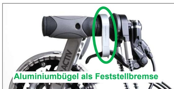
Abbildung 24: Aluminiumbügel als Feststellbremse
