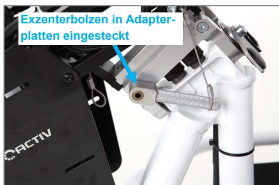
Abbildung 64: Exzenterbolzen eingesteckt
