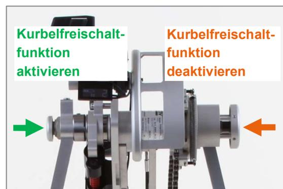
Abbildung 25: Druckteller rechts und links
