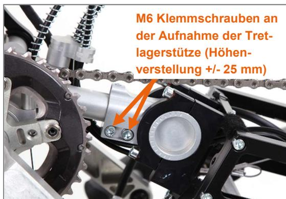
Abbildung 8: M6 Klemmschrauben für die Höhenverstellung der Tretlagerposition
