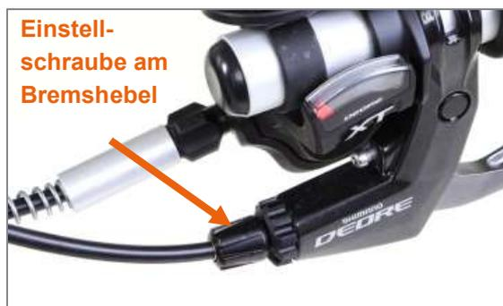
Abbildung 23: Einstellschraube am Bremshebel
