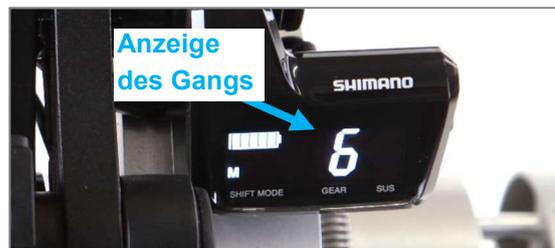
Abbildung 13: Anzeige des aktuellen Gangs im Display
