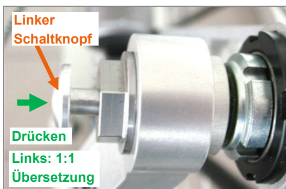
Abbildung 18: Linker Schaltknopf der Tretlagerschaltung
