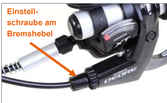
Abbildung 22: Einstellschraube am Bremshebel
