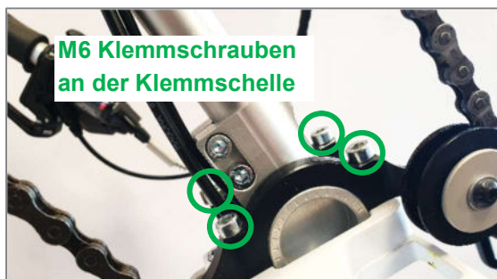
Abbildung 12: M6 Klemmschrauben an der Klemmschelle
