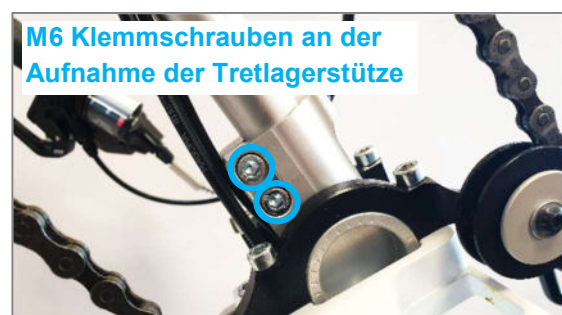
Abbildung 14: M6 Klemmschrauben an der Aufnahme der Tretlagerstütze für die Höhenverstellung der Tretlagerposition und den Austausch der Tretlagerstütze
