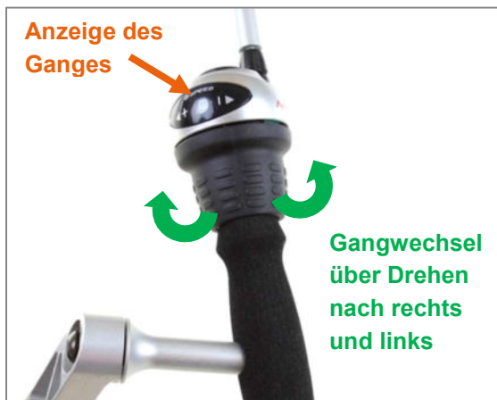
Abbildung 17: Schalten über Drehgriff bei Shimano Nexus Nabenschaltung
