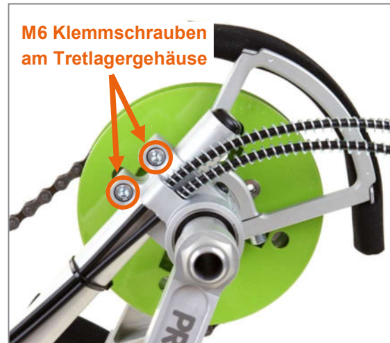
Abbildung 13: M6 Klemmschrauben am Tretlagergehäuse für die Höhenverstellung der Tretlagerposition und den Austausch der Tretlagerstütze
