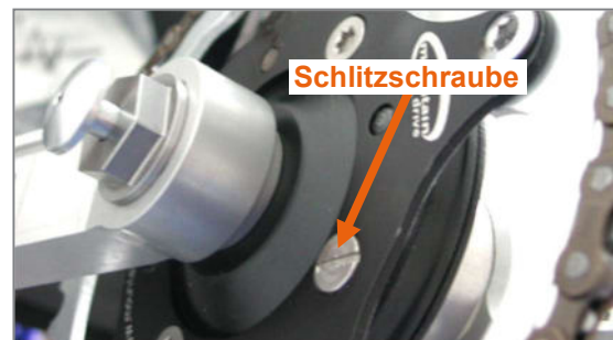
Abbildung 19: Schlitzschraube zum Fetten
