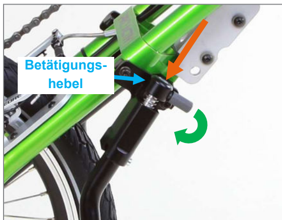
Abbildung 6: Nach unten Drücken und Drehen des Betätigungshebels
