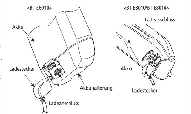
3. Schließen Sie nach dem Laden die Kappe des Ladeanschlusses dicht zu.
