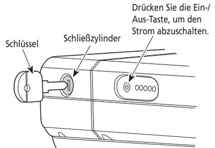
**2.** Drehen Sie den Schlüssel, bis Sie Widerstand spüren.
