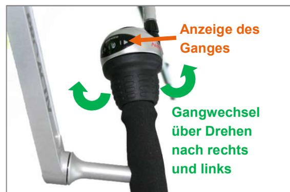
Abbildung 24: Schalten über Drehgriff bei Shimano Nexus Nabenschaltung
