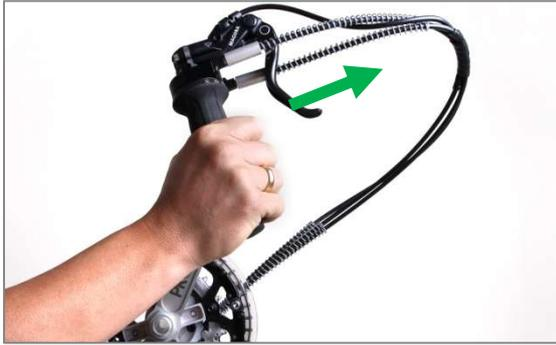
Abbildung 18: Richtiges Halten des Griffes bei der Rohloff Nabenschaltung
