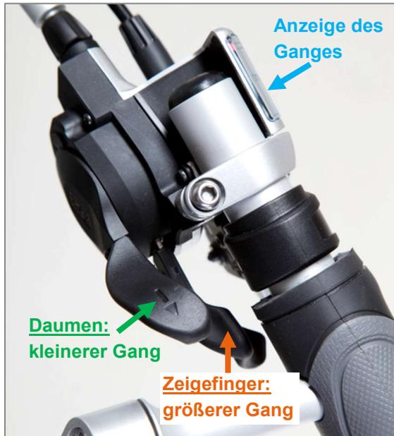
Abbildung 25: Schalten über Daumen-Zeigefinger-Schaltarmatur bei Shimano Alfine Nabenschaltung
