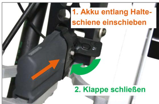
Abbildung 30: Akku nach dem Laden wieder anschließen
