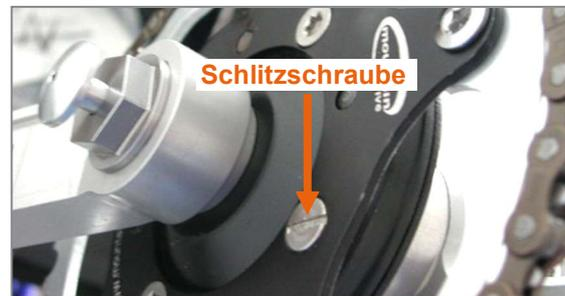
Abbildung 32: Schlitzschraube zum Fetten
