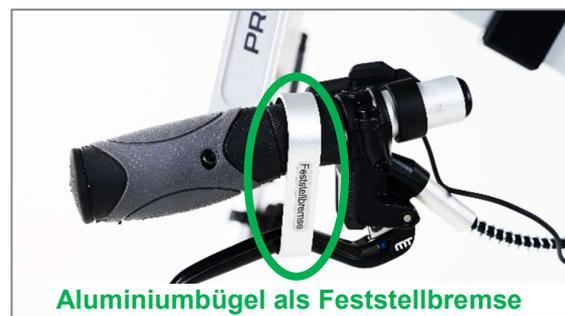
Abbildung 36: Aluminiumbügel als Feststellbremse
