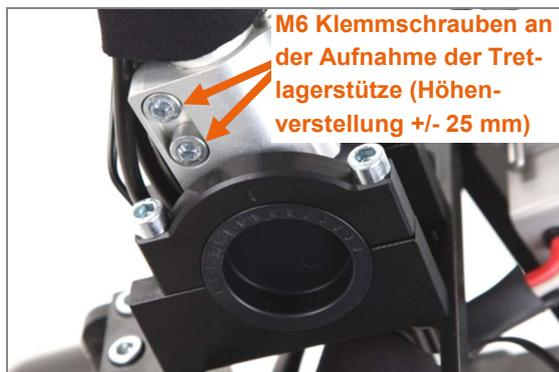
Abbildung 15: M6 Klemmschrauben für die Höhenverstellung der Tretlagerposition
