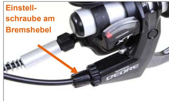
Abbildung 35: Einstellschraube am Bremshebel
