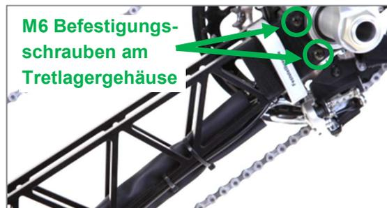
Abbildung 13: M6 Befestigungsschrauben am Tretlagergehäuse
