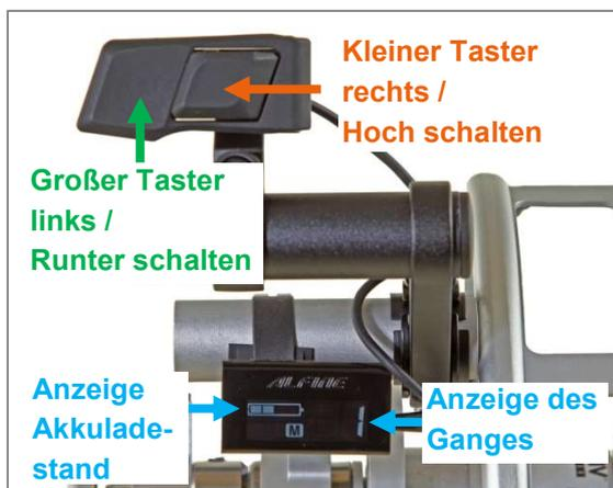
Abbildung 26: Schalten über elektronische Taster bei Shimano Alfine Di2 Nabenschaltung
