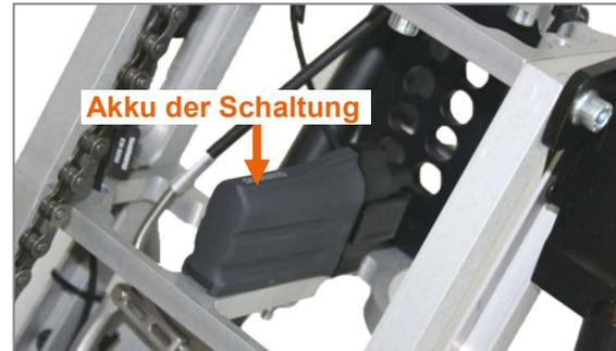
Abbildung 27: Akku der elektronischen Schaltung Alfine Di2
