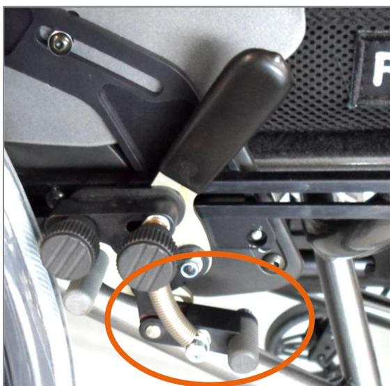
Abbildung 2: Rückrollsicherung
