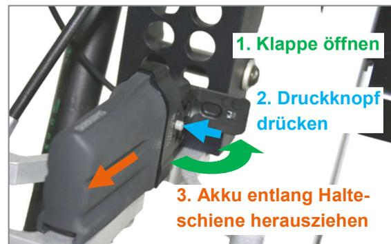
Abbildung 28: Akku zum Laden entnehmen
