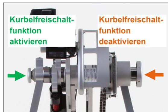
Abbildung 38: Druckteller rechts und links
