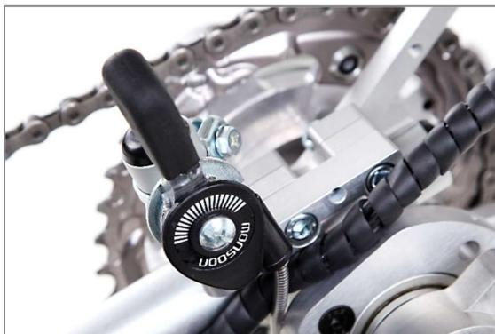
Abbildung 37: Feststellbremse über Rasthebel
