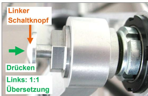
Abbildung 31: Linker Schaltknopf der Tretlagerschaltung
