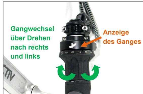
Abbildung 23: Schalten über Drehgriff bei Rohloff Nabenschaltung
