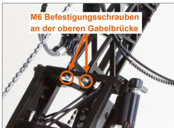
Abbildung 12: M6 Befestigungsschrauben an der oberen Gabelbrücke
