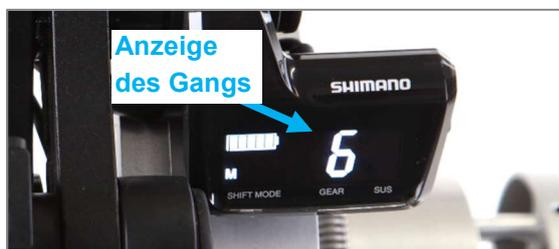
Abbildung 22: Anzeige des aktuellen Gangs im Display
