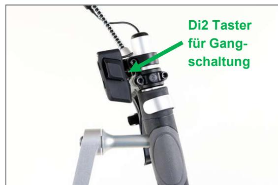
Abbildung 20: Bedienung über Taster
