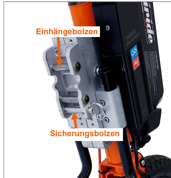
Abbildung 2: Andockplatte mit Einhängebolzen
