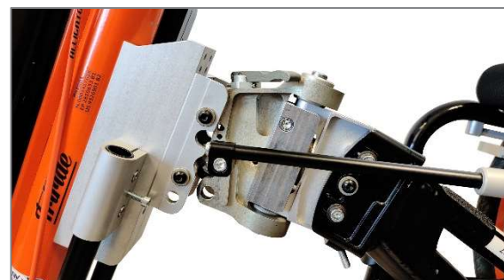
Abbildung 4: Eingehängter Einhängebolzen im Einhängemaul am Lenkkopf
