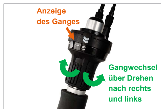
Abbildung 27: Schalten über Drehgriff bei Pinion-Getriebeschaltung
