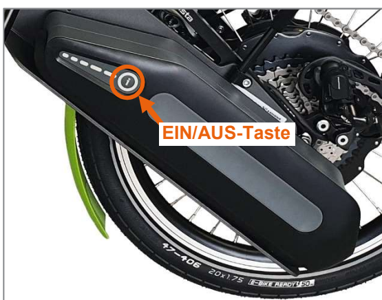
Abbildung 36: Ein- und Ausschalttaste am neodrive Akku
