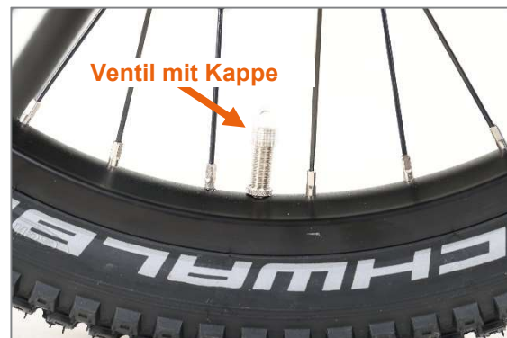
Abbildung 3: Ventil mit Kappe
