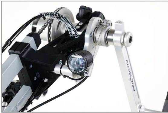
Abbildung 48: Frontbeleuchtung des LED Beleuchtungssets
