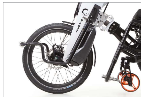
Abbildung 8: Abstellständer in Passivposition
