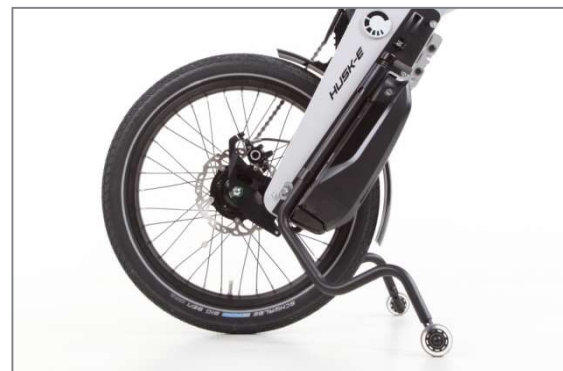
Abbildung 7: Abstellständer in Aktivposition
