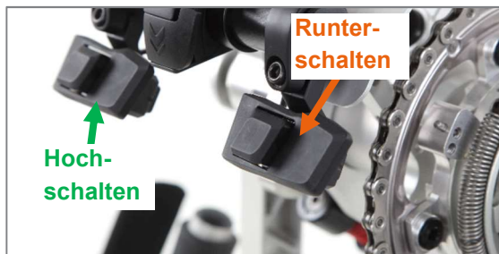
Abbildung 28: Kinnbedienung über Taster
