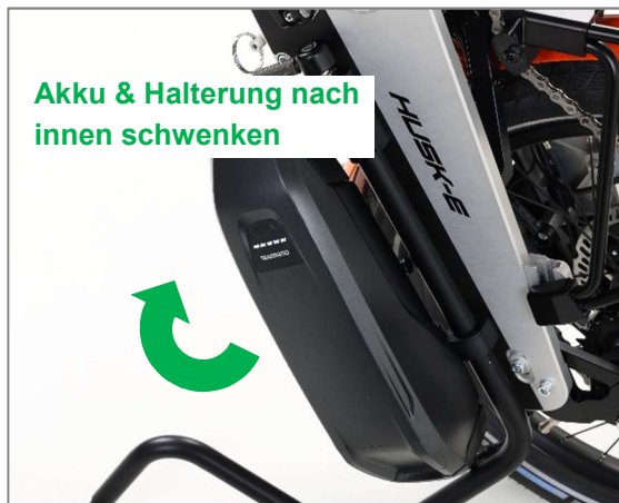
Abbildung 38: Zur Befestigung Akku & Halterung nach innen schwenken
