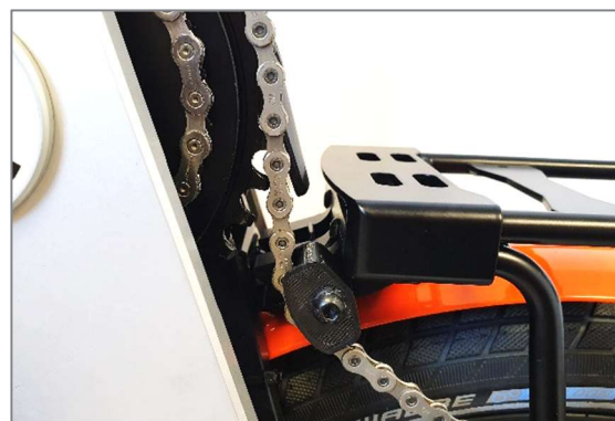
Abbildung 54: Gepäckträger angebracht, Kettenumlenkschuh spannt Kette
