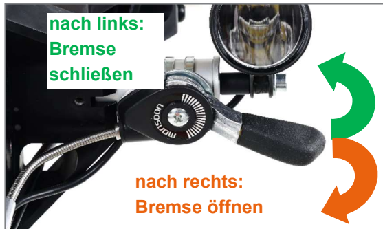
Abbildung 30: Feststellbremse über Rasthebel
