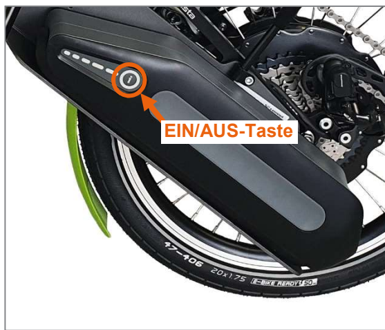
Abbildung 41: Ein- und Ausschalttaste am Akku
