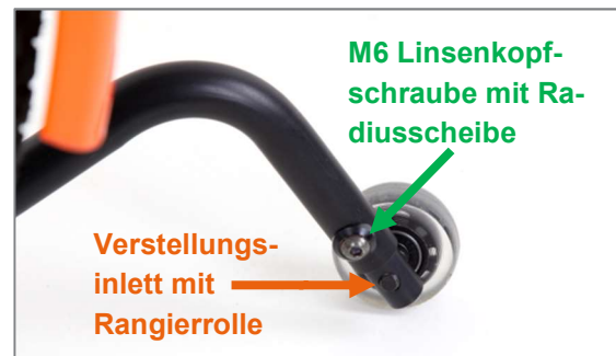
Abbildung 11: M6 Linsenkopfschraube mit Radiuscheibe und Verstellungsinlett zur Höheneinstellung des Abstellständers
