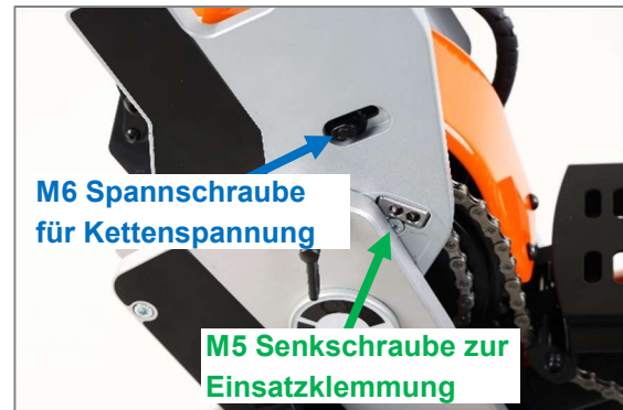
Abbildung 14: Tretlagerpositionen
