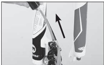
◀ Ziehen Sie das Mineralöl mit der unteren Befüllspritze wieder zurück. Achten Sie darauf, dass in der Befüllspritze am Bremsgriff stets genügend Mineralöl vorhanden ist, um von dort keine Luft ins Bremssystem zu ziehen.
