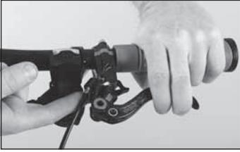
6. Halten Sie den Hebel am Druckpunkt gezogen und kontrollieren Sie, ob alle Anschlüsse, Leitungen, Entlüftungsschrauben und der Ausgleichsbehälter dicht sind.
