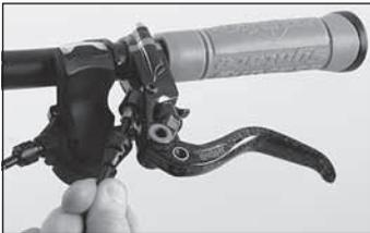
◀ Drücken Sie die Bremsleitung so lange fest in den Bremsgriff, bis die Überwurfmutter festgedreht ist. Schraubendrehmoment: 4 Nm.
