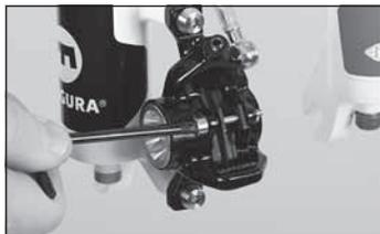
◀ Drehen Sie die Bremsbelag-Halteschraube mit dem Torx T25-Schlüssel heraus.
