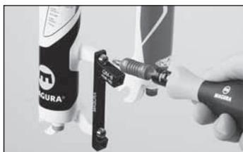
◀ Montieren Sie gegebenenfalls den Bremszangen-Adapter mit den mitgelieferten Halteschrauben an Gabel oder Rahmen.
