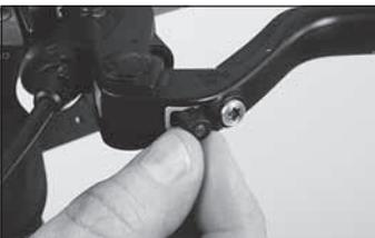
◀ Bei den BAT Bremsgriffen der MAGURA MT-Modellreihe lässt sich auch der Druckpunkt, bei dem die Bremsbeläge an der Bremsscheibe anliegen, nach persönlichen Vorlieben einstellen. Drehen Sie dazu an der BAT-Schraube am Bremsgriff. Achten Sie auch hier darauf, dass sich der Bremshebel nicht bis zum Lenkergriff ziehen lässt!
