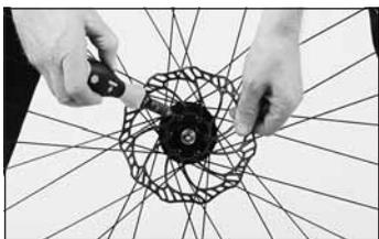
◀ Demontieren Sie die Bremsscheibe mit dem Torx T25-Schlüssel.
