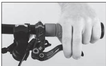
◀ Ziehen Sie mehrmals am Bremshebel, bis der Druckpunkt wieder seine gewohnte Position einnimmt.
