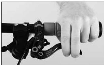
1. Sind Sie mit hydraulischen Scheibenbremsen von MAGURA vertraut? Prüfen Sie, ob Sie die Vorderradbremse mit demselben Bremsgriff (rechts oder links) bedienen können, wie Sie es gewohnt sind. Ist dies nicht der Fall, lassen Sie die Bremsgriffe noch vor der ersten Fahrt von Ihrem MAGURA Fachhändler umbauen.
