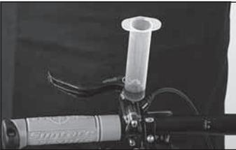
◀ Stecken Sie den Ansatz der zweiten Befüllspritze ohne Kolben vollständig in die obere EBT-Entlüftungsbohrung. Alternative: Benutzen Sie das „Pro Bleed Kit“.
