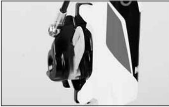
◀ Stecken Sie die Transportsicherung mit dem dicken Ende in die Bremszange zwischen die Nehrmerkolben und sichern Sie sie mit einem Gummiband.
