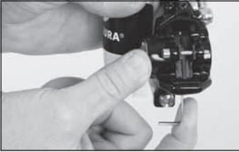
◀ Stecken Sie das Werkzeug zwischen die Bremsbeläge und schieben Sie damit einen der Bremskolben ganz zurück. Stützen Sie beide Daumen auf der Bremszange ab und ziehen Sie das Werkzeug mit den Fingern.
