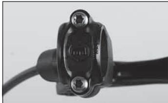
◀ Der Bremsgriff kann wahlweise links oder rechts am Lenker montiert werden. Dazu muss lediglich die Bremsgriff-Klemmschelle korrekt ausgerichtet werden: mit dem dickeren Ende nach oben. Auf Bremsgriff-Klemmschellen aus Aluminium ist zusätzlich ein Pfeil angebracht und das MAGURA Logo muss lesbar sein.
