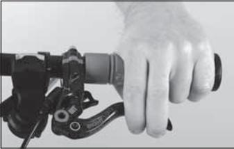
◀ Halten Sie das Werkzeug in dieser Position fest und lassen Sie einen Helfer mehrmals den Bremshebel betätigen, bis ein stabiler Druckpunkt erreicht wird. Dann lassen Sie ihn den Bremshebel wieder lösen.
