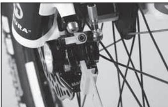
◀ Überprüfen Sie, ob sich der Fühler an der Transportsicherung zwischen die „Ohren“ der Bremsbelagträger stecken lässt. Ist dies nicht der Fall, müssen die Bremsbeläge ausgetauscht werden.
