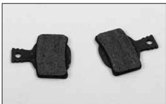
Verschmutzte Bremsbeläge und -scheiben können die Bremskraft drastisch vermindern. Achten Sie daher darauf, dass weder Öl noch andere Flüssigkeiten an die Bremse geraten, z.B. wenn Sie Ihr Rad putzen oder die Kette schmieren. Verschmutzte Beläge lassen sich in keinem Fall reinigen und müssen ersetzt werden! Bremsscheiben können Sie mit Bremsenreiniger oder mit warmem Wasser und Spülmittel reinigen.
