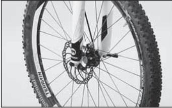
10. Lassen Sie beide Räder frei drehen, um den Rundlauf zu prüfen. Mangelhafter Rundlauf kann auch auf seitlich aufgeplatzte Reifen, gebrochene Achsen und gerissene Speichen hinweisen.
