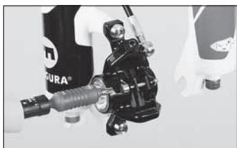
◀ Drehen Sie die Belaghalteschraube mit dem MAGURA Drehmomentschlüssel fest. Schraubendrehmoment: 2,5 Nm.
