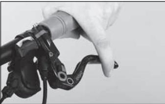
◀ Stellen Sie die Bremshebel-Griffweite mit Hilfe der Griffweiten-Verstellschraube und einem Torx T25-Schlüssel so ein, dass das erste Fingerglied den Bremshebel umfassen kann, ohne dass Sie den Bremshebel ziehen müssen.
