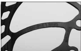
◀ In manchen Fällen bleibt außen am Reibring ein dickerer Steg zurück, wenn die Bremszange etwas tiefer positioniert ist. Dann kann die Dicke der Bremsscheibe nicht mit einem herkömmlichen Messschieber ermittelt werden. Wenden Sie sich in diesem Fall an Ihren MAGURA Fachhändler, der geeignete Messgeräte bereit hält.
