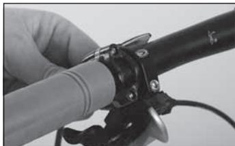
◀ Zuletzt drehen Sie die untere Bremsgriff-Haltemutter fest. Maximales Schraubendrehmoment: 3 Nm.
