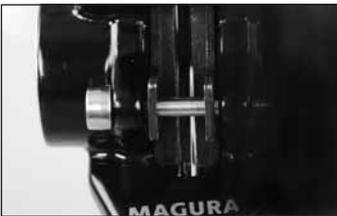
◀ Betätigen Sie den Bremshebel mehrmals bei drehendem Laufrad. Überprüfen Sie dann, ob die Bremsbeläge beidseitig von der Bremsscheibe zurückgezogen werden und parallel zu dieser positioniert sind.
