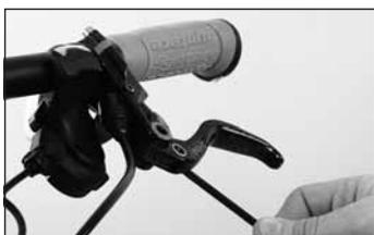
Bei allen Bremsgriffen der MAGURA MT-Modellreihe ist der Winkel am Lenker und der Abstand des Hebels zu den Lenkergriffen einstellbar. Bei bestimmten Modellen kann zusätzlich die Lage des Druckpunktes eingestellt werden (BAT).
