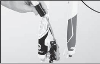
◀ Drehen Sie dann den Schraubstutzen mit den Fingern handfest in die Befüllöffnung der Bremszange. Anschließend drehen Sie diesen mit einem Gabelschlüssel leicht fest.
