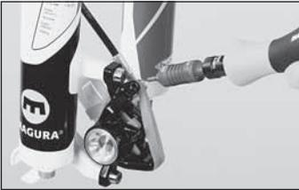
◀ Verschließen Sie die Befüllöffnung mit der Befüllschraube. Schraubendrehmoment: 2,5 Nm.
