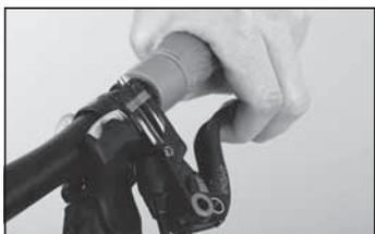
3. Machen Sie eine Bremsprobe im Stillstand, indem Sie die Bremshebel mit zwei Fingern und normaler Bremskraft zum Lenker ziehen. Der Hebel darf sich nicht zum Lenkergriff durchziehen lassen!
