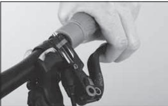
◀ Machen Sie eine Bremsprobe im Stillstand, indem Sie die Bremshebel mit zwei Fingern und normaler Bremskraft zum Lenker ziehen. Der Hebel darf sich nicht zum Lenkergriff durchziehen lassen! Bei Scheibenbremsen muss der Druckpunkt sofort stabil sein. Sollte der Druckpunkt nach zwei Dritteln des Weges nicht erreicht sein, betätigen Sie den Hebel mehrmals („Pumpen“) bis die Beläge an der Scheibe anliegen.
