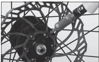
2. Sind sämtliche Schraubverbindungen an der Bremsanlage fest angedreht? Verwenden Sie den mitgelieferten Torx T25-Schlüssel, besser ist jedoch der Magura Drehmomentschlüssel. Zur Kontrolle und beachten Sie die vorgeschriebenen Schraubendrehmomente.
