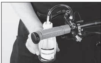
◀ Wenn beim beschriebenen Vorgang keine Luftbläschen mehr austreten, ziehen Sie das Mineralöl so weit in die untere Befüllspritze, bis nur noch eine geringe Menge davon in der oberen Befüllspritze verbleibt.
