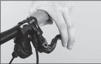
◀ Setzen Sie sich in den Sattel und legen Sie die Hände auf die Bremshebel. Stellen Sie die Neigung der Bremsgriffe so ein, dass Ihre Finger genau in Verlängerung der Arme aufliegen. Weitere Informationen zur Bremsgriff-Montage finden Sie im Kapitel „**Bremse montieren**“.
