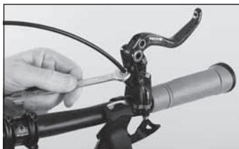
◀ Drehen Sie die Überwurfmutter am Bremsgriff mit dem 8-mm-Gabelschlüssel los.
