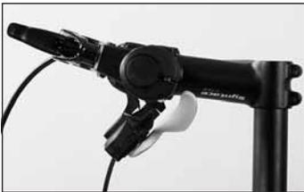
◀ Drehen Sie den Bremsgriff waagrecht und dann noch um 1 cm weiter nach oben. Drehen Sie die Bremsgriff-Haltemutter wieder etwas fest.
