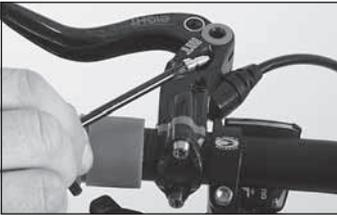
◀ Drehen Sie die obere EBT-Verschlussschraube am Bremsgriff mit dem Torx T25-Schlüssel heraus.
