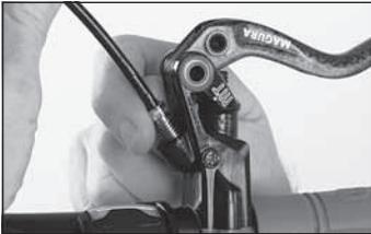
◀ Drehen Sie die Überwurfschraube zwei bis drei Umdrehungen von Hand in den Bremsgriff.
