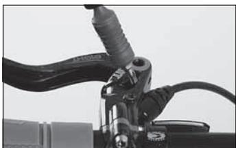
◀ Drehen Sie die EBT-Verschlusschraube in die EBT-Belüftungsbohrung und drehen Sie sie mit dem MAGURA Drehmomentschlüssel fest. Schraubendrehmoment: 0,5 Nm. Die EBT-Schraube muss bündig mit dem Gehäuse sein.
