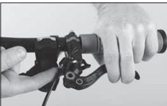
◀ Halten Sie den Hebel am Druckpunkt gezogen und kontrollieren Sie, ob alle Anschlüsse, Leitungen, Entlüftungsschrauben und der Ausgleichsbehälter dicht sind. Alternative: Benutzen Sie das „Pro Bleed Kit“.
