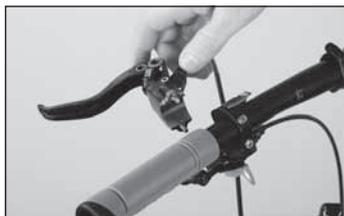
◀ Setzen Sie den Bremsgriff an den Lenker, bringen Sie die Bremsgriff-Klemmschelle wieder an und drehen Sie beide Bremsgriff-Haltemuttern um 2 Umdrehungen auf die Stehbolzen. Dann drehen Sie die obere Bremsgriff-Haltemutter fest. Schraubendrehmoment: 3 Nm.
