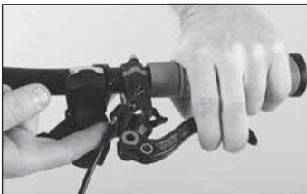
◀ Ziehen Sie am Bremshebel und überprüfen Sie, ob sich der Druckpunkt am Hebel einstellt. Ist dies nicht der Fall, muss die Bremse entlüftet werden (siehe Kapitel „Wartung“). Stellt sich der Druckpunkt ein, halten Sie den Bremshebel gezogen und überprüfen Sie die Bremsleitungs-Anschlüsse auf Dichtigkeit.
