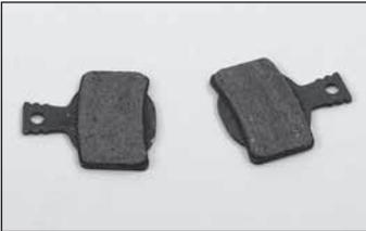
Durch die Reibung verschleifen Bremsbeläge und Scheiben, und zwar umso schneller, je öfter Sie in bergigem Gelände und durch Regen oder Schmutz fahren. MAGURA Scheibenbremsen besitzen einen vollautomatischen Belagsverschleißausgleich. Dieser sorgt dafür, dass der Druckpunkt der Bremse stets gleich positioniert ist. Darum muss der Verschleiß der Bremsbeläge vor jeder Fahrt überprüft werden. Verschlissene Bremsbeläge müssen gegebenenfalls gegen Original-Ersatzteile ausgetauscht werden.
