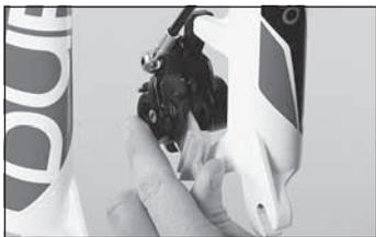
◀ Schieben Sie die Nehmerkolben in der Bremszange bei montierten Bremsbelägen langsam mit der Transportsicherung oder einem breiten Schraubendreher zurück. Wenden Sie dabei keine Gewalt an. Setzen Sie gegebenenfalls von verschiedenen Seiten aus an, bis die Nehmerkolben ohne großen Krafteinsatz vollständig zurückgleiten.
