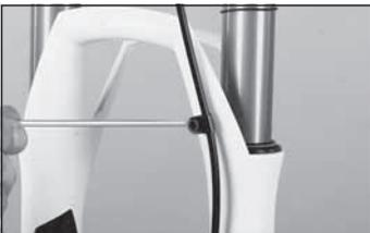
Für eine optimale Verlegung der Bremsleitungen sind die Scheibenbremsen der MAGURA MT-Modellreihe (Ausnahme: Modell MT 2) mit dem innovativen RHR-Leitungsanschluss („Rotatable Hose Routing“) ausgestattet. Dieser ermöglicht eine stufenlose Winkelverstellung der Bremsleitung an der Bremszange, ohne dass dabei das Bremssystem geöffnet und anschließend neu befüllt oder entlüftet werden muss.
