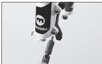
Beachten Sie hierzu den Abschnitt „Bremszangen-Adapter“ im Kapitel „Zubehör + Werkzeug“ Bremszangen-Adapter beiliegende Anleitung. Schraubendrehmoment: 6 Nm.
