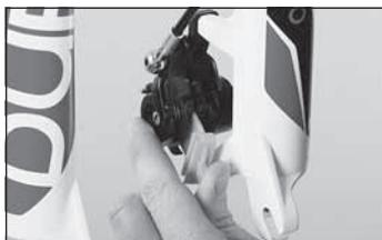
◀ Demontieren Sie Ihr Laufrad, so dass Sie freien Zugang zur Bremszange haben.
