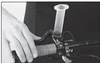
◀ Ziehen Sie zwischendurch auch mehrere Male langsam am Bremshebel und lassen Sie ihn plötzlich los, um hartnäckige Luftbläschen im Bremssystem zu lösen. Alternative: Benutzen Sie das „Pro Bleed Kit“.
