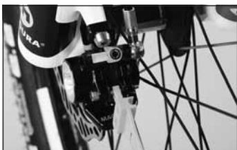
5. Prüfen Sie bei gezogenem Bremshebel auch gleich den Verschleiß der Bremsbeläge. Schieben Sie dazu das hintere Ende der Transportsicherung zwischen die „Ohren“ der Bremsbelagträger. Passt diese Prüflehre nicht mehr zwischen die Belagssohlen, dann sind die Bremsbeläge verschlissen und müssen umgehend ausgetauscht werden.
