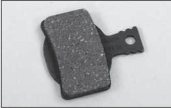
Die Bremsbeläge in den Bremszangen verschleifen durch die Reibung auf der Bremsscheibe. Bei Felgenbremsen ist dies an einem länger werdenden Bremshebelweg zu erkennen. MAGURA Scheibenbremsen besitzen einen vollautomatischen Belagsverschleißausgleich. Dieser sorgt dafür, dass der Druckpunkt stets gleich positioniert ist. Darum muss der Verschleiß der Bremsbeläge vor jeder Fahrt überprüft werden. Verschlissene Bremsbeläge müssen gegebenenfalls gegen Original-Ersatzteile ausgetauscht werden.
