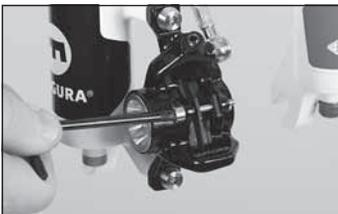
◀ Drehen Sie die Bremsbelag-Halteschraube mit dem Torx T25-Schlüssel heraus.
