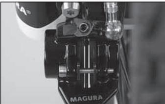
◀ Machen Sie abseits des Straßenverkehrs eine vorsichtige Probefahrt mit einigen Vollbremsungen aus 30 km/h in den Stillstand, um die Bremse einzubremsen. Dadurch zentrieren sich die Beläge wieder mittig zur Brems Scheibe.
