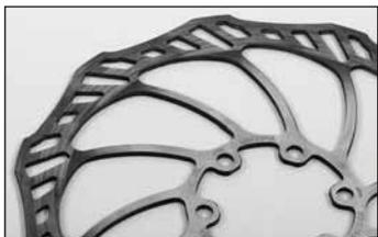
Auch Bremsscheiben verschleifen durch die Reibung der Bremsbeläge. MAGURA Scheibenbremsen besitzen einen vollautomatischen Verschleißausgleich. Dieser sorgt dafür, dass der Druckpunkt stets gleich positioniert ist. Darum muss der Verschleiß der Bremsscheiben bei jedem Belagswechsel überprüft werden. Verschlissene Bremsscheiben müssen gegebenenfalls gegen Original-Ersatzteile ausgetauscht werden. Tauschen Sie mit jeder Bremsscheibe auch die Beläge aus.
