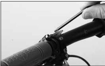
◀ Lösen Sie die untere Bremsgriff-Haltemutter um 1 bis 2 Umdrehungen.
