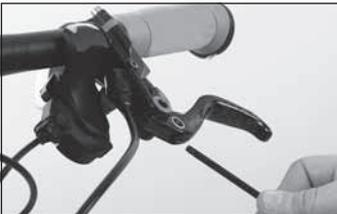
◀ Verschieben Sie den Bremsgriff auf dem Lenker so, dass ein oder zwei Finger (je nach Ihren Vorlieben) am Ende des Bremshebels aufliegen. Passen Sie gegebenenfalls die Position der Schaltgriffe so an, dass Sie diese gut erreichen.
