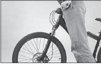
9. Sind die Reifen in gutem Zustand und haben beide Reifen genügend Druck? Die Angaben über Mindest- und Maximaldruck (in bar oder PSI) finden Sie seitlich auf der Reifenflanke.
