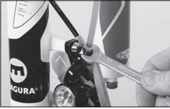
◀ Drehen Sie den Befüllstutzen aus der Befüllöffnung an der Bremszange.
