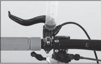
Im Gegensatz zu DOT-Bremsflüssigkeit ist das von MAGURA verwendete Mineralöl auch nicht hygroskopisch – d.h. es neigt nicht dazu, Feuchtigkeit aus der Umgebung anzuziehen und dadurch seine Siedetemperatur dramatisch herabzusetzen. Daher muss das Mineralöl in MAGURA Scheibenbremsen nicht regelmäßig gewechselt werden. Es kann über Jahre hinweg verwendet werden, ohne dass Sie sich Sorgen über Ihre Sicherheit machen müssen.
