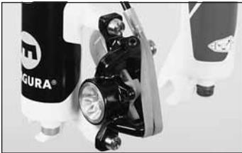
◀ Richten Sie das Fahrrad im Montageständer so aus, dass die PM-Ösen der Bremszange genau senkrecht übereinander stehen. Dann befindet sich der Leitungsanschluss am höchsten Punkt der Bremszange. **Nur so ist eine luftfreie Befüllung bzw. ein vollständiges Entlüften der Bremszange möglich!**
