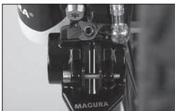
Wenn die Bremskolben an der Bremszange unterschiedlich weit ausfahren, wandert in der Regel der Druckpunkt näher zum Lenker und es entstehen Schleifgeräusche. Durch das „Mobilisieren“ der Nehmerkolben kann dieses Problem behoben werden. Die Bremsbeläge zentrieren sich wieder mittig zur Bremsscheibe und Schleifgeräusche werden dauerhaft vermieden.
