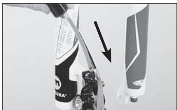
◀ Drücken Sie mit der unteren Befüllspritze vorsichtig noch etwas Mineralöl ins Bremssystem, bis die EBT-Belüftungsbohrung am Bremsgriff randvoll ist.
