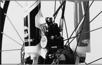
◀ Drücken Sie die Bremsbeläge in der Bremszange mit Hilfe der Transportsicherung oder dem Schraubendreher auseinander und setzen Sie die Bremszange auf die PM-Sockel an Rahmen oder Gabel bzw. auf den Bremszangen-Adapter. Achten Sie dabei darauf, dass die Bremsscheibe korrekt zwischen den Bremsbelägen sitzt. Drehen Sie die Bremszangen-Halteschrauben nur so weit an, dass sich die Bremszange von Hand noch seitlich bewegen lässt.
