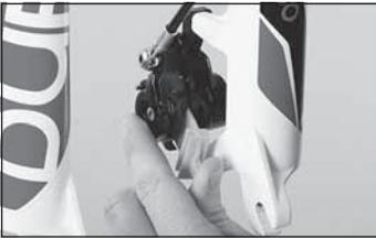
◀ Schieben Sie die mitgelieferte Transportsicherung immer in die Bremszange, wenn die Laufräder demontiert sind.
