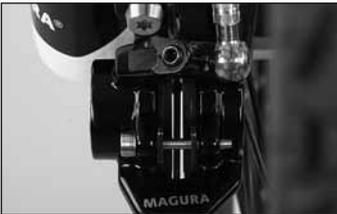
◀ Lassen Sie den Bremshebel los und überprüfen Sie die Ausrichtung der Bremszange zur Bremsscheibe. Wenn die Bremsscheibe nicht mittig im Bremszangen-Schlitz positioniert ist, wiederholen Sie den Montagevorgang.
