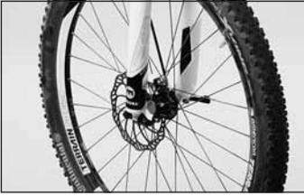
◀ Bauen Sie das Laufrad mit montierter Bremsscheibe in Rahmen oder Gabel ein und schließen Sie dessen Schnellspanner bzw. Steckachse entsprechend den Vorgaben der jeweiligen Hersteller. Prüfen Sie abschließend, ob die Felgen mittig im Rahmen bzw. in der Gabel stehen und die Reifen schleiffrei sind.
