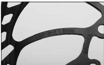
8. Überprüfen Sie die Dicke der Bremsscheiben. Die Mindestdicke ist auf den Bremsscheiben aufgedruckt. Sie darf auf dem gesamten Reifring nicht unterschritten werden. Ist dies doch der Fall, muss die Bremsscheibe umgehend ausgetauscht werden.
