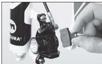
◀ Nehmen Sie die Bremsbeläge einzeln nach oben aus der Bremszange.
