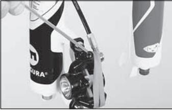
◀ Drehen Sie die Befüllschraube an der Bremszange mit dem 3-mm-Innensechskantschlüssel heraus.
