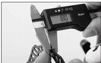
◀ Überprüfen Sie die Dicke der Bremsscheibe mit einem Messschieber. Wenn Sie über kein geeignetes Werkzeug verfügen, wenden Sie sich an Ihren MAGURA Fachhändler.
