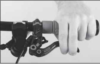
Konstantes Bremsen ohne Unterbrechung, insbesondere mit einer Bremse, kann zum Nachlassen der Bremswirkung bis hin zum Ausfall der Bremse in Extremsituationen führen.
