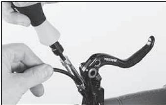
◀ Drehen Sie mit dem 8-mm-Gabelschlüssel fest.
