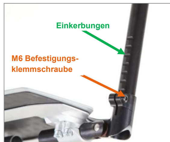
Abbildung 111: Einkerbungen und M6 Befestigungsschraube zur Unterschenkellängen-Einstellung (Ansicht von hinten)
