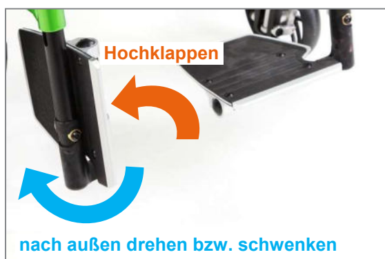
Abbildung 113: Ein Fußstützenteil hochgeklappt, Möglichkeit des nach außen Schwenkens eingezeichnet
