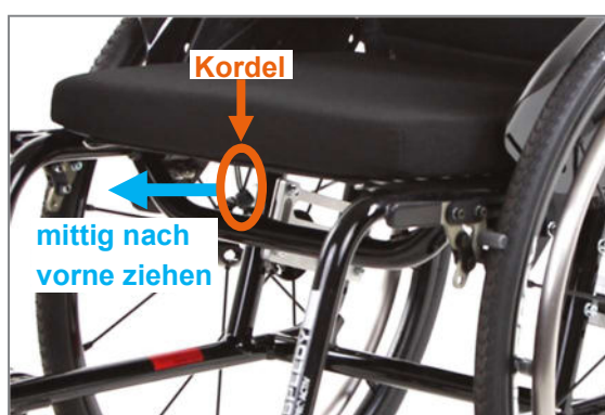
Abbildung 54: Kordel für die Betätigung der Rastbolzen
