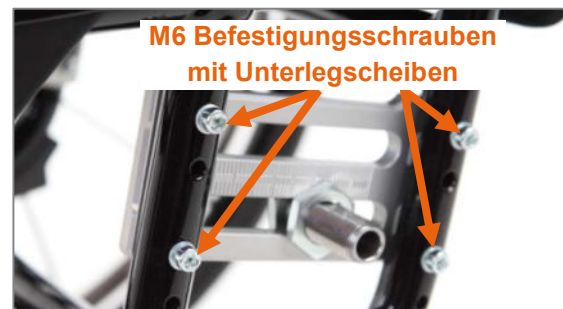
Abbildung 7: M6 Befestigungsschrauben der Radplatte
