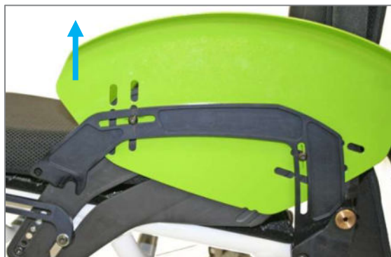
Abbildung 55: Kleiderschutz vorne aus der Seitenblechführung gezogen (Ansicht ohne Antriebsrad)
