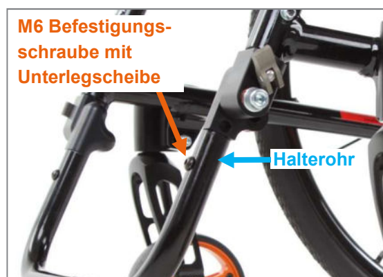
Abbildung 107: M6 Befestigungsschraube mit Unterlegscheibe zur Einstellung der Unterschenkelänge
