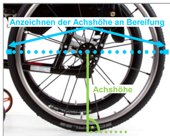
Abbildung 68: Anzeichnen der Achshöhe vorne und hinten auf beiden Reifen
