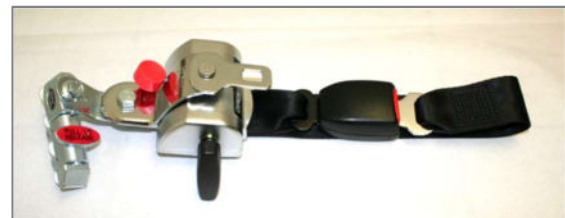
Abbildung 149: Retraktor hinten „Semi-Automatik“ mit Handrad, Gurtschloss und Schlosszunge
