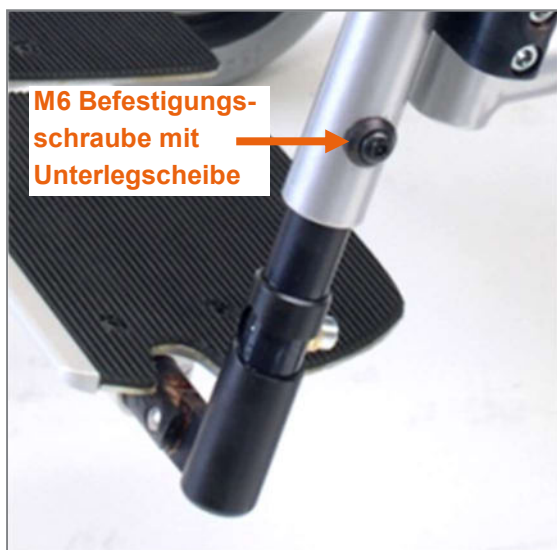
Abbildung 119: M6 Befestigungsschraube mit Unterlegscheibe zur Einstellung der Unterschenkellänge
