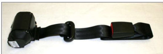
Abbildung 151: Schulterschräggurt automatisch mit Umlenkung und Gurtschloss
