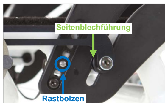
Abbildung 51: Rastbolzen greift in das Arretierungsloch im Seitenteil (Ansicht ohne Kleiderschutz)
