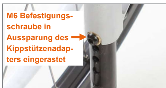
Abbildung 124: Kippstütze ordnungsgemäß eingerastet
