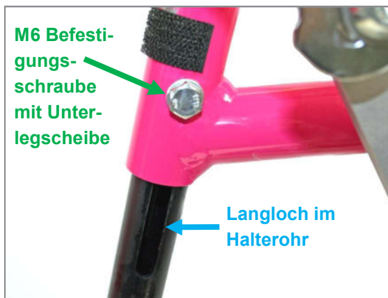
Abbildung 102: M6 Befestigungsschraube mit Unterlegscheibe und Langloch im Fußstützen-Halterohr zur Einstellung der Unterschenkelänge
