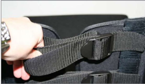
Abbildung 31: Spannöse leicht an Rückensystem angelegt
