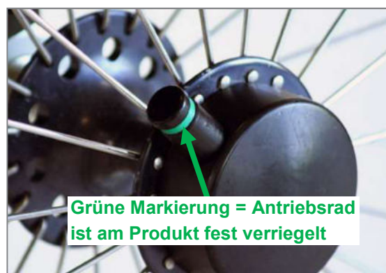
Abbildung 65: Tetra-Clip mit verriegelter Steckachse
