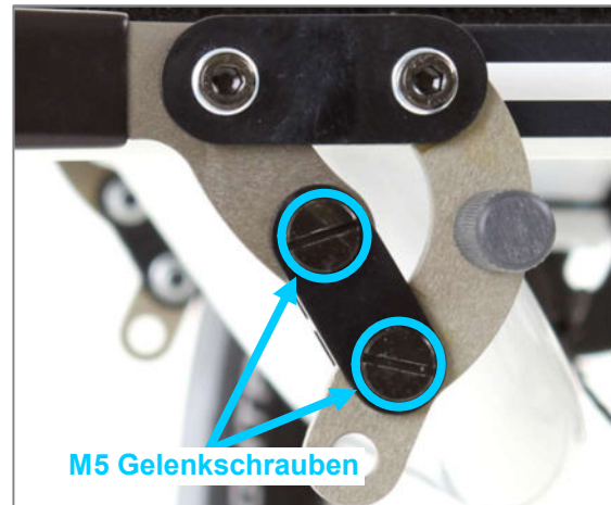
Abbildung 136: M5 Gelenkschrauben zur Einstellung der Betätigungskraft des Bremshebels
