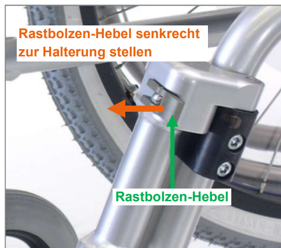
Abbildung 117: Rastbolzen-Hebel zur Abnahme der Swing away Fußstütze senkrecht stellen
