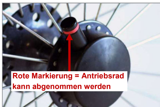
Abbildung 66: Tetra-Clip mit geöffneter Steckachse, Antriebsrad kann abgenommen werden
