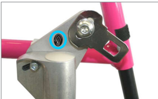
Abbildung 156: Lenkradlagerblockzwischenplatte mit Schlosszunge für Retraktor vorne
