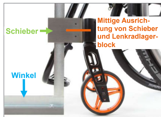
Abbildung 90: Überprüfung der Einstellung der Lenkradgabel-drehachsen
