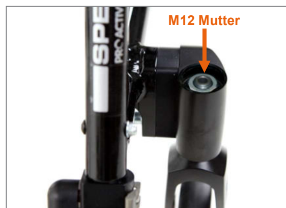
Abbildung 88: Alu-Kappe abgenommen und M12 Mutter sichtbar
