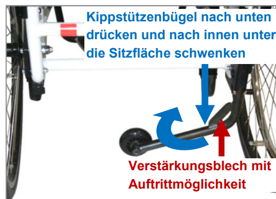
Abbildung 125: Kippstütze in Passivstellung bringen (Ansicht von hinten)
