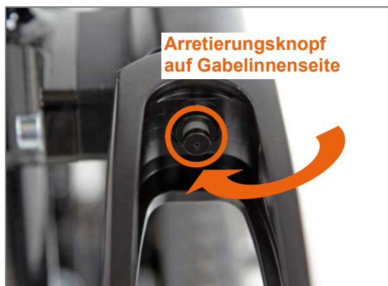
Abbildung 89: Lenkradgabel mit Steckachse und Arretierungsknopf
