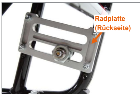
Abbildung 2: 2-Schlitz-Radplatte zur Sitzhöhenverstellung hinten (Ansicht von Produktinnenseite, Antriebsrad abgenommen)
