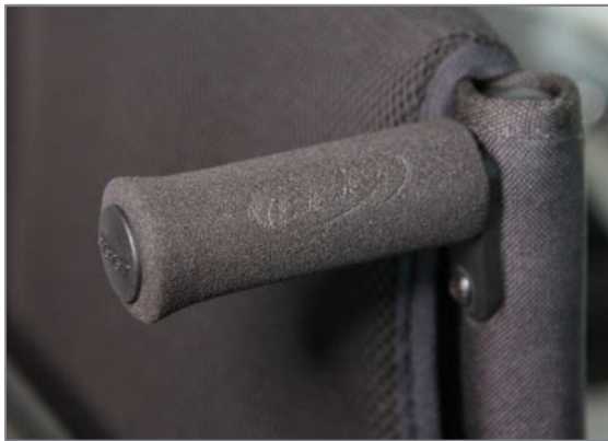
Abbildung 142: Schiebegriffe horizontal im Rückenrohr eingeschraubt
