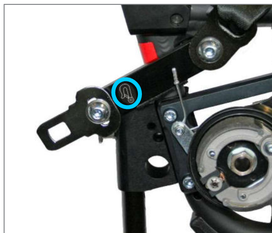
Abbildung 154: Kraftknotenverbindung am hinteren Rahmen mit Schlosszunge für Retraktor hinten und Beckengurt
