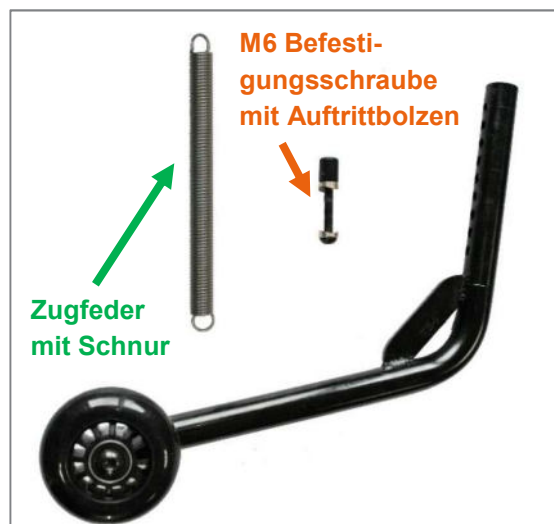
Abbildung 128: M6 Befestigungsschraube und Zugfeder aus Kippstützenbügel entnommen
