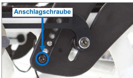
Abbildung 23: Anschlagschraube (Ansicht von Produktaußenseite)
