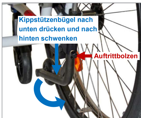
Abbildung 123: Kippstütze in Betriebsstellung bringen (Ansicht von hinten)
