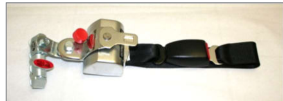
Abbildung 148: Retraktor vorne „Semi-Automatik“ mit Gurtschloss und Schlosszunge
