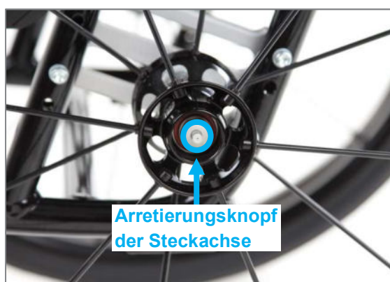
Abbildung 62: Arretierungsknopf der Steckachse in der Mitte der Radachse
