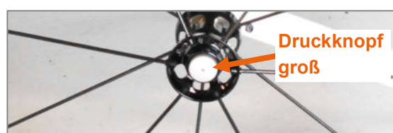
Abbildung 64: Steckachse mit Bedienungsunterstützung, Druckknopf groß
