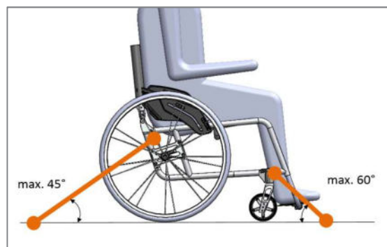
Abbildung 162: Verlauf der Retraktoren vorne und hinten mit maximalem Abspannwinkel und Anbindepunkten (Ansicht von der Seite)
