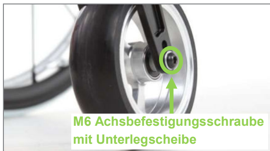
Abbildung 81: M6 Achsbefestigungsschraube der Lenkradachse (Ansicht von Produktaußenseite)
