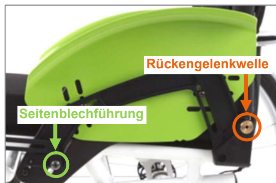
Abbildung 50: Kleiderschutz am Produkt angebracht (Ansicht ohne Antriebsrad)
