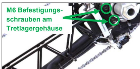
Abbildung 13: M6 Befestigungsschrauben am Tretlagergehäuse
