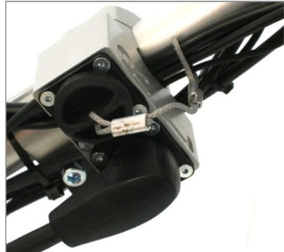
Abbildung 35: Linker Akku angeschlossen; Magnetstecker in Buchse „L“
