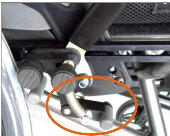
Abbildung 2: Rückrollsicherung
