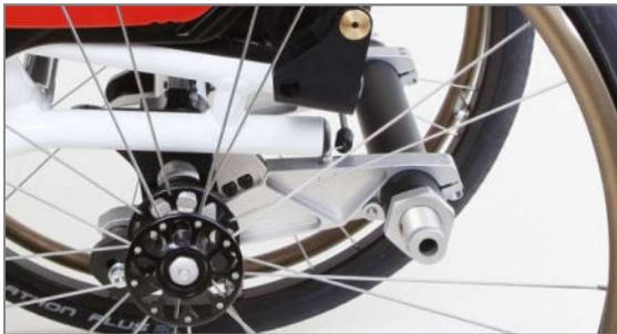
Abbildung 1: Abnehmbare Radstandsverlängerung
