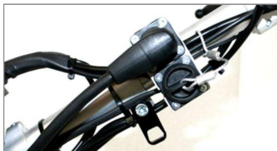
Abbildung 31: Umsteckvorrichtung an der Lenksäule
