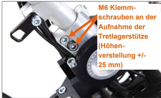
Abbildung 15: M6 Klemmschrauben für die Höhenverstellung der Tretlagerposition
