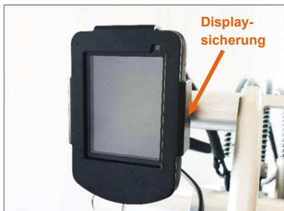
Abbildung 39: Display mit Displaysicherung
