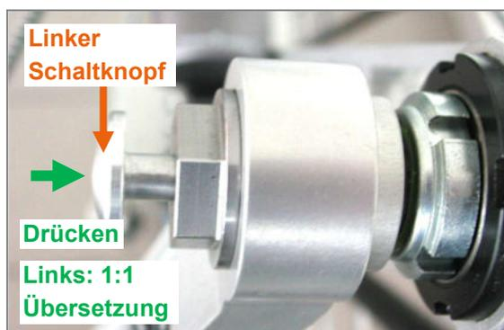
Abbildung 23: Linker Schaltknopf der Tretlagerschaltung
