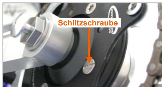
Abbildung 24: Schlitzschraube zum Fetten
