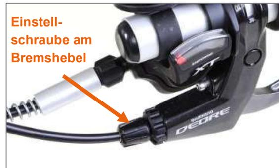
Abbildung 27: Einstellschraube am Bremshebel
