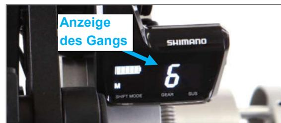
Abbildung 21: Anzeige des aktuellen Gangs im Display
