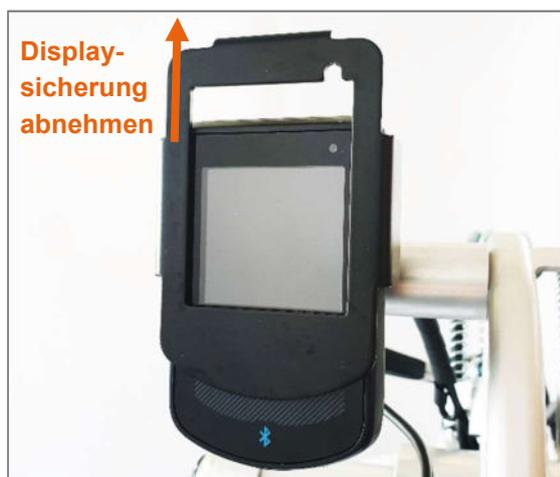
Abbildung 40: Abnahme Displaysicherung
