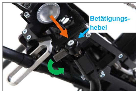
Abbildung 6: Nach unten Drücken und Drehen des Betätigungshebels
