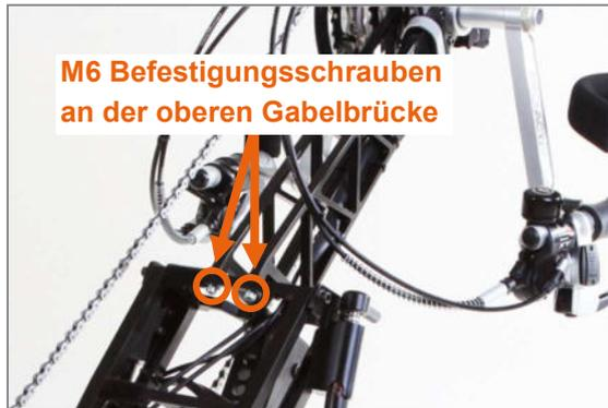
Abbildung 12: M6 Befestigungsschrauben an der oberen Gabelbrücke
