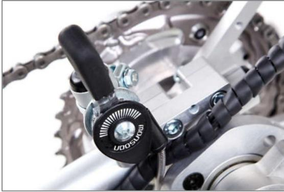
Abbildung 29: Feststellbremse über Rasthebel
