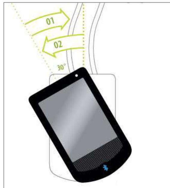
Abbildung 38: Anbringung und Abnahme des Displays
