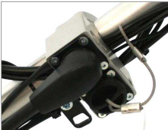
Abbildung 34: Rechter Akku angeschlossen; Magnetstecker in Buchse „R“
