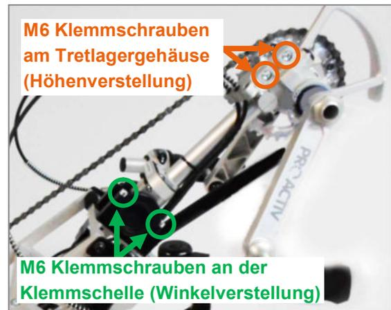
Abbildung 14: M6 Klemmschrauben für Winkel- und Höhenverstellung der Tretlagerposition
