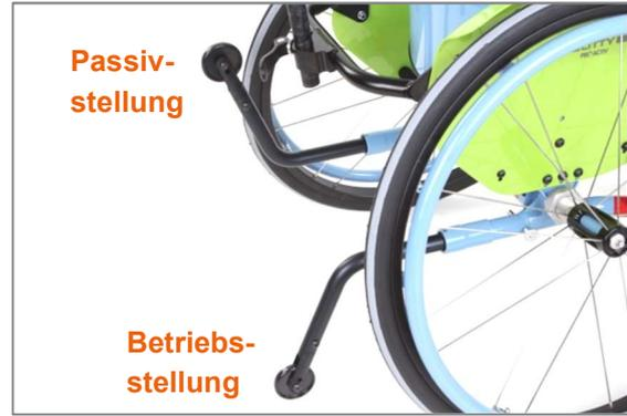
Abbildung 51: Betriebs- und Passivstellung der Kippstützen
