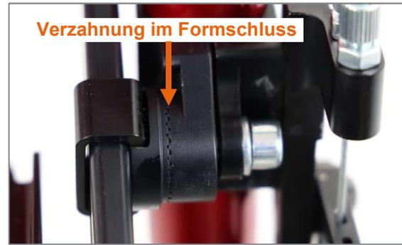
Abbildung 16: Verzahnung am Fußbügelspanner, im Formschluss
