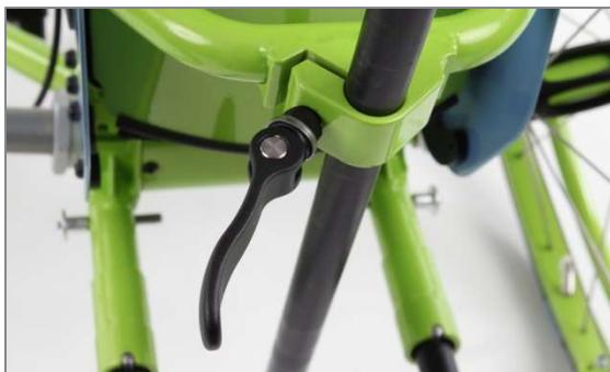
Abbildung 67: Geöffneter Schnellspannhebel
