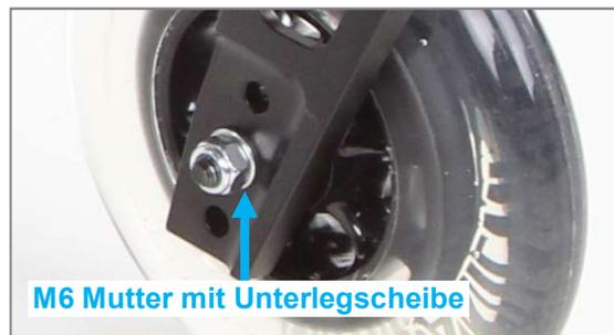
Abbildung 42: M6 Mutter der Lenkradachse (Ansicht von Produktinnenseite)
