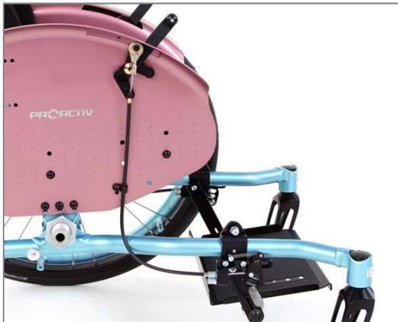
Abbildung 60: Kniehebelbremssystem mit Bremsbedienung oben im Kleiderschutz integriert
