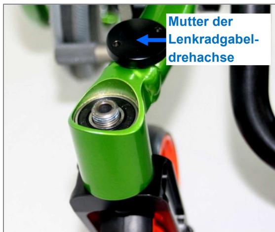
Abbildung 47: Mutter der Lenkradgabel-drehachse vollständig entfernt
