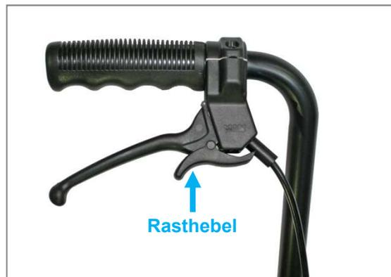
Abbildung 65: Bremsgriff an der Schiebevorrichtung
