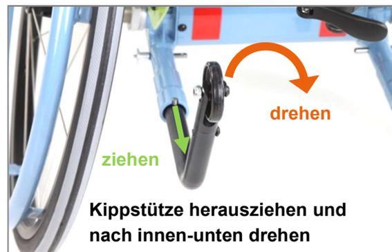
Abbildung 53: Kippstütze von Passiv- in Betriebsstellung bringen (Ansicht von hinten)
