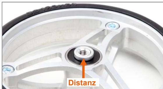
Abbildung 40: Distanz am Lenkrad
