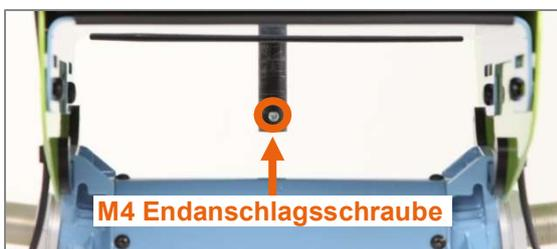
Abbildung 68: M4 Endanschlagsschraube am Zentral-Schiebegriff unten angebracht
