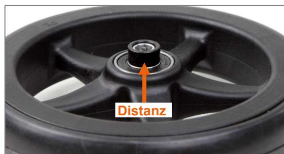
Abbildung 44: Distanz am Lenkrad
