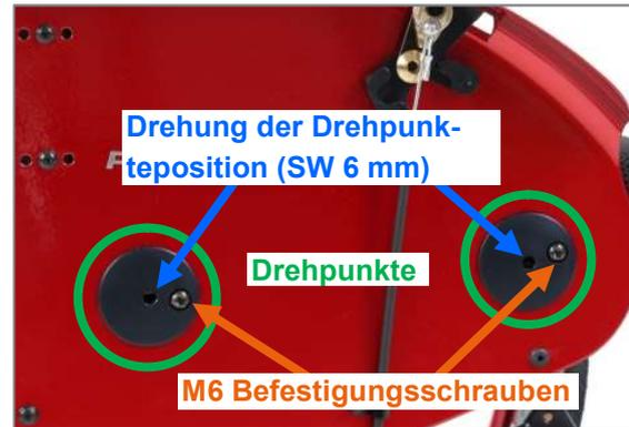
Abbildung 1: Verstellung der Sitzhöhen mithilfe der Drehpunkte
