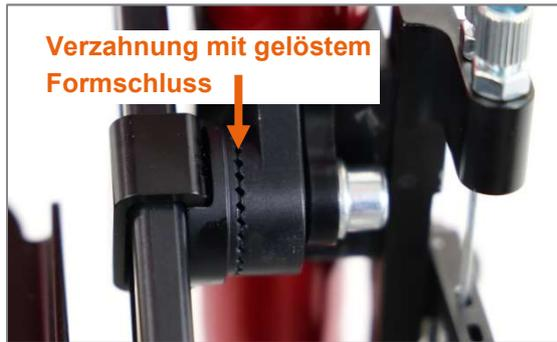
Abbildung 18: Verzahnung am Fußbügelspanner, gelöster Formschluss
