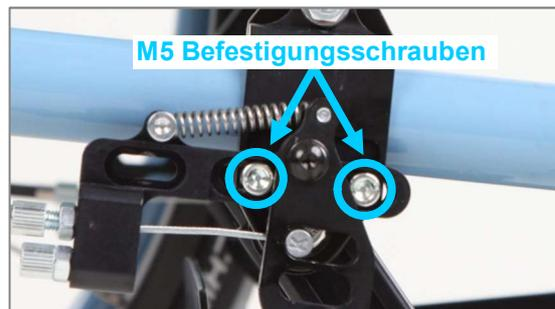
Abbildung 61: M5 Befestigungsschrauben
