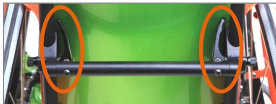
Abbildung 71: Geschlossene Schnellspannhebel
