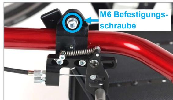
Abbildung 17: M6 Befestigungsschraube des Fußbügelspanners
