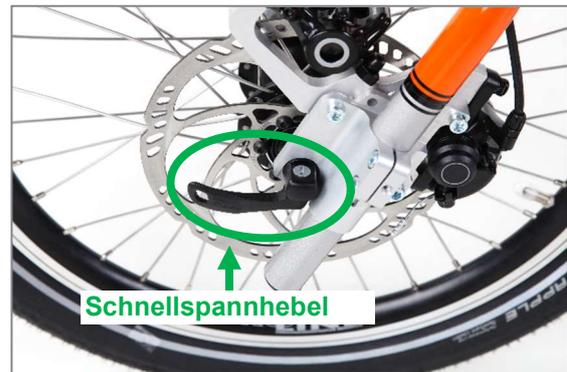
Abbildung 11: Schnellspannhebel beim FREEWAY trekking
