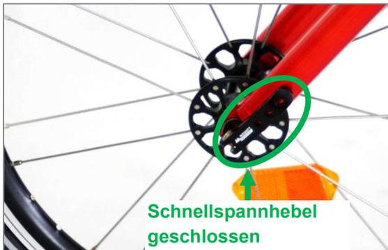
Abbildung 9: Schnellspannhebel handfest zugedreht und geschlossen
