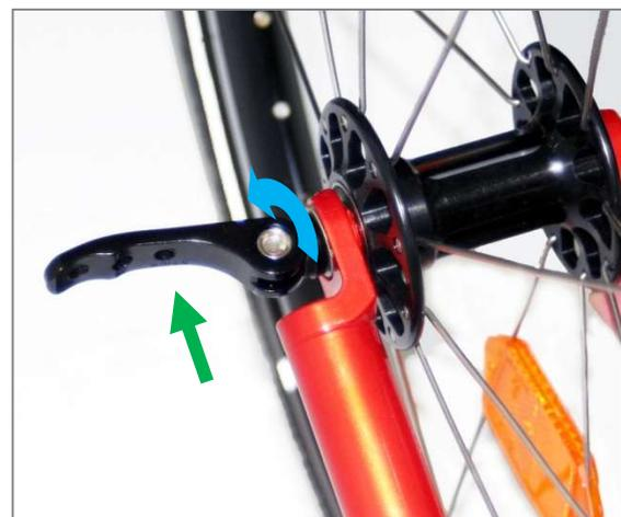
Abbildung 7: Schnellspannhebel öffnen und drehen
