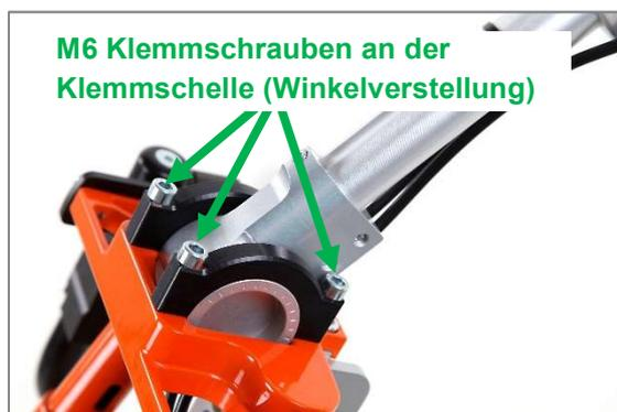
Abbildung 22: M6 Klemmschrauben für Winkelverstellung der Lenkerposition
