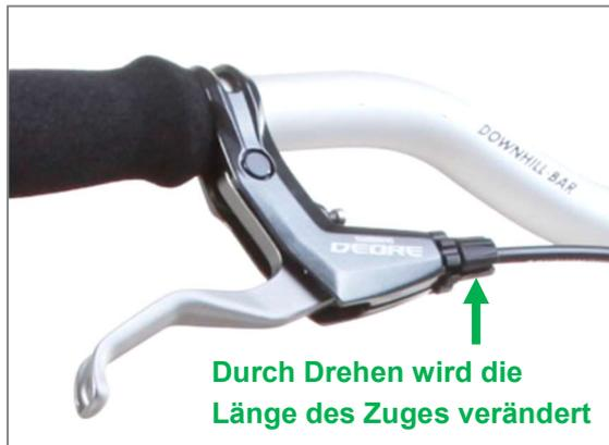
Abbildung 3: Bremshebel mit Verstellmöglichkeit der Zuglänge
