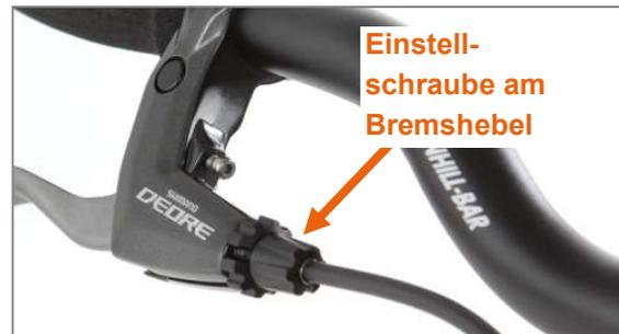
Abbildung 2: Einstellschraube am Bremshebel
