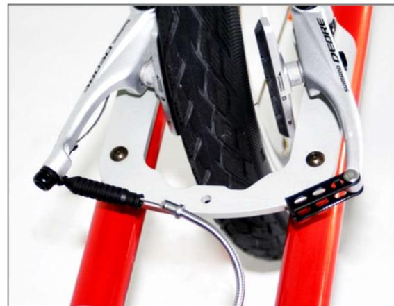
Abbildung 6: Bremse ausgehängt
