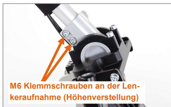
Abbildung 23: M6 Klemmschrauben für die Höhenverstellung der Lenkerposition
