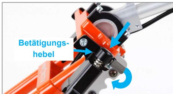
Abbildung 16: Nach unten Drücken und Drehen des Betätigungshebels
