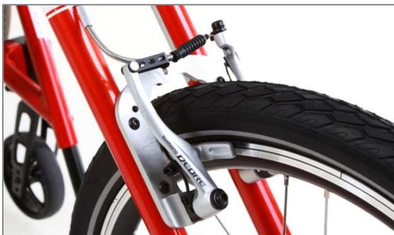
Abbildung 10: Felgenbremse eingehängt und Zuglänge richtig eingestellt
