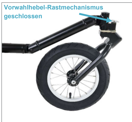
Abbildung 18: Rad in arretierter Position; Vorwahlhebel-Rastmechanismus geschlossen
