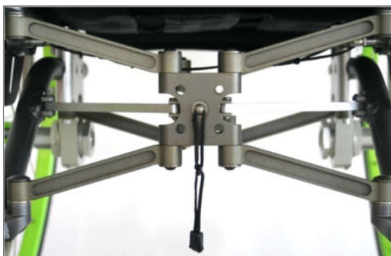
Abbildung 15: Position Auslöseschnur richtig, Bohrungen für Zentrierstifte frei
