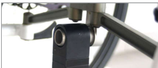
Abbildung 10: Zentrierzapfen mit aufgesteckter Zentrierzapfenaufnahme
