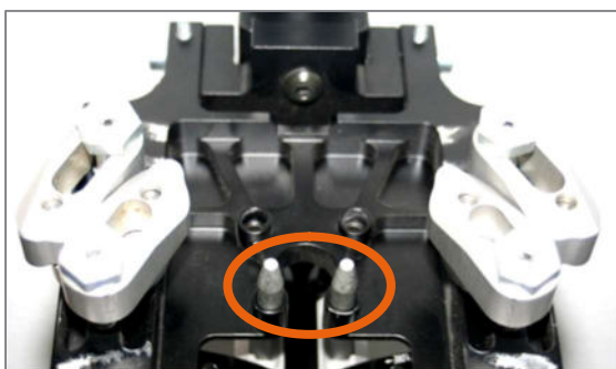
Abbildung 30: Zentrierstifte montiert für schmales Mittelteil
