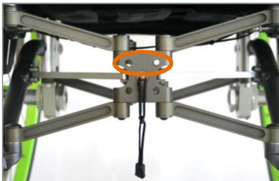
Abbildung 11: Bohrungen für Zentrierstifte
