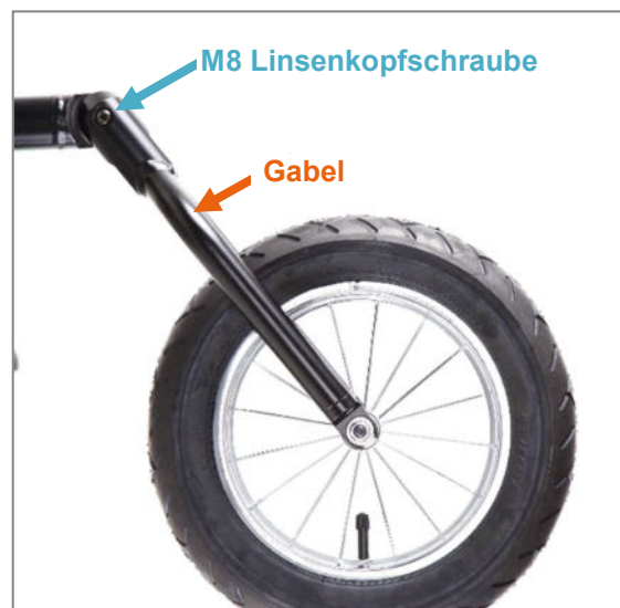
Abbildung 19: Outdoor-Radvorsatz mit starrer Gabel
