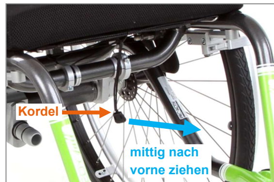
Abbildung 20: Kordel für die Betätigung der Rastbolzen und damit zur Verstellung des Rückenlehnenwinkels
