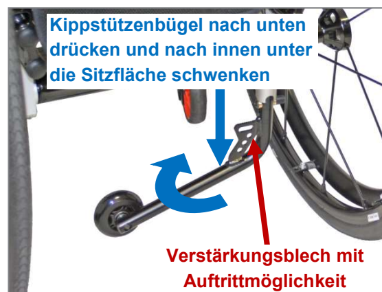
Abbildung 142: Kippstütze in Passivstellung bringen (Ansicht von hinten)
