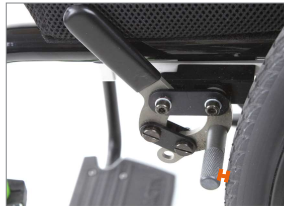
Abbildung 159: Abstand zwischen Bremsbolzen und Bereifung ca. 3 bis maximal 4 mm bei geöffneter Bremse
