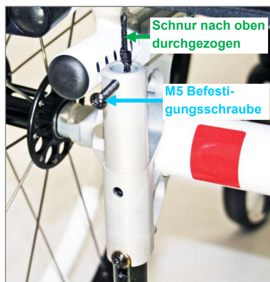
Abbildung 145: Federhaltedom auf Kippstützenadapter aufgesetzt, Schnur nach oben durchgezogen und M5 Befestigungsschraube angesetzt
