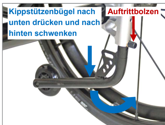
Abbildung 140: Kippstütze in Betriebsstellung bringen (Ansicht von hinten)
