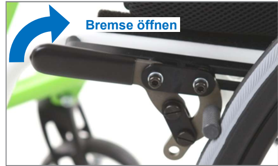
Abbildung 153: Bremse geschlossen; Öffnen erfolgt durch nach hinten-oben Ziehen des Bremshebels
