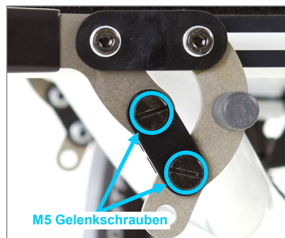
Abbildung 156: M5 Gelenkschrauben zur Einstellung der Betätigungskraft des Bremshebels
