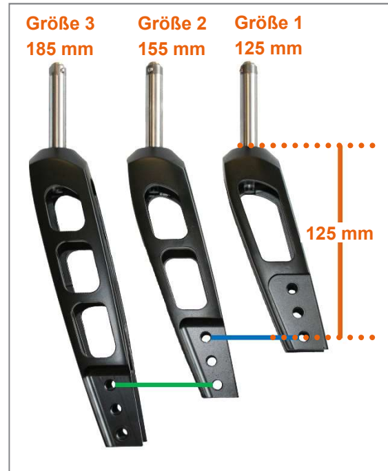
Abbildung 8: Lenkradgabelgrößen mit Kennzeichnung der gleichen Sitzhöhereinstellungen bei verschiedenen Lenkradgabelgrößen
