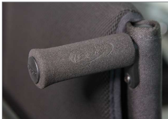
Abbildung 184: Schiebegriffe horizontal im Rückenrohr eingeschraubt
