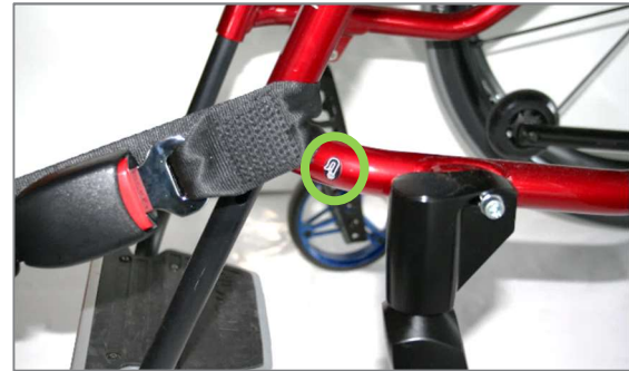
Abbildung 209: Symbol für vordere Befestigung und Umschlaufung des Rollstuhls vorne (Beispiel SPEEDY 4you Ergo)
