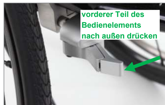
Abbildung 163: Integralbremse geöffnet; Schließen erfolgt durch nach außen Drücken des Bedienelements
