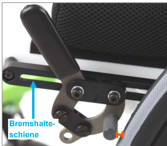
Abbildung 155: Abstand zwischen Bremsbolzen und Bereifung von ca. 3 bis maximal 4 mm bei geöffneter Bremse
