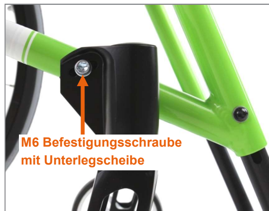
Abbildung 109: M6 Befestigungsschraube an der Produktaußenseite
