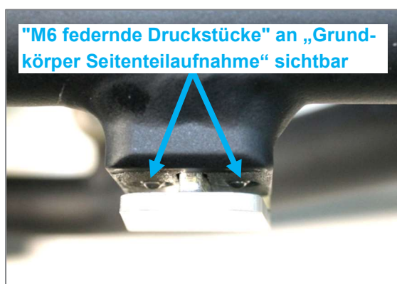
Abbildung 70: Vorderseite der federnden Druckstücke sichtbar (Ansicht von oben)
