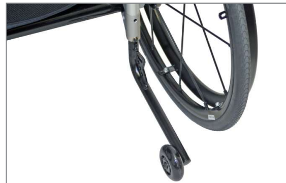
Abbildung 138: Betriebsstellung der Kippstütze (Ansicht von hinten)
