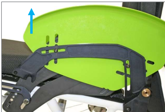
Abbildung 58: Kleiderschutz vorne aus der Seitenblechführung gezogen (Ansicht ohne Antriebsrad)
