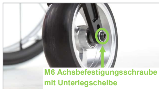
Abbildung 97: M6 Achsbefestigungsschraube der Lenkradachse (Ansicht von Produktaußenseite)
