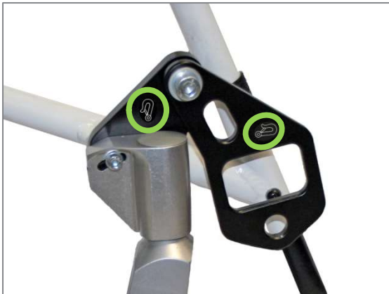
Abbildung 208: Lenkradlagerblockzwischenplatte mit Gurtöse für Retraktor vorne
