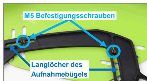
Abbildung 63: M5 Befestigungsschrauben und Langlöcher des Aufnahmebügels (SPEEDY 4all, -4you und -4teen)
