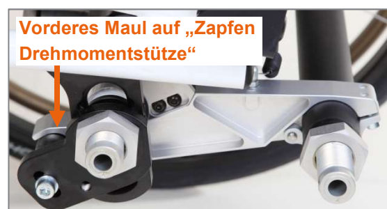
Abbildung 91: Radstandsverlängerung angebracht (Ansicht von der Produktaußenseite ohne Antriebsrad)
