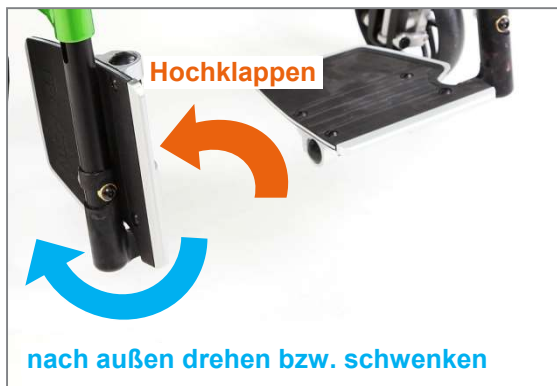
Abbildung 130: Ein Fußstützenteil hochgeklappt, Möglichkeit des nach außen Schwenkens eingezeichnet
