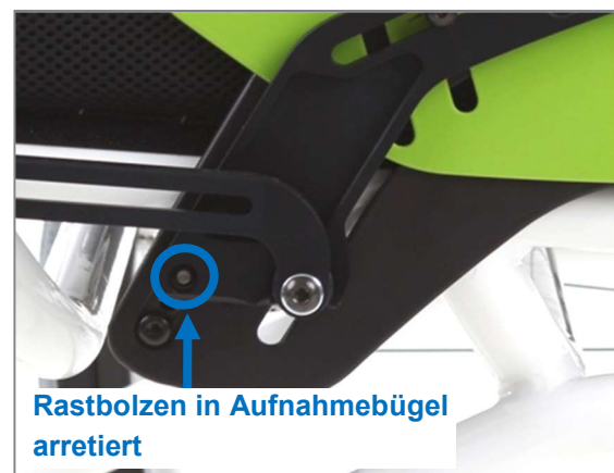
Abbildung 51: Rastbolzen in Aufnahmebügel des Kleiderschutzes arretiert (Ansicht mit Kleiderschutz)
