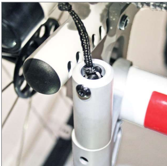
Abbildung 147: M5 Befestigungsschraube durch die Abschlussöse der Zugfeder geschraubt
