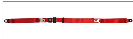
Abbildung 200: Beckengurt mit Gurtschloss, den Befestigungsbeschlägen zur Anbindung an die Kraftknoten und zwei Schlosszungen zur wahlweisen Befestigung des Schulterschräggurtes
