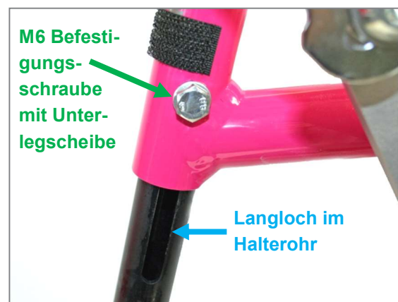
Abbildung 119: M6 Befestigungsschraube mit Unterlegscheibe und Langloch im Fußstützen-Halterohr zur Einstellung der Unterschenkellänge
