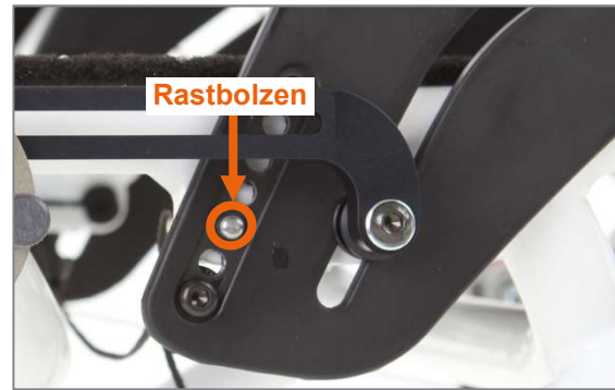
Abbildung 19: Rastbolzen greift in das Arretierungsloch im Seitenteil (Ansicht von Produktaußenseite, ohne Kleiderschutz)
