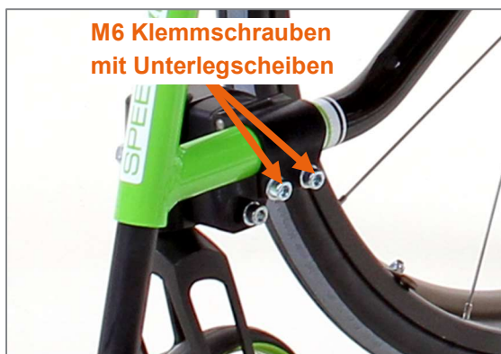
Abbildung 110: M6 Klemmschrauben beim geklemmten Lenkradlagerblock
