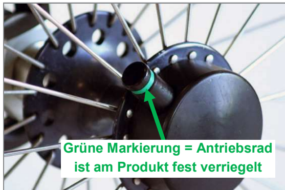
Abbildung 77: Tetra-Clip mit verriegelter Steckachse
