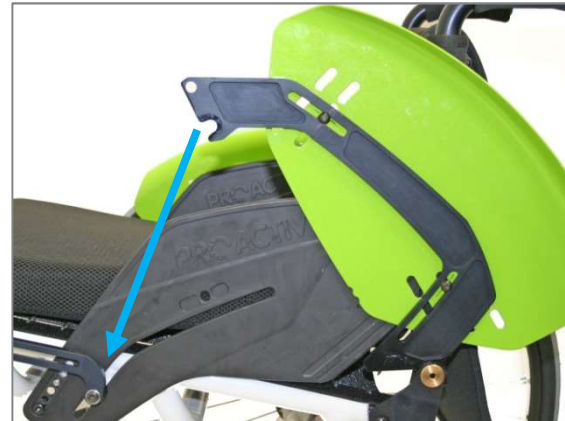
Abbildung 59: Aufnahmebügel auf Rückgelenkwelle aufgesteckt (Ansicht ohne Antriebsrad)
