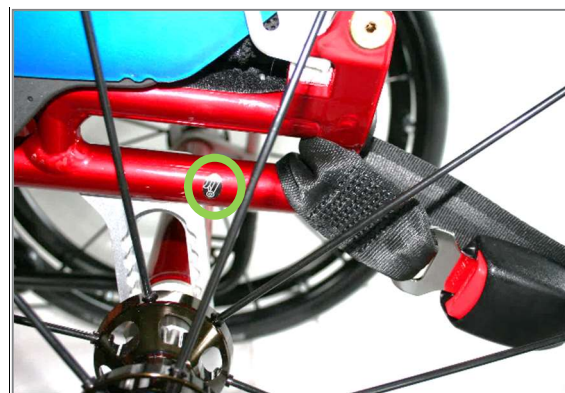
Abbildung 210: Symbol für hintere Befestigung und Umschlaufung des Rollstuhls hinten (Beispiel SPEEDY 4you Ergo)
