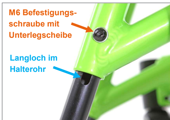
Abbildung 113: M6 Befestigungsschraube mit Unterlegscheibe und Langloch im Fußstützen-Halterohr zur Einstellung der Unterschenkellänge
