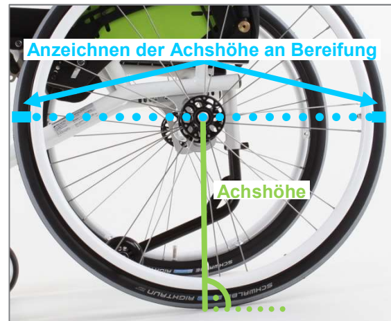
Abbildung 79: Anzeichnen der Achshöhe vorne und hinten auf beiden Reifen
