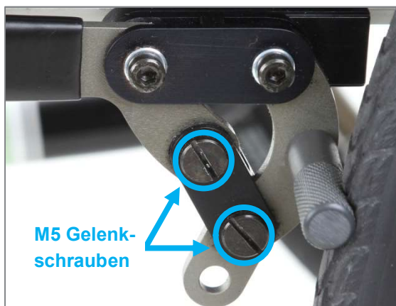
Abbildung 160: M5 Gelenkschrauben zur Einstellung der Betätigungskraft des Bremshebels
