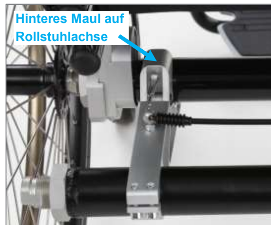
Abbildung 92: Radstandsverlängerung angebracht (Ansicht von hinten)
