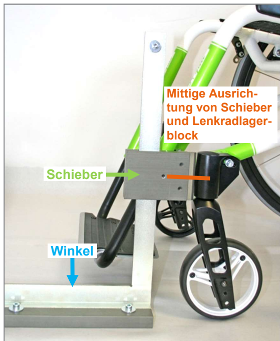
Abbildung 106: Überprüfung der Einstellung der Lenkradgabeldehachsen
