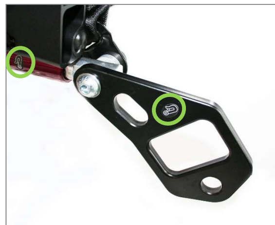
Abbildung 206: Kraftknotenbindung am hinteren Rahmen mit Gurtöse für Retraktor hinten und Beckengurt
