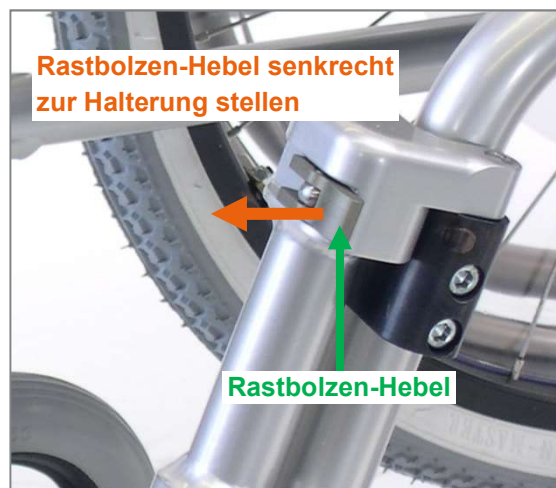
Abbildung 134: Rastbolzen-Hebel zur Abnahme der Swing away Fußstütze senkrecht stellen
