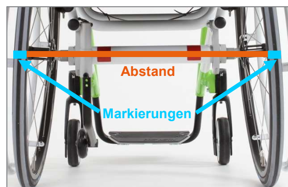
Abbildung 80: Abstand zwischen den Markierungen der Reifen (auf Achshöhe), hinten
