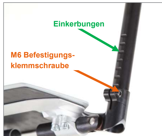
Abbildung 128: Einkerbungen und M6 Befestigungsklemmschraube zur Unterschenkellängen-Einstellung (Ansicht von hinten)
