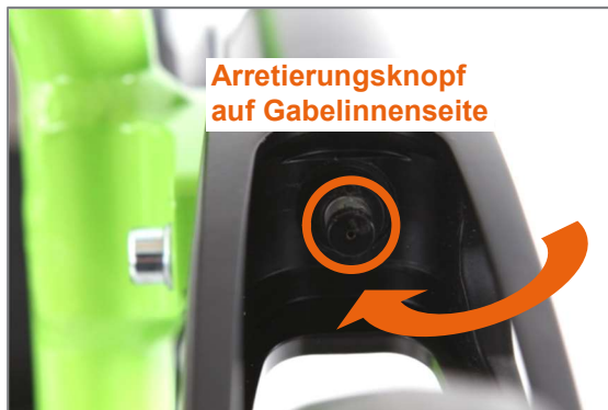
Abbildung 105: Lenkradgabel mit Steckachse und Arretierungsknopf
