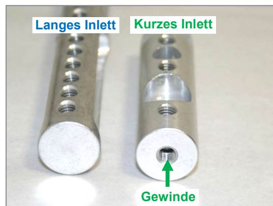
Abbildung 11: Langes Inlett ohne und kurzes Inlett mit Gewinde in der Stirnfläche
