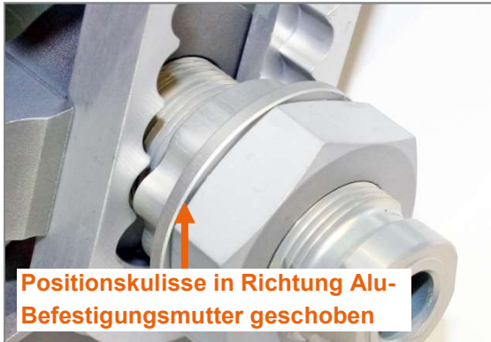
Abbildung 5: Alu-Befestigungsmutter gelöst und Positionskulisse in Richtung Alu-Befestigungsmutter geschoben (Ansicht von Produktaußenseite)
