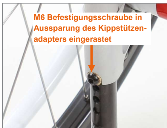
Abbildung 141: Kippstütze ordnungsgemäß eingerastet
