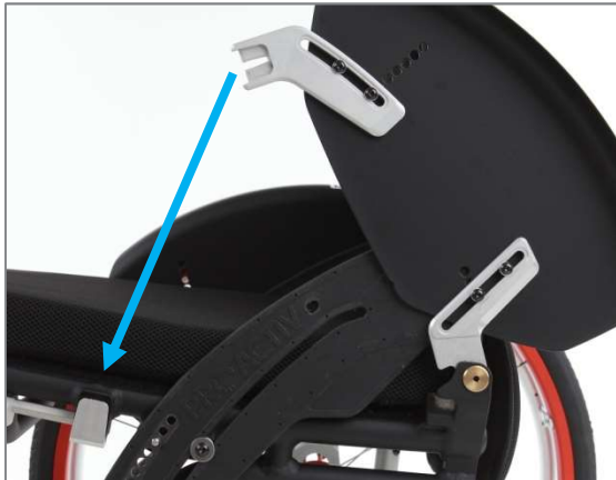
Abbildung 61: Hintere Seitenteilaufnahme auf Rückengelenkwelle aufgesteckt (Ansicht ohne Antriebsrad)
