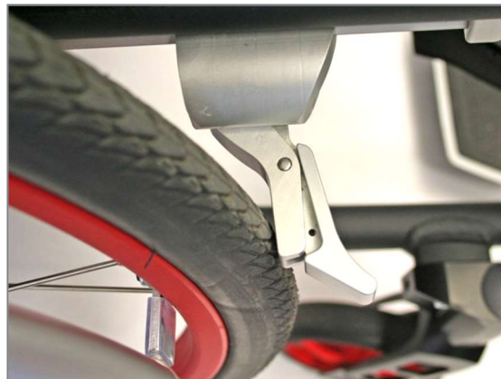
Abbildung 172: Bremsenelement an der Bereifung anliegend
