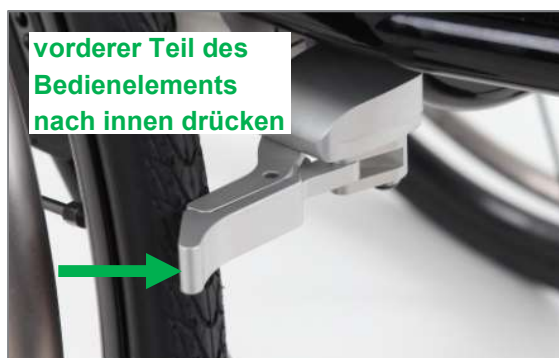
Abbildung 165: Integralbremse geschlossen; Öffnen erfolgt durch Drücken des Bedienelements zur Rollstuhlmitte
