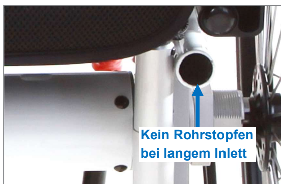
Abbildung 13: Kein Rohrstopfen am Rahmenende bedeutet "langes Inlett" (Ansicht von hinten)
