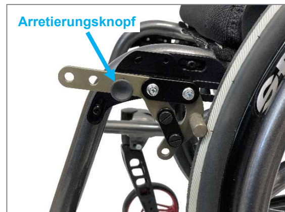
Abbildung 175: Kniehebelbremse mit Arretierung
