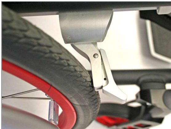
Abbildung 168: Bremsenelement an der Bereifung anliegend
