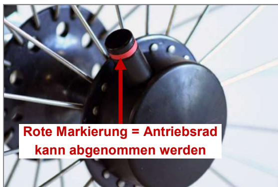
Abbildung 78: Tetra-Clip mit geöffneter Steckachse, Antriebsrad kann abgenommen werden
