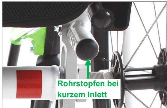
Abbildung 12: Rohrstopfen am Rahmenende bedeutet "kurzes Inlett" (Ansicht von hinten)
