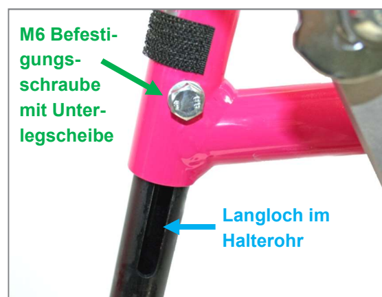
Abbildung 131: M6 Befestigungsschraube mit Unterslegscheibe und Langloch im Fußstützen-Halterohr zur Einstellung der Unterschenkellänge
