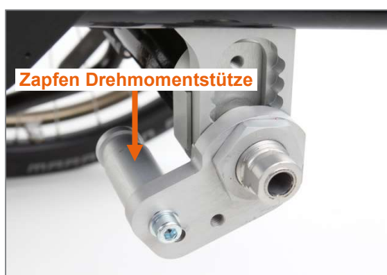
Abbildung 90: Zapfen Drehmomentstütze am Produkt montiert (Ansicht von der Produktaußenseite ohne Antriebsrad)
