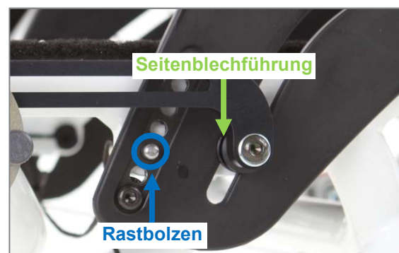
Abbildung 50: Rastbolzen greift in das Arretierungsloch im Seitenteil (Ansicht ohne Kleiderschutz)
