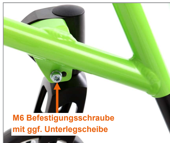
Abbildung 108: M6 Befestigungsschraube an der Rahmeninnenseite, Unterlegscheibe bei G-Form-Rahmen vorhanden, bei V-Form-Rahmen nicht
