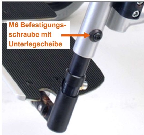
Abbildung 136: M6 Befestigungsschraube mit Unterlegscheibe zur Einstellung der Unterschenkel­länge
