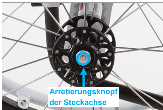
Abbildung 74: Arretierungsknopf der Steckachse in der Mitte der Radachse
