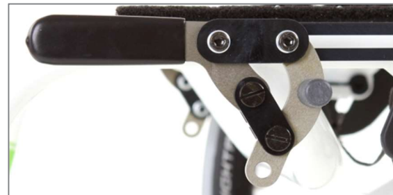
Abbildung 151: Kniehebelbremssystem mit Bremshebel Standard
