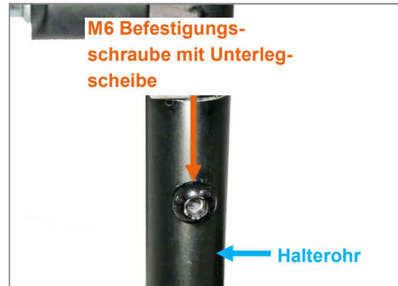
Abbildung 124: M6 Befestigungsschraube mit Unterlegscheibe zur Einstellung der Unterschenkellänge
