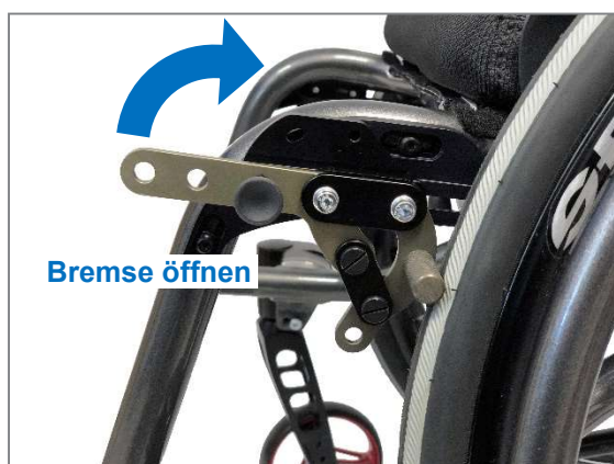
Abbildung 178: Bremse geschlossen; Öffnen erfolgt durch nach hinten-oben Ziehen des Bremshebels
