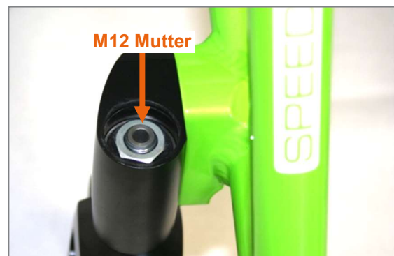
Abbildung 104: Alu-Kappe abgenommen und M12 Mutter sichtbar
