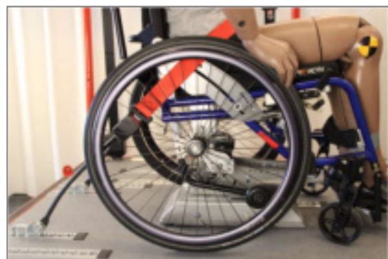
Abbildung 196: Sicherheitsgurte dürfen nicht durch Rollstuhlkomponenten wie Armlehnen oder Räder vom Körper ferngehalten werden
