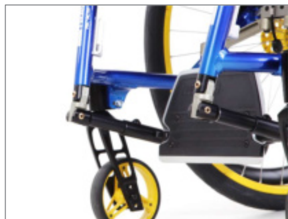
Abbildung 118: Fußstütze nach hinten hochfaltbar mit Federrastmechanismus, Position nach hinten hochgeklappt
