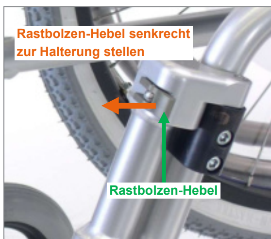
Abbildung 126: Rastbolzen-Hebel zur Abnahme der Swing away Fußstütze senkrecht stellen
