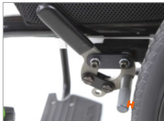
Abbildung 147: Abstand zwischen Bremsbolzen und Bereifung ca. 3 bis maximal 4 mm bei geöffneter Bremse
