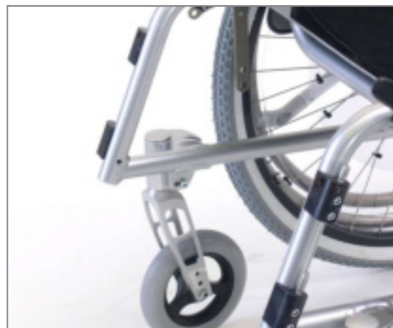
Abbildung 127: Swing away Fußstütze abgenommen
