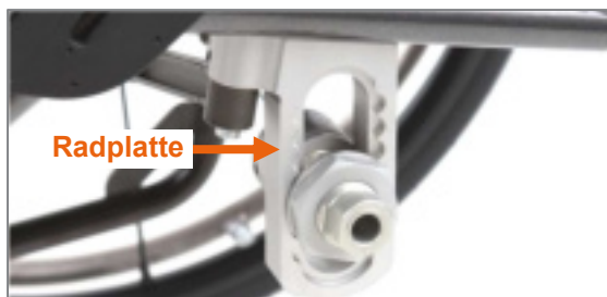
Abbildung 6: Radplatte zur Sitzhöhenverstellung hinten (Antriebsrad abgenommen)
