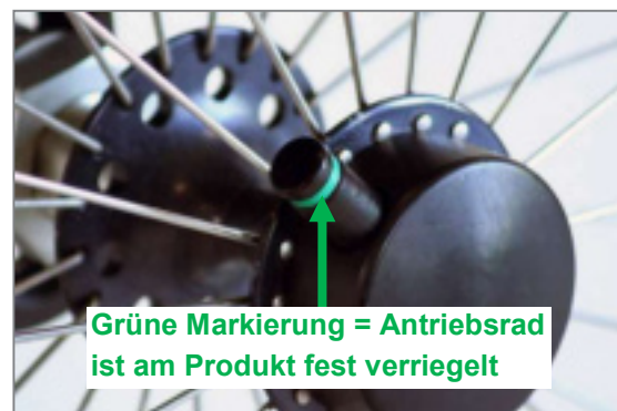
Abbildung 70: Tetra-Clip mit verriegelter Steckachse
