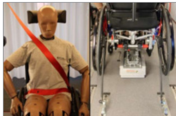
Abbildung 195: Die Rückhaltesysteme der Insassen sollten vollständigen Kontakt mit Schulter, Brust und Becken haben und die Beckengurte sollten tief am Becken im Oberschenkel-Bauch-Bereich positioniert sein
