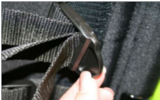
Abbildung 39: Schritt 5: Zurückführen des Gurtes durch die Spannöse um die geforderte "doppelte Durchführung" zu erhalten
