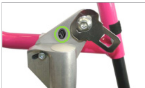
Abbildung 179: Lenkradlagerblockzwischenplatte mit Schlosszunge für Retraktor vorne
