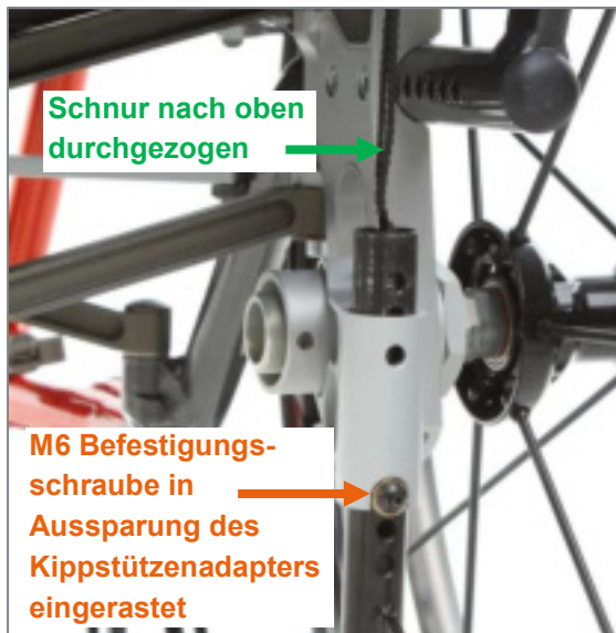
Abbildung 136: Kippstützenbügel in Kippstützenadapter eingesteckt
