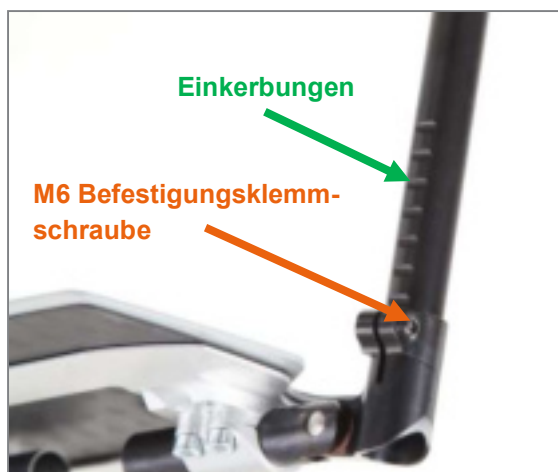
Abbildung 119: Einkerbungen und M6 Befestigungsklemmschraube zur Unterschenkelängen-Einstellung (Ansicht von hinten)
