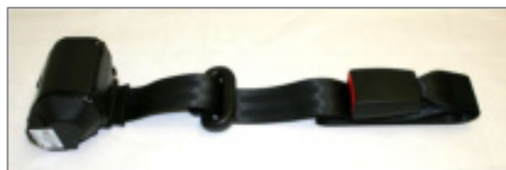
Abbildung 173: Schulterschräggurt automatisch mit Umlenkung und Gurtschloss
