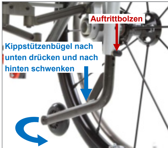
Abbildung 132: Kippstütze in Betriebsstellung bringen (Ansicht von hinten)
