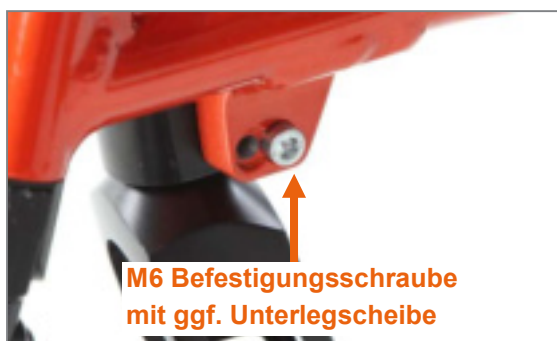
Abbildung 101: M6 Befestigungsschraube an der Rahmeninnenseite, Unterlegscheibe bei G-Form-Rahmen vorhanden, bei V-Form-Rahmen nicht
