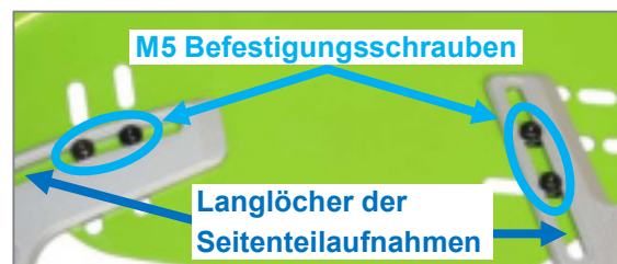
Abbildung 57: M5 Befestigungsschrauben und Langlöcher der Seitenteilaufnahmen
