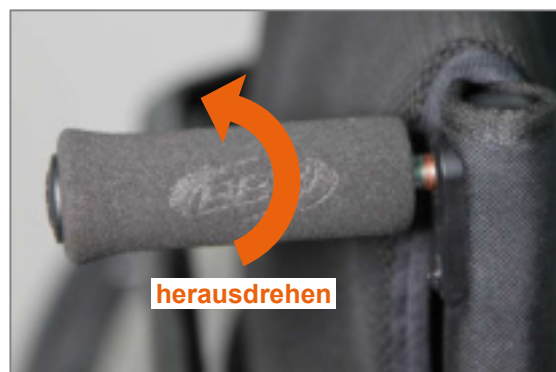
Abbildung 165: Schiebegriff horizontal aus dem Rückenrohr herausdrehen
