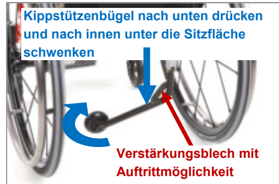
Abbildung 134: Kippstütze in Passivstellung bringen (Ansicht von hinten)
