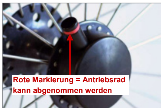
Abbildung 71: Tetra-Clip mit geöffneter Steckachse, Antriebsrad kann abgenommen werden
