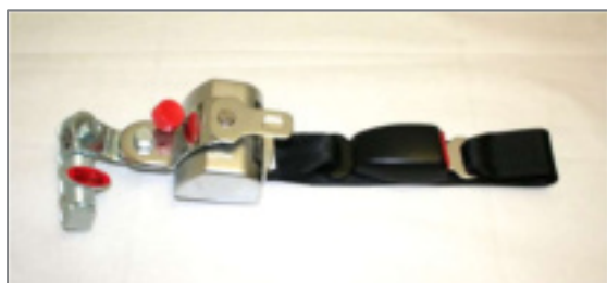
Abbildung 170: Retraktor vorne „Semi-Automatik“ mit Gurtschloss und Schlosszunge
