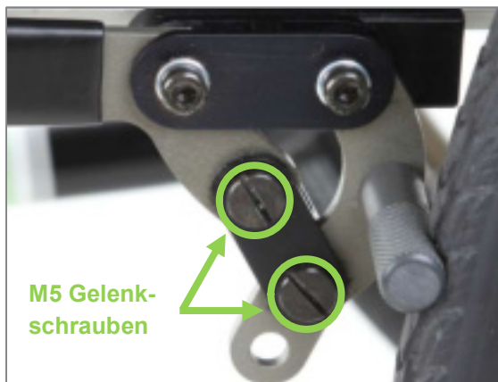
Abbildung 148: M5 Gelenkschrauben zur Einstellung der Betätigungskraft des Bremshebels
