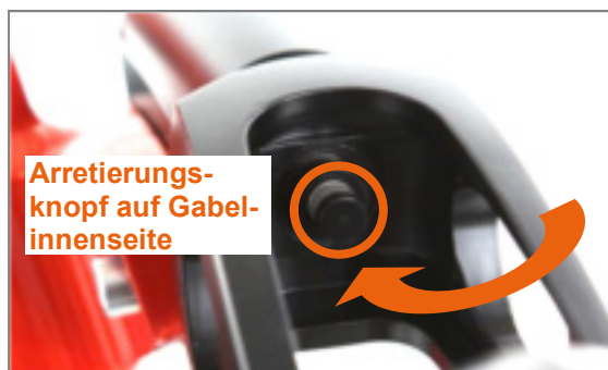
Abbildung 98: Lenkradgabel mit Steckachse und Arretierungsknopf
