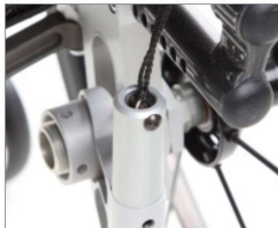
Abbildung 139: M5 Befestigungsschraube durch die Abschlussöse der Zugfeder geschraubt
