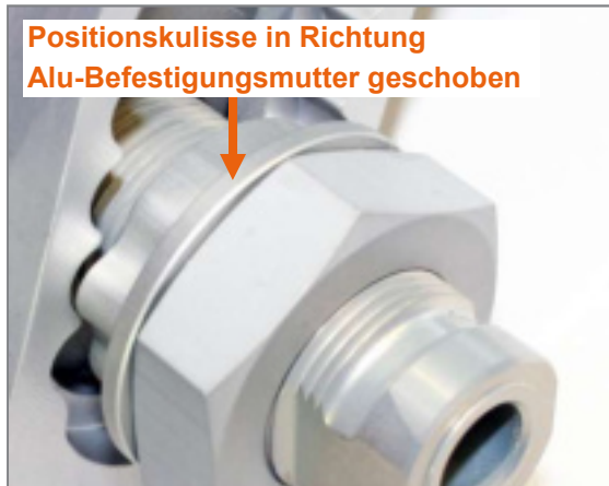
Abbildung 10: Alu-Befestigungsmutter gelöst und Positionskulisse in Richtung Alu-Befestigungsmutter geschoben (Ansicht von Produktaußenseite)
