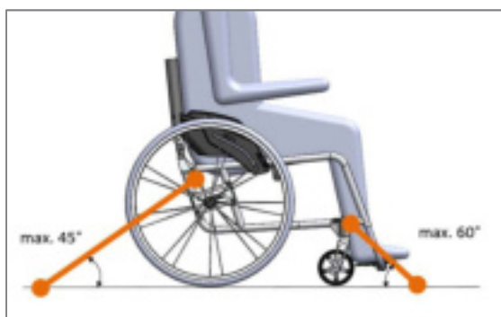
Abbildung 186: Verlauf der Retraktoren vorne und hinten mit maximalem Abspannwinkel und Anbindepunkten (Ansicht von der Seite)
