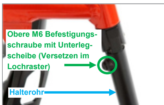
Abbildung 122: Obere M6 Befestigungsschraube (SW 4 mm) kann im Lochraster positioniert werden
