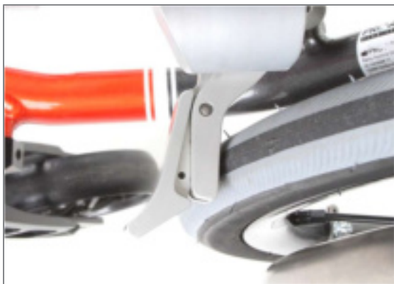
Abbildung 156: Bremsselement an der Bereifung anliegend
