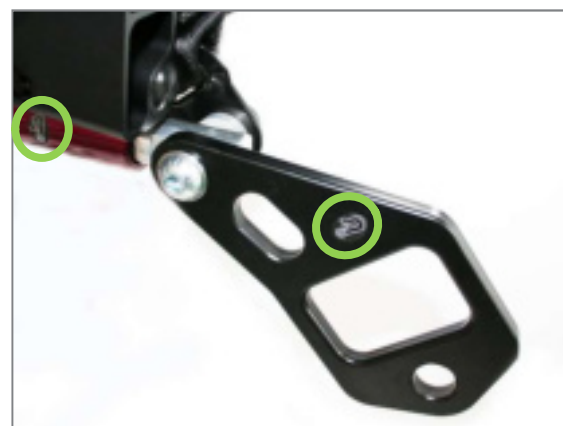
Abbildung 178: Kraftknotenverbindung am hinteren Rahmen mit Gurtöse für Retraktor hinten und Beckengurt
