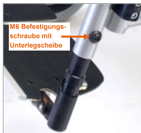
Abbildung 128: M6 Befestigungsschraube mit Unterlegscheibe zur Einstellung der Unterschenkelänge
