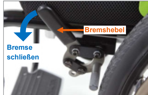
Abbildung 144: Bremse geöffnet; Schließen erfolgt durch nach vorne-unten Drücken des Bremshebels
