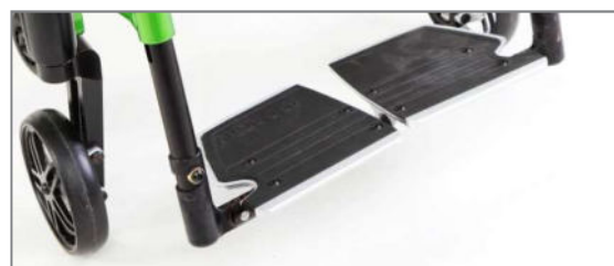
Abbildung 88: Fußstütze mittig geteilt, in Standardposition
