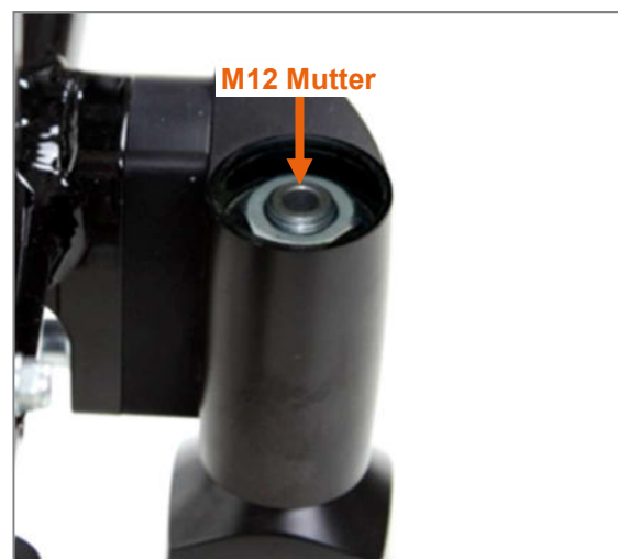
Abbildung 69: Alu-Kappe abgenommen und M12 Mutter sichtbar
