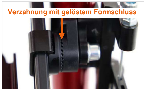
Abbildung 93: Verzahnung am Fußbügelspanner, gelöster Formschluss
