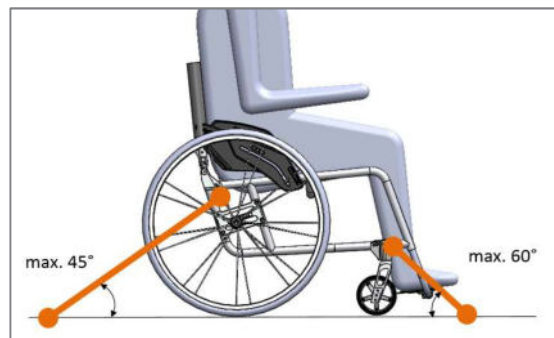
Abbildung 144: Verlauf der Retraktoren vorne und hinten mit maximalem Abspannwinkel und Anbindepunkten (Ansicht von der Seite)
