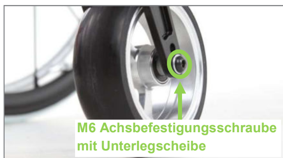
Abbildung 62: M6 Achsbefestigungsschraube der Lenkradachse (Ansicht von Produktaußenseite)
