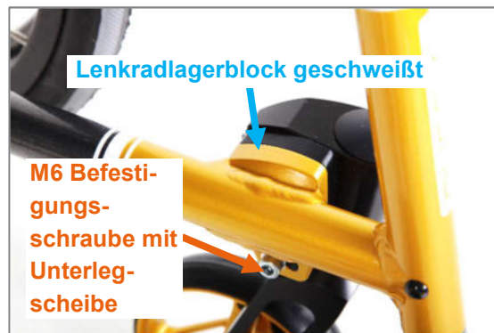
Abbildung 73: M6 Befestigungsschraube an der Rahmeninnenseite mit Unterlegscheibe
