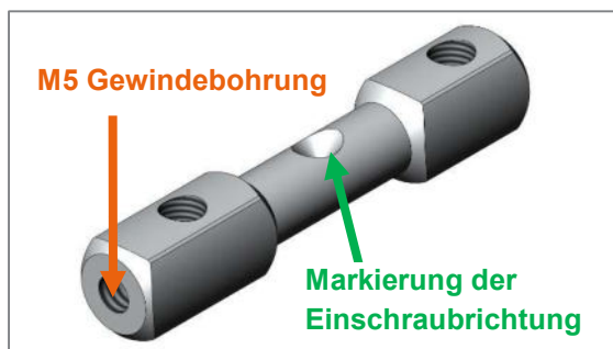
Abbildung 6: Inlett Radplatte 6° mit Gewindebohrung und einseitiger Senkung
