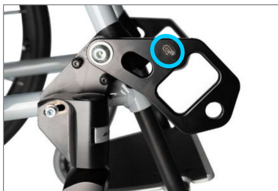
Abbildung 139: Lenkradlagerblockzwischenplatte mit Gurtöse für Retraktor vorne
