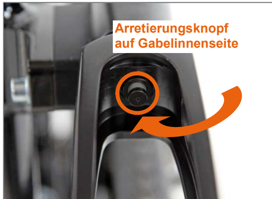
Abbildung 70: Lenkradgabel mit Steckachse und Arretierungsknopf
