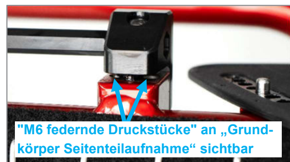
Abbildung 39: Vorderseite der federnden Druckstücke sichtbar (Ansicht von oben)
