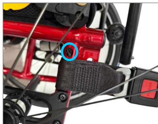
Abbildung 141: Symbol für hintere Befestigung und Umschlaufung des Rollstuhls hinten
