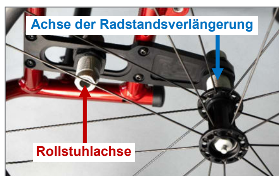
Abbildung 57: Radstandsverlängerung über verlängerte Radplatte
