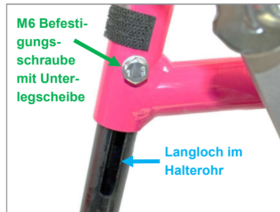
Abbildung 84: M6 Befestigungsschraube mit Unterlegscheibe und Langloch im Fußstützen-Halterohr zur Einstellung der Unterschenkelänge
