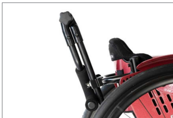
Abbildung 131: Zentral-Schiebegriff mit abfaltbarem Griffbereich komplett abgefaltet
