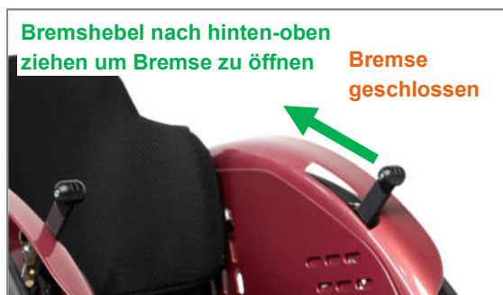
Abbildung 115: Bremse geschlossen; Bremshebel nach hinten ziehen um Bremse zu öffnen
