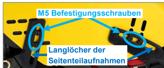
Abbildung 33: M5 Befestigungsschrauben und Langlöcher der Seitenteilaufnahme
