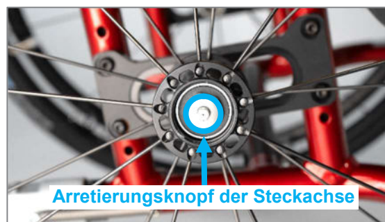
Abbildung 43: Arretierungsknopf der Steckachse in der Mitte der Radachse
