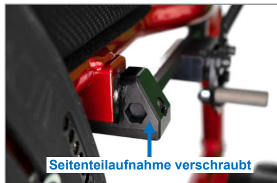
Abbildung 29: „Seitenteilaufnahme verschraubt“ (Ansicht ohne Kleiderschutz)
