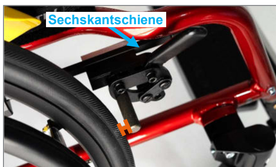
Abbildung 104: Abstand zwischen Bremsbolzen und Bereifung von ca. 3 bis maximal 4 mm bei geöffneter Bremse
