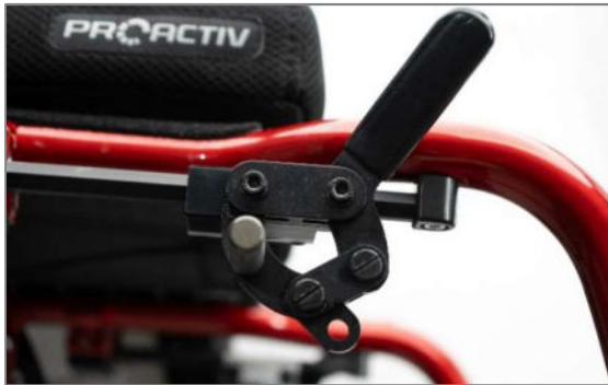
Abbildung 100: Kniehebelbremssystem mit Bremshebel 20° ausgestellt
