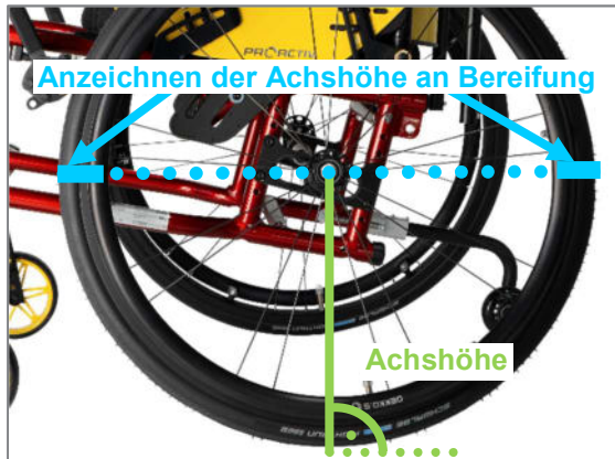
Abbildung 47: Anzeichnen der Achshöhe vorne und hinten auf beiden Reifen
