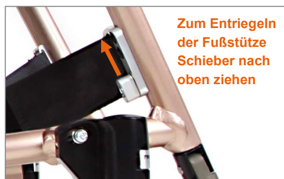
Abbildung 105: Schieber nach oben ziehen, um Fußstütze zu entriegeln
