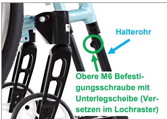
Abbildung 108: Obere M6 Befestigungsschraube kann im Lochraster positioniert werden
