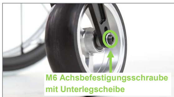
Abbildung 90: M6 Achsbefestigungsschraube der Lenkradachse (Ansicht von Produktaußenseite)
