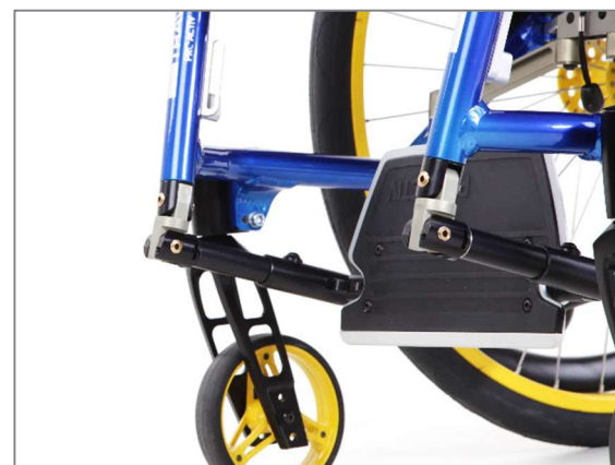
Abbildung 118: Fußstütze nach hinten hochfaltbar mit Federrastmechanismus, Position nach hinten hochgefaltet
