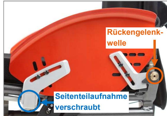
Abbildung 52: Kleiderschutz am Produkt angebracht (Ansicht ohne Antriebsrad)
