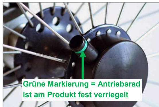
Abbildung 70: Tetra-Clip mit verriegelter Steckachse
