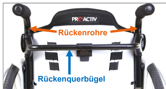
Abbildung 47: Rückenrohre und Rückenquerbügel (Ansicht von hinten)
