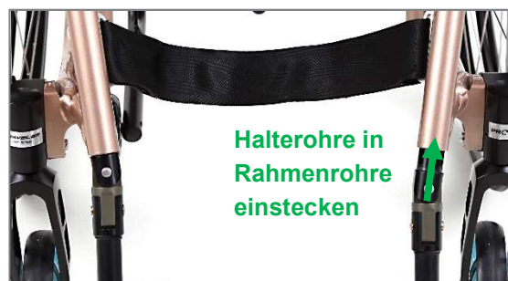
Abbildung 106: Halterohre in Rahmenrohre einstecken bis die Fußstütze mit hörbarem Geräusch arretiert
