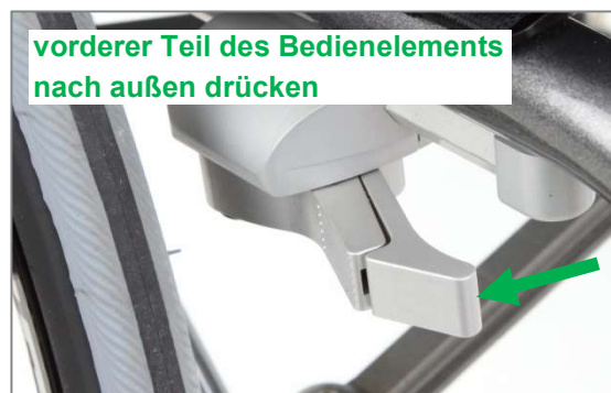
Abbildung 151: Integralbremse geöffnet; Schließen erfolgt durch nach außen Drücken des Bedienelements
