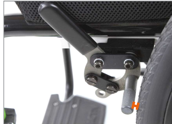
Abbildung 147: Abstand zwischen Bremsbolzen und Bereifung ca. 3 bis maximal 4 mm bei geöffneter Bremse
