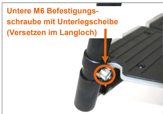
Abbildung 123: Untere M6 Befestigungsschraube (SW 5 mm) kann im Langloch positioniert werden
