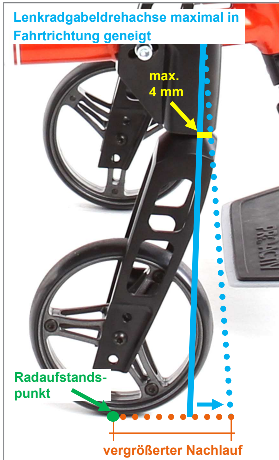
Abbildung 95: Nachlaufvergrößerung über Neigung der Lenkrahmdrehachse
