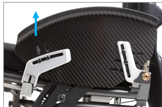
Abbildung 54: Kleiderschutz vorne aus der „Seitenteilaufnahme verschraubt“ gezogen (Ansicht ohne Antriebsrad)
