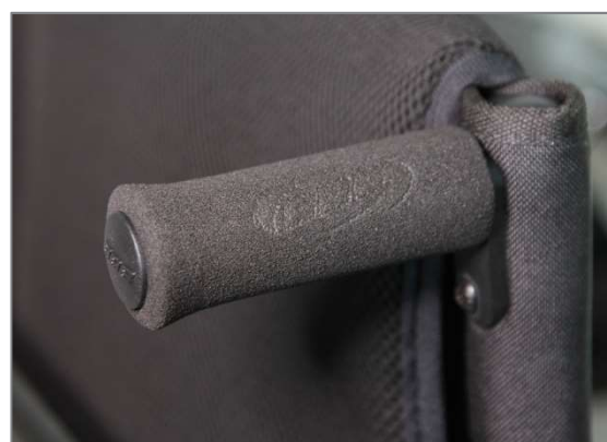
Abbildung 164: Schiebegriffe horizontal im Rückenrohr eingeschraubt
