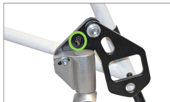
Abbildung 179: Lenradlagerblockzwischenplatte mit Gurtöse für Retraktor vorne
