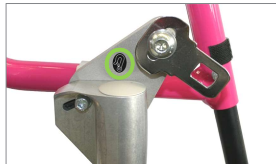
Abbildung 178: Lenradlagerblockzwischenplatte mit Schlosszunge für Retraktor vorne
