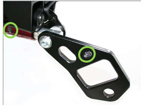
Abbildung 177: Kraftknotenbindung am hinteren Rahmen mit Gurtöse für Retraktor hinten und Beckengurt
