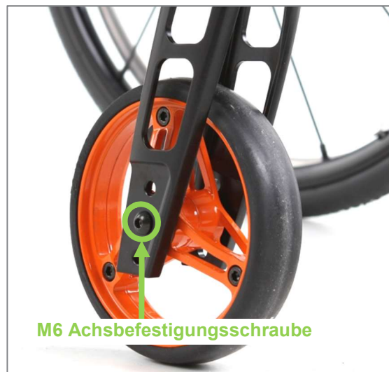
Abbildung 87: M6 Achsbefestigungsschraube der Lenkradachse (Ansicht von Produktaußenseite)
