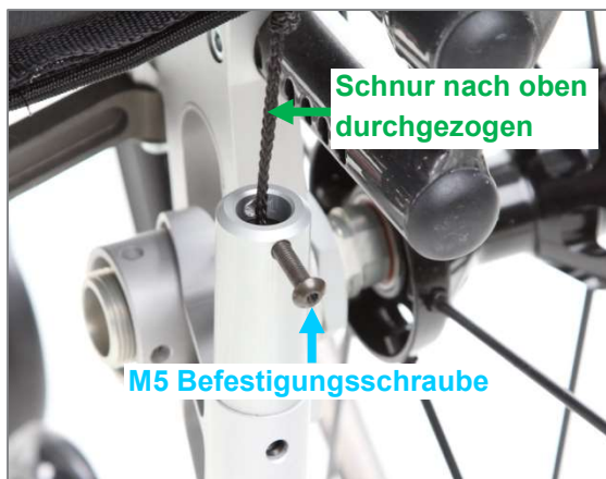
Abbildung 137: Federhaltedom auf Kippstützenadapter aufgesetzt, Schnur nach oben durchgezogen und M5 Befestigungsschraube angesetzt
