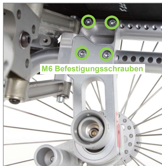
Abbildung 15: M6 Befestigungsschrauben der Radplatte (Ansicht von Produktinnenseite)
