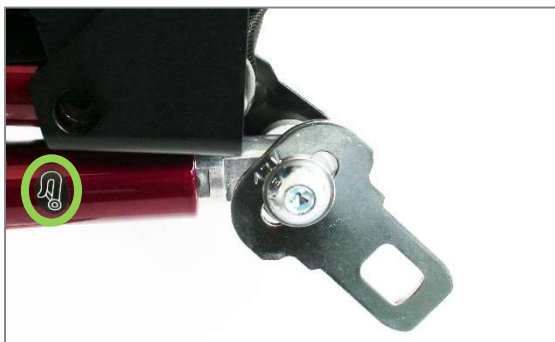
Abbildung 176: Kraftknotenbindung am hinteren Rahmen mit Schlosszungen für Retraktor hinten und Beckengurt (Ansicht von der Seite)
