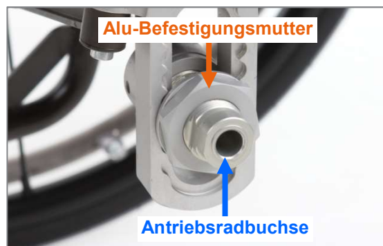
Abbildung 7: Alu-Befestigungsmutter und Antriebsradbuchse (Ansicht von Produktaußenseite)
