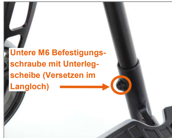
Abbildung 109: Untere M6 Befestigungsschraube kann im Langloch positioniert werden
