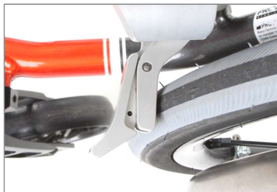
Abbildung 160: Bremselement an der Bereifung anliegend
