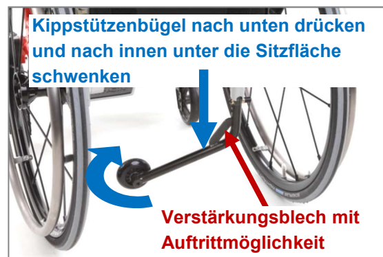
Abbildung 134: Kippstütze in Passivstellung bringen (Ansicht von hinten)
