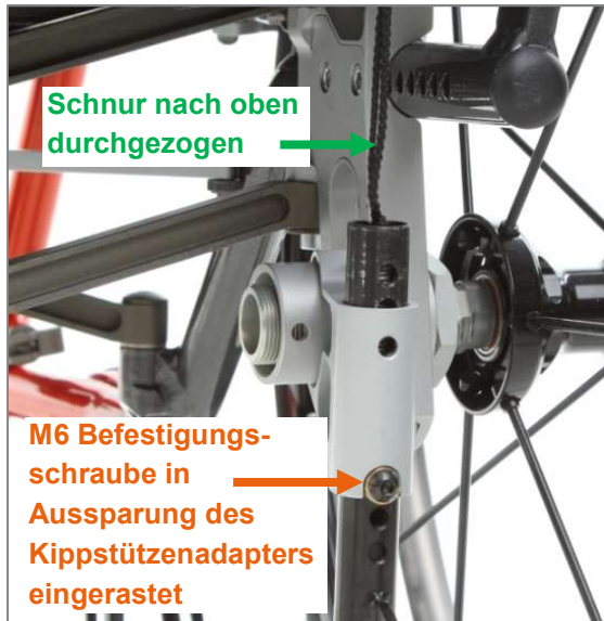
Abbildung 136: Kippstützenbügel in Kippstützenadapter eingesteckt
