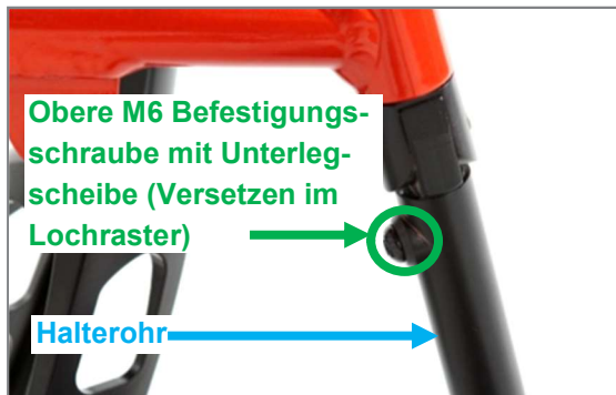
Abbildung 115: Obere M6 Befestigungsschraube (SW 4 mm) kann im Lochraster positioniert werden
