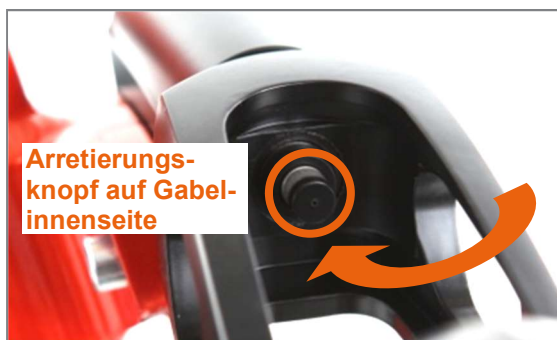
Abbildung 98: Lenkradgabel mit Steckachse und Arretierungsknopf
