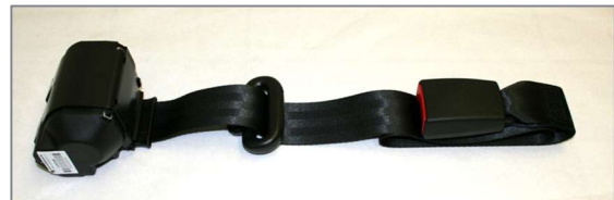
Abbildung 173: Schulterschräggurt automatisch mit Umlenkung und Gurtschloss
