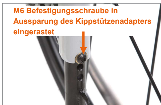
Abbildung 133: Kippstütze ordnungsgemäß eingerastet
