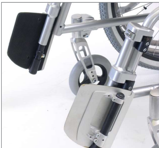
Abbildung 125: Beide Fußstützenteile hochgeklappt und nach außen gedreht
