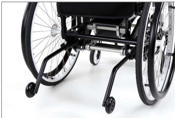
Abbildung 114: Betriebsstellung der Kippstütze (Ansicht von hinten)
