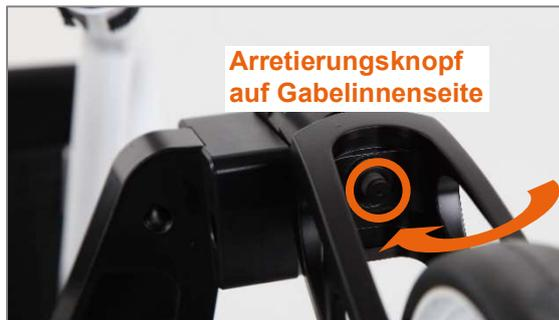
Abbildung 78: Lenkradgabel mit Steckachse und Arretierungsknopf
