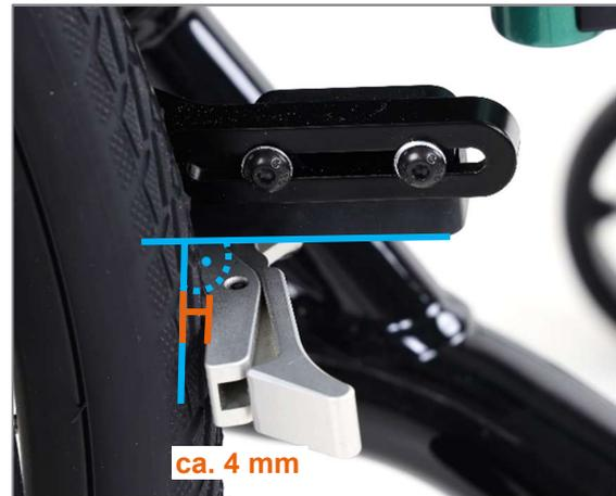
Abbildung 136: Bremselement nach richtiger Positionierung der Integralbremse
