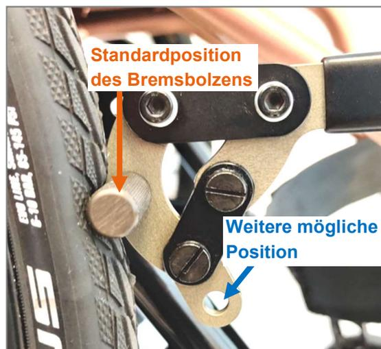
Abbildung 127: Positionen des Bremsbolzens (vorne montiert)
