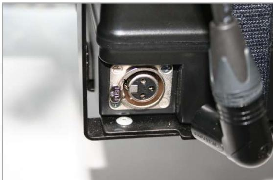
Abbildung 159: Gelöste Steckverbindung
