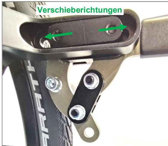
Abbildung 121: Verschieberichtungen (LIFT activ; Ansicht von Rollstuhlinnenseite)
