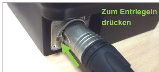
Abbildung 157: Entriegeln des Ladegerät-Steckers
