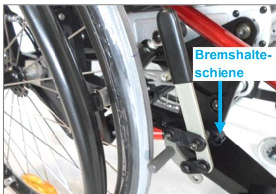
Abbildung 123: Kniehebelbremse (tief montiert), Bremshebel lang; LIFT solid
