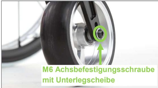
M6 Achsbefestigungsschraube mit Unterlegscheibe
