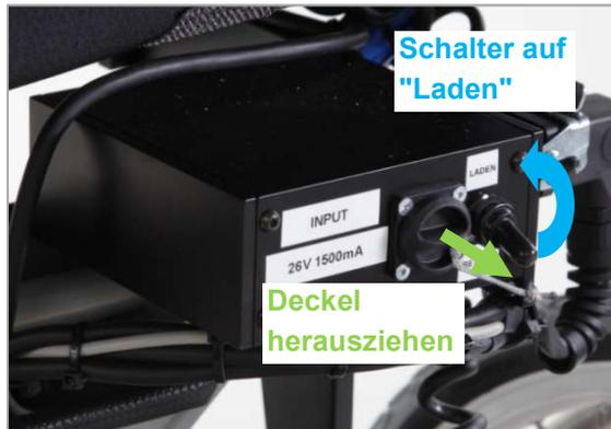
Abbildung 158: Vorbereitung für das Laden an der Rollstuhlrückseite
