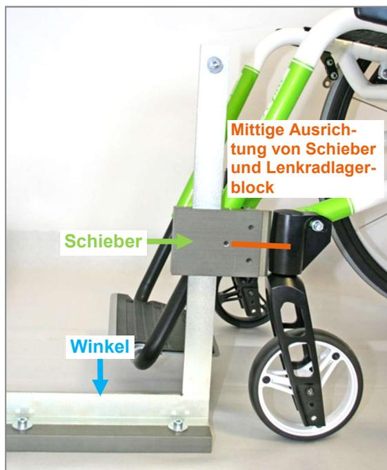
Abbildung 79: Überprüfung der Einstellung der Lenkradgabeldehachsen
