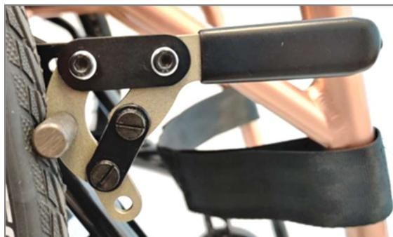
Abbildung 118: Kniehebelbremssystem mit Bremshebel Standard
