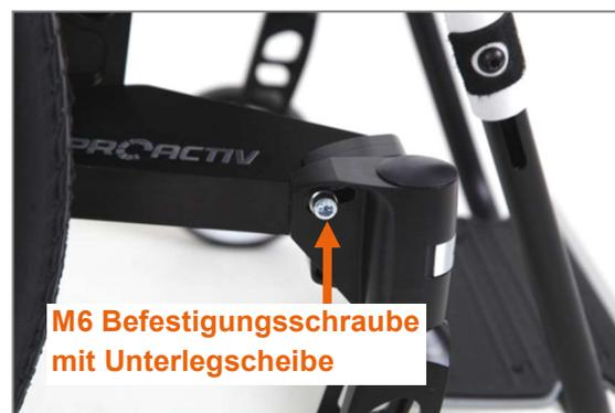
Abbildung 82: M6 Befestigungsschraube an der Rahmenaußenseite mit Unterlegscheibe
