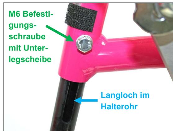
Abbildung 100: M6 Befestigungsschraube mit Unterlegscheibe und Langloch im Fußstützen-Halterohr zur Einstellung der Unterschenkellänge
