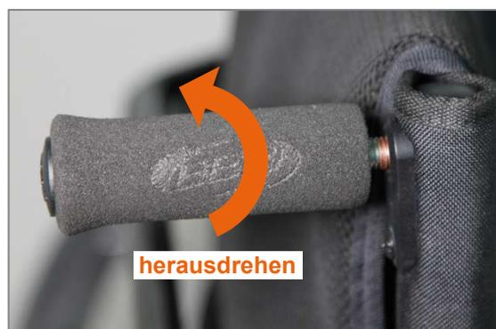
Abbildung 140: Schiebegriff horizontal aus dem Rückenrohr herausdrehen
