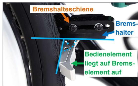
Abbildung 133: Integralbremse geschlossen; Bremselement senkrecht zum Bremshalter
