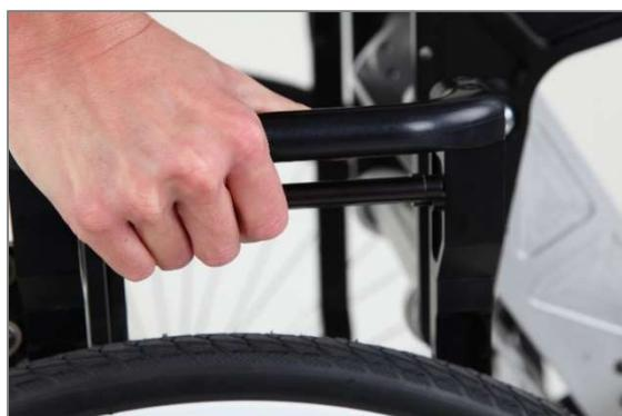
Abbildung 150: Betätigter Auslösemechanismus mechanisch
