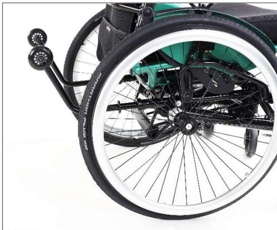
Abbildung 109: Passivstellung der Kippstütze (Ansicht von der Seite)
