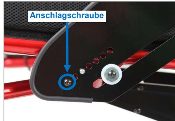
Abbildung 16: Anschlagschraube (Ansicht von Produktaußenseite)
