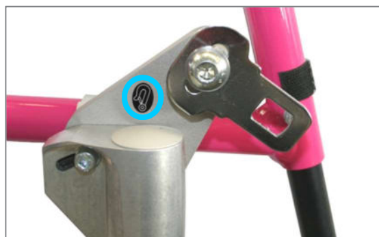
Abbildung 159: Lenkradlagerblockzwischenplatte mit Schlosszunge für Retraktor vorne
