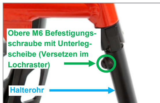
Abbildung 116: Obere M6 Befestigungsschraube (SW 4 mm) kann im Lochraster positioniert werden
