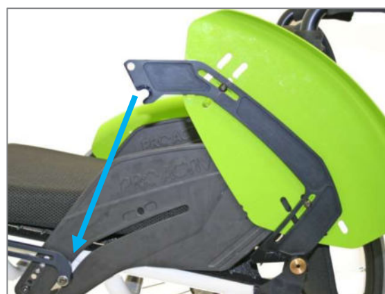
Abbildung 60: Aufnahmebügel auf Rückengelenkwelle aufgesteckt (Ansicht ohne Antriebsrad)
