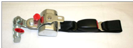
Abbildung 151: Retraktor vorne „Semi-Automatik“ mit Gurtschloss und Schlosszunge
