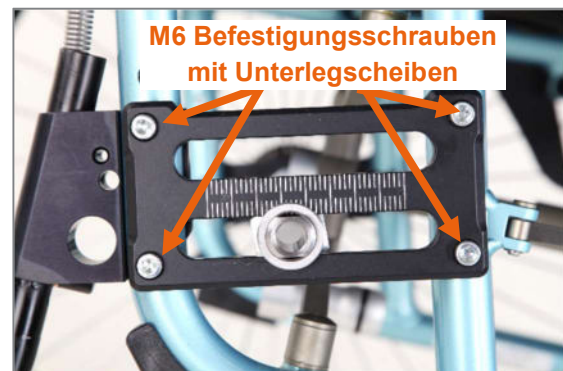
Abbildung 12: M6 Befestigungsschrauben der Radplatte (Ansicht von Produktaußenseite, Antriebsrad abgenommen)
