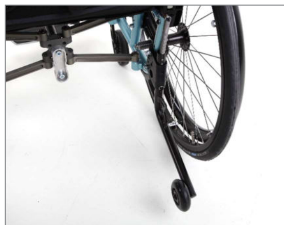
Abbildung 124: Betriebsstellung der Kippstütze (Ansicht von hinten)
