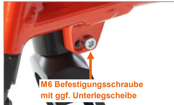
Abbildung 95: M6 Befestigungsschraube an der Rahmeninnenseite, Unterlegscheibe bei G-Form-Rahmen vorhanden, bei V-Form-Rahmen nicht
