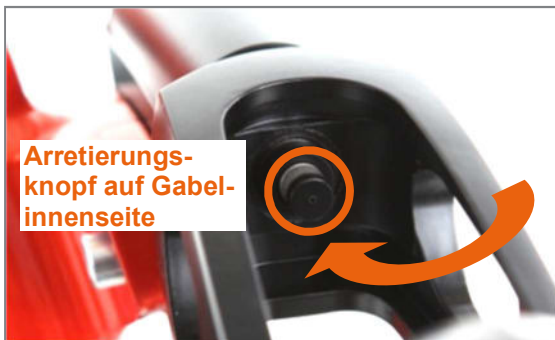
Abbildung 92: Lenkradgabel mit Steckachse und Arretierungsknopf
