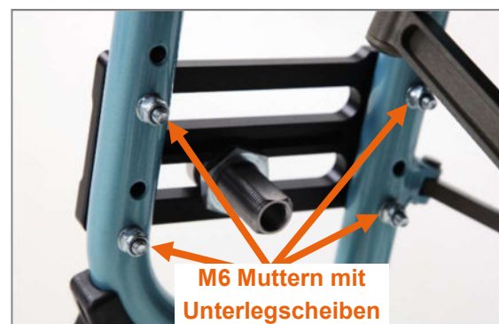
Abbildung 13: M6 Muttern der Radplatte (Ansicht von Produktinnenseite, Antriebsrad abgenommen)
