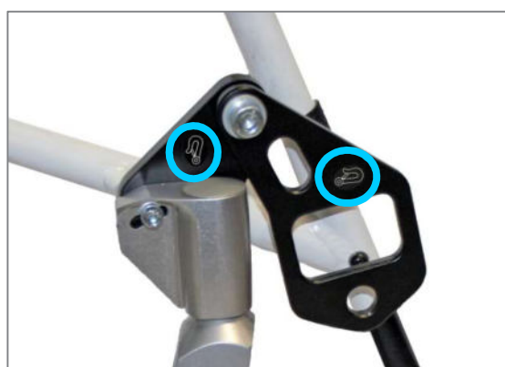
Abbildung 160: Lenkradlagerblockzwischenplatte mit Gurtöse für Retraktor vorne
