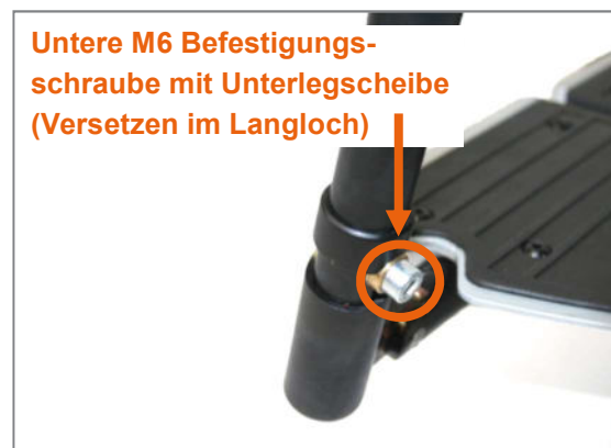
Abbildung 110: Untere M6 Befestigungsschraube (SW 5 mm) kann im Langloch positioniert werden
