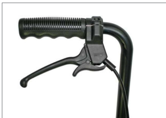
Abbildung 142: Bremsgriff an der Schiebevorrichtung mit Rasthebel
