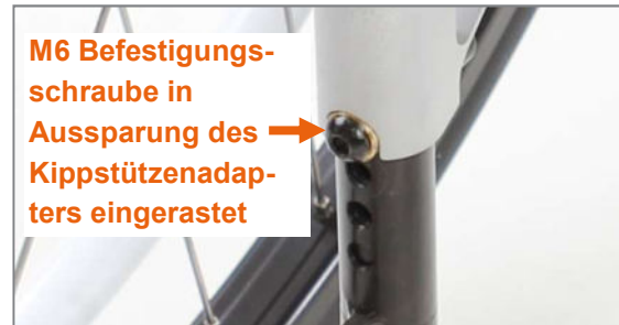
Abbildung 127: Kippstütze ordnungsgemäß eingerastet
