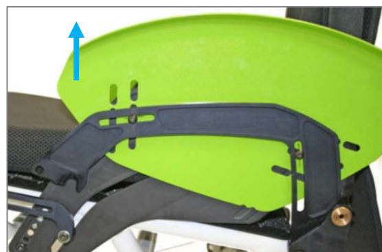
Abbildung 59: Kleiderschutz vorne aus der Seitenblechführung gezogen (Ansicht ohne Antriebsrad)
