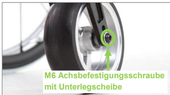
Abbildung 84: M6 Achsbefestigungsschraube der Lenkradachse (Ansicht von Produktaußenseite)
