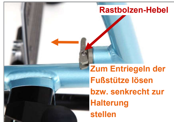
Abbildung 98: Rastbolzen-Hebel in Standardposition, Fußstütze verriegelt; Zur Abnahme der Fußstütze Rastbolzen-Hebel senkrecht stellen
