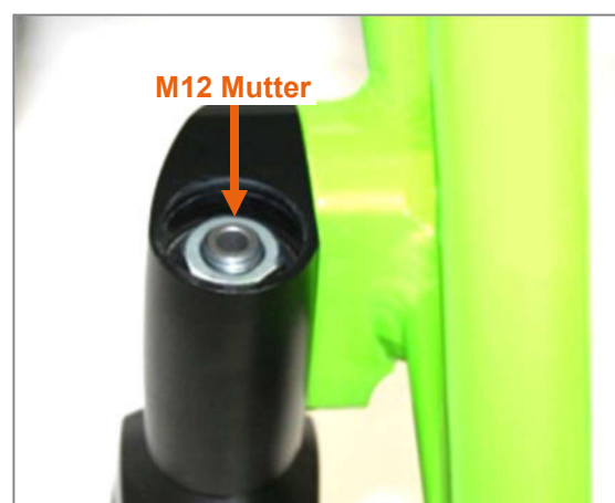
Abbildung 91: Alu-Kappe abgenommen und M12 Mutter sichtbar
