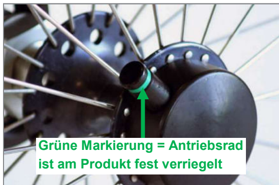
Abbildung 69: Tetra-Clip mit verriegelter Steckachse
