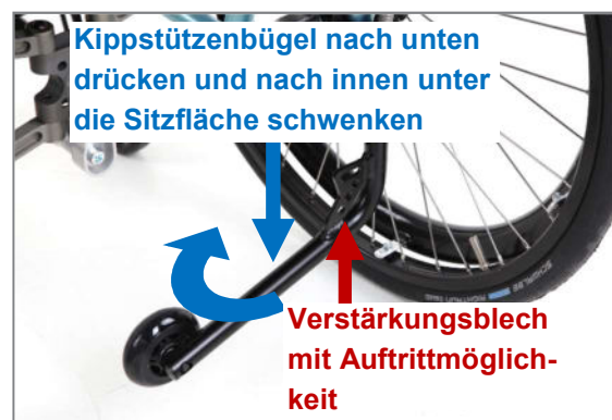
Abbildung 128: Kippstütze in Passivstellung bringen (Ansicht von hinten)
