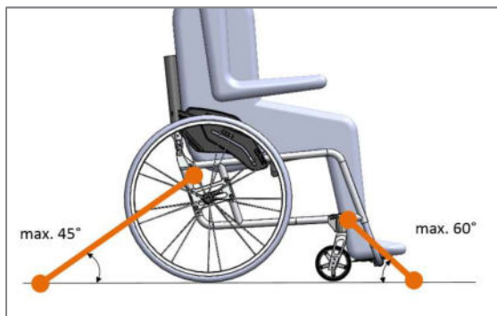
Abbildung 165: Verlauf der Retraktoren vorne und hinten mit maximalem Abspannwinkel und Anbindepunkten (Ansicht von der Seite)
