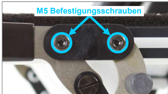
Abbildung 137: M5 Befestigungsschrauben an der Bremshalteschiene
