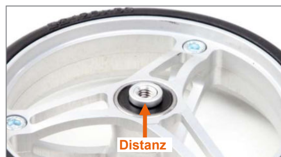
Abbildung 83: Distanz am Lenkrad
