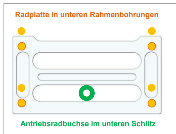
Abbildung 16: Beispielhafte Ausgangsposition zur Verstellung
