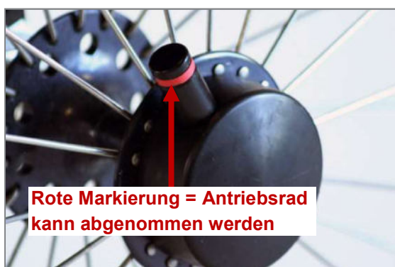
Abbildung 70: Tetra-Clip mit geöffneter Steckachse, Antriebsrad kann abgenommen werden
