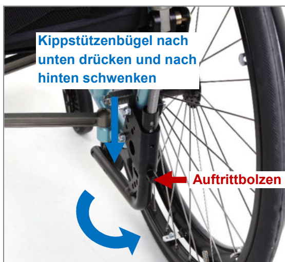
Abbildung 126: Kippstütze in Betriebsstellung bringen (Ansicht von hinten)
