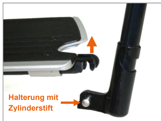
Abbildung 106: Fußbrettauflage aus Halterung gehoben (Produktansicht von vorne)
