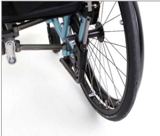
Abbildung 125: Passivstellung der Kippstütze (Ansicht von hinten)
