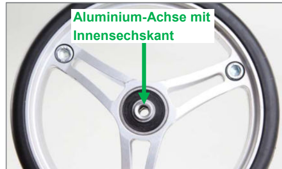
Abbildung 82: Lenkrad mit Aluminium-Innensechskant-Achse
