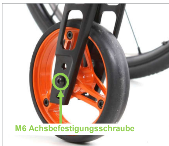
Abbildung 81: M6 Achsbefestigungsschraube der Lenkradachse (Ansicht von Produktaußenseite)
