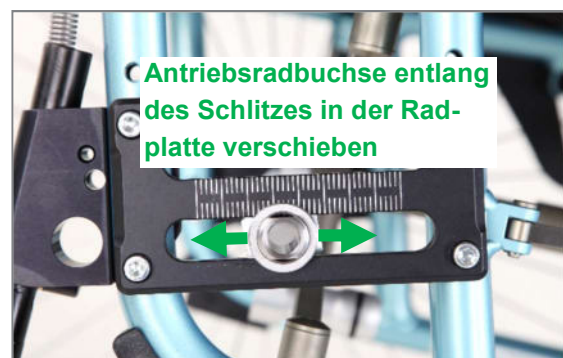
Abbildung 23: Antriebsradbuchse entlang des Schlitzes in der Radplatte verschieben (Ansicht von Produktaußenseite, Antriebsrad abgenommen)
