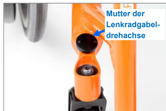
Abbildung 94: Mutter der Lenkradgabeldrehachse vollständig entfernt
