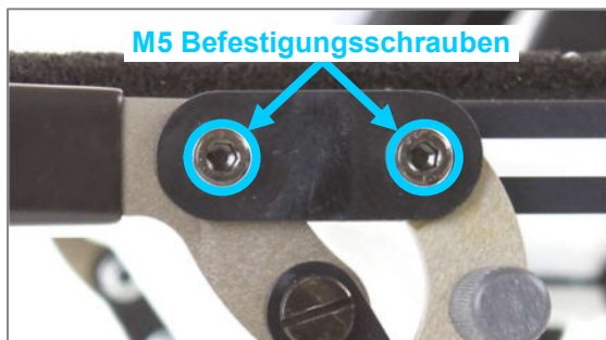
Abbildung 140: M5 Befestigungsschrauben an der Bremshalteschiene
