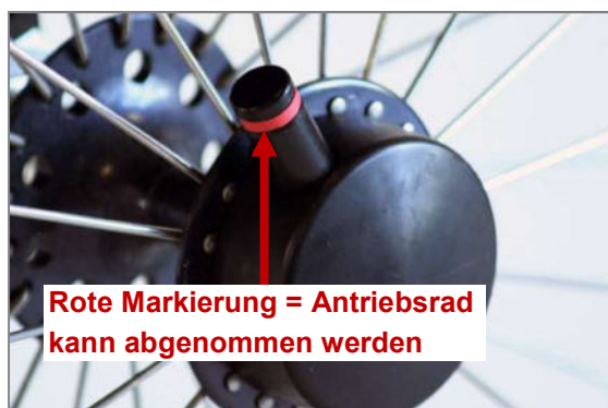
Abbildung 58: Tetra-Clip mit geöffneter Steckachse, Antriebsrad kann abgenommen werden
