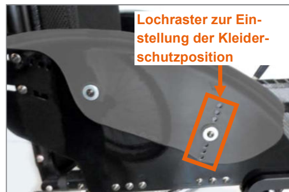
Abbildung 37: Lochraster zur Einstellung der Kleiderschutzposition (Ansicht ohne Antriebsrad)
