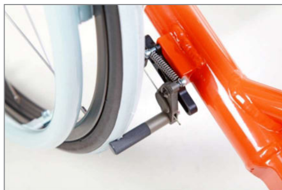
Abbildung 145: Kniehebelbremse mit Seilzugbedien- ung, Bremseinheit
