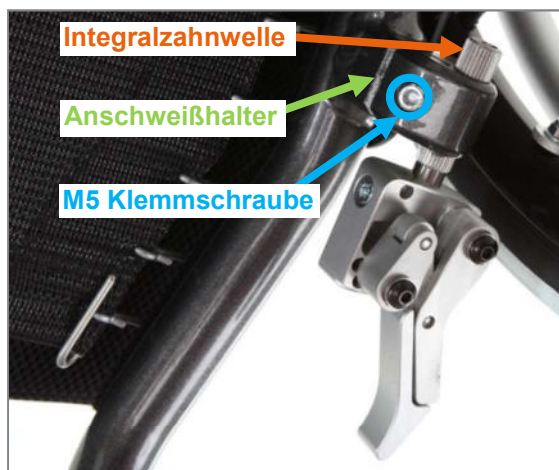
Abbildung 164: Bezeichnungsübersicht der Integralbremse (Produktansicht von unten)
