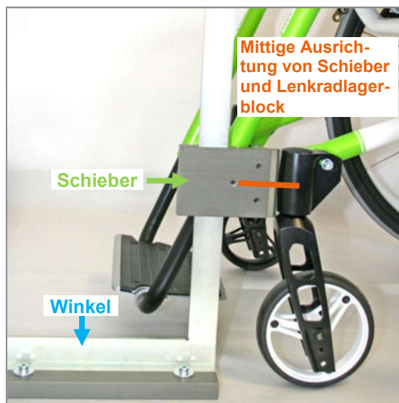
Abbildung 96: Überprüfung der Einstellung der Lenkradgabelrehachsen
