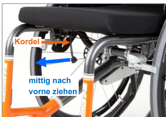
Abbildung 8: Kordel für die Betätigung der Rastbolzen und damit zur Verstellung des Rückenlehnenwinkels
