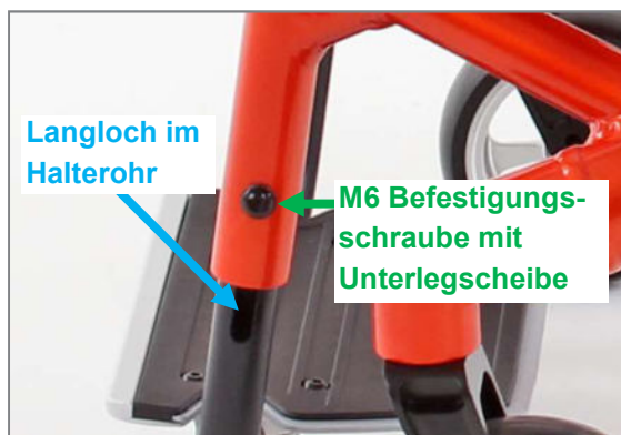
Abbildung 102: M6 Befestigungsschraube mit Unterlegscheibe und Langloch im Fußstützen-Halterohr zur Einstellung der Unterschenkellänge
