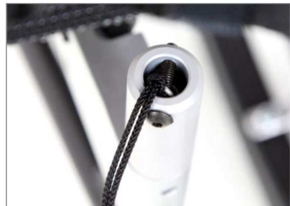
Abbildung 128: M5 Befestigungsschraube durch die Abschlussöse der Zugfeder geschraubt
