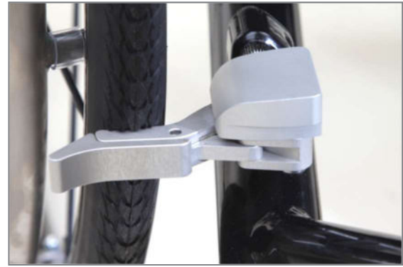
Abbildung 163: Anbringung der Integralbremse am unteren Rahmenrohr
