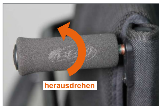
Abbildung 171: Schiebegriff horizontal aus dem Rückenrohr herausdrehen
