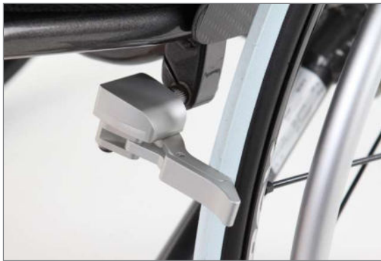
Abbildung 161: Anbringung der Integralbremse am oberen Rahmenrohr
