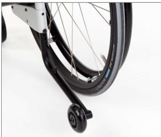
Abbildung 119: Betriebsstellung der Kippstütze (Ansicht von hinten)
