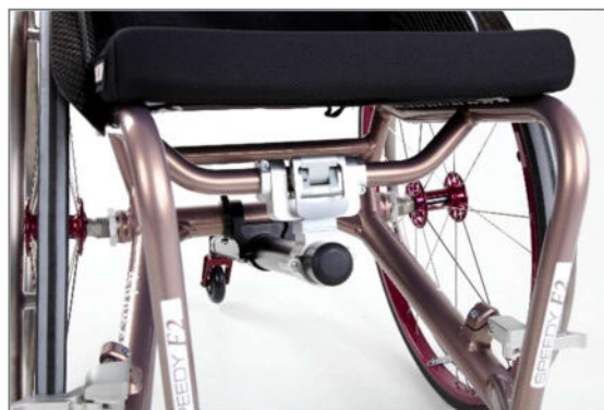
Abbildung 132: Mittelkippstütze abnehmbar (Ansicht von vorne)
