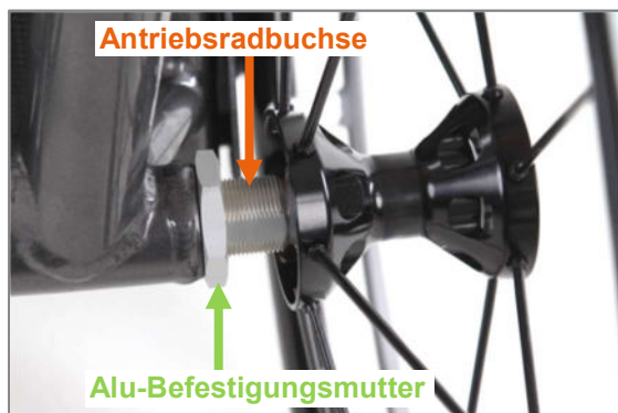
Abbildung 61: Antriebsradbuchse und Alu-Befestigungsmutter (Ansicht von hinten)
