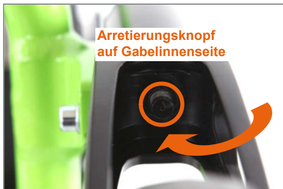
Abbildung 95: Lenkradgabel mit Steckachse und Arretierungsknopf
