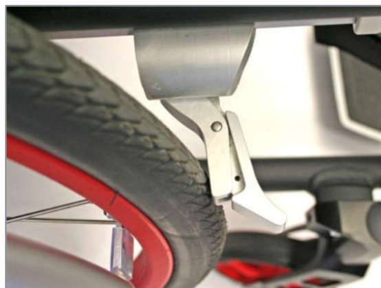
Abbildung 159: Bremselement an der Bereifung anliegend
