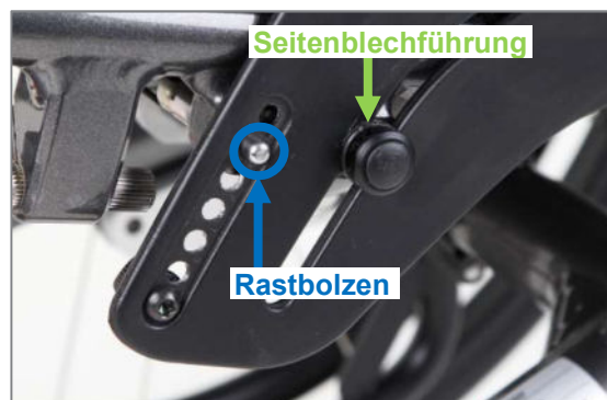
Abbildung 42: Rastbolzen greift in das Arretierungsloch im Seitenteil (Ansicht ohne Kleiderschutz und Ausstattung mit Integralbremse )
