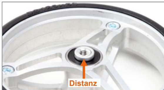
Abbildung 84: Distanz am Lenkrad
