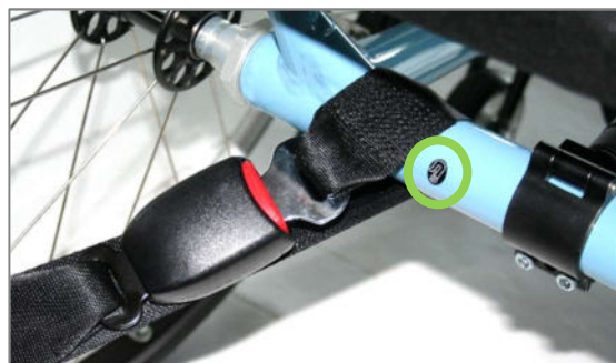
Abbildung 183: Symbol für hintere Befestigung und Umschlaufung des Rollstuhls hinten
