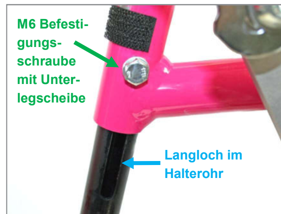
Abbildung 108: M6 Befestigungsschraube mit Unterlegscheibe und Langloch im Fußstützen-Halterohr zur Einstellung der Unterschenkelänge
