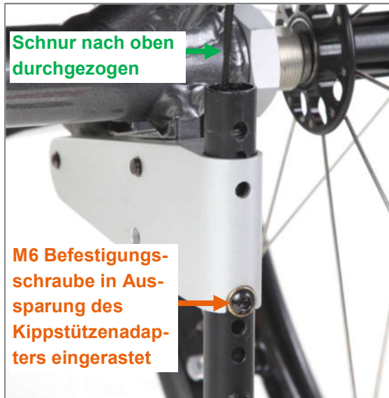
Abbildung 125: Kippstützenbügel in Kippstützenadapter eingesteckt
