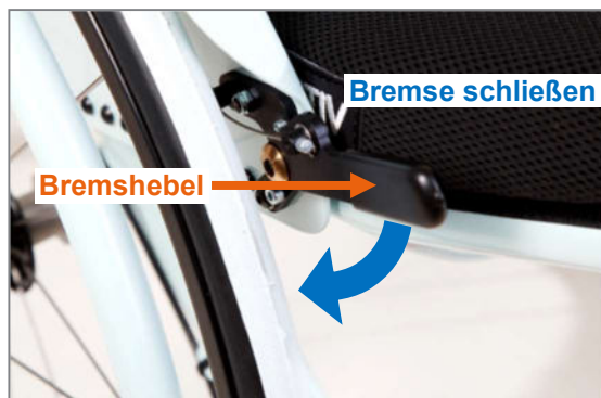
Abbildung 146: Bremse geöffnet; Schließen erfolgt durch nach vorne-unten Drücken des Bremshebels
