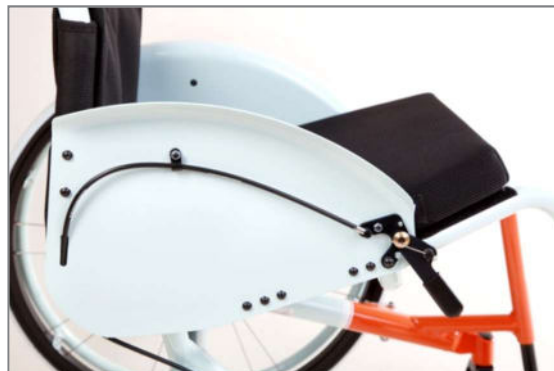
Abbildung 144: Kniehebelbremse mit Seilzugbedien- ung, Bedieneinheit
