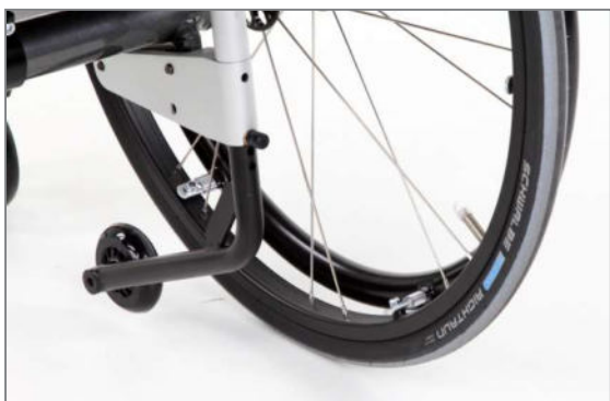
Abbildung 120: Passivstellung der Kippstütze (Ansicht von hinten)
