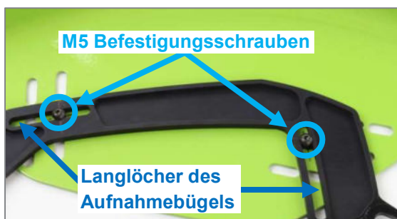
Abbildung 50: M5 Befestigungsschrauben und Langlöcher des Aufnahmebügels
