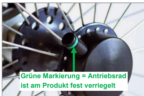
Abbildung 57: Tetra-Clip mit verriegelter Steckachse
