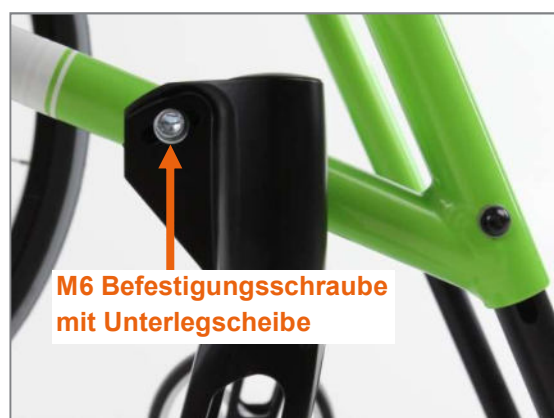
Abbildung 99: M6 Befestigungsschraube an der Rahmenaußenseite
