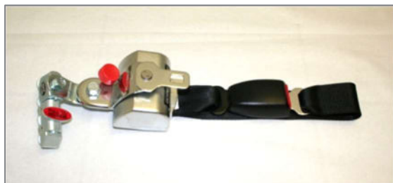
Abbildung 176: Retraktor vorne „Semi-Automatik“ mit Gurtschloss und Schlosszunge
