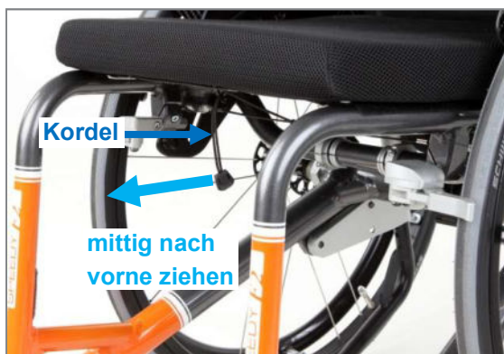
Abbildung 46: Kordel für die Betätigung der Rastbolzen
