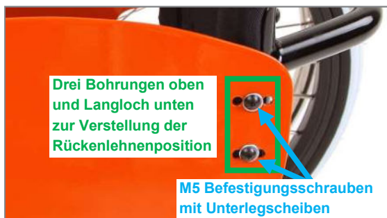
Abbildung 5: Verstellung der Rückenlehnenposition über Bohrungen im Seitenblech bzw. Kleiderschutz
