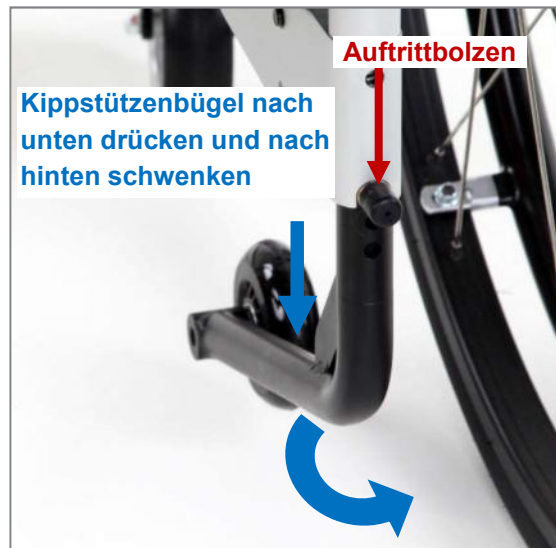
Abbildung 121: Kippstütze in Betriebsstellung bringen (Ansicht von hinten)
