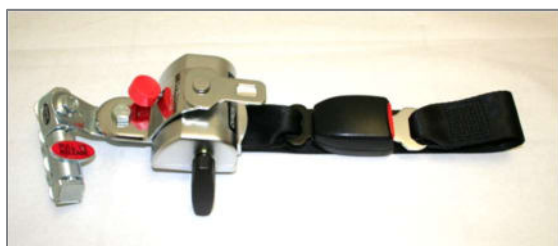
Abbildung 177: Retraktor hinten „Semi-Automatik“ mit Handrad, Gurtschloss und Schlosszunge
