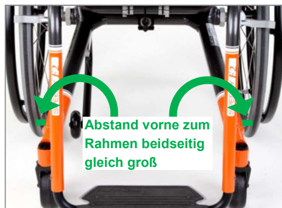
Abbildung 63: Abstand vorne zum Rahmen (SPEEDY F2 oversized)
