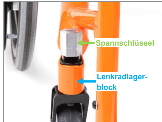
Abbildung 93: Lösen der Mutter der Lenkradgabeldrehachse mit dem Spannschlüssel
