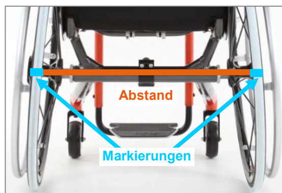
Abbildung 60: Abstand zwischen den Markierungen der Reifen (auf Achshöhe), hinten
