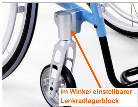
Abbildung 1: Im Winkel einstellbarer Lenkradlagerblock
