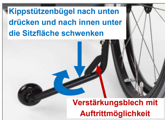
Abbildung 123: Kippstütze in Passivstellung bringen (Ansicht von hinten)
