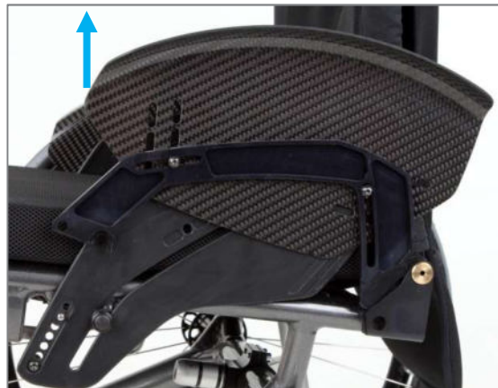
Abbildung 47: Kleiderschutz vorne aus der Seitenblechführung gezogen (Ansicht ohne Antriebsrad)
