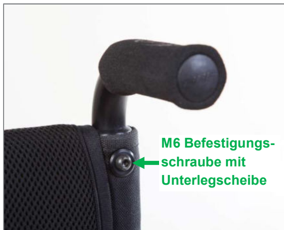
Abbildung 169: Aluminium-Schiebegriffe fest im Rückenrohr montiert
