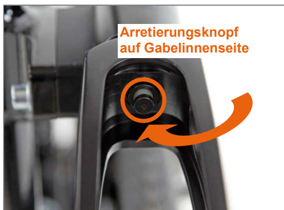
Abbildung 70: Lenkradgabel mit Steckachse und Arretierungsknopf
