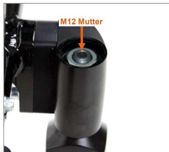
Abbildung 69: Alu-Kappe abgenommen und M12 Mutter sichtbar
