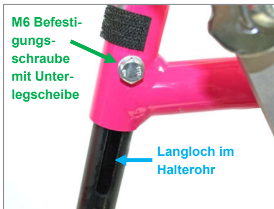
Abbildung 90: M6 Befestigungsschraube mit Unterlegscheibe und Langloch im Fußstützen-Halterohr zur Einstellung der Unterschenkelänge
