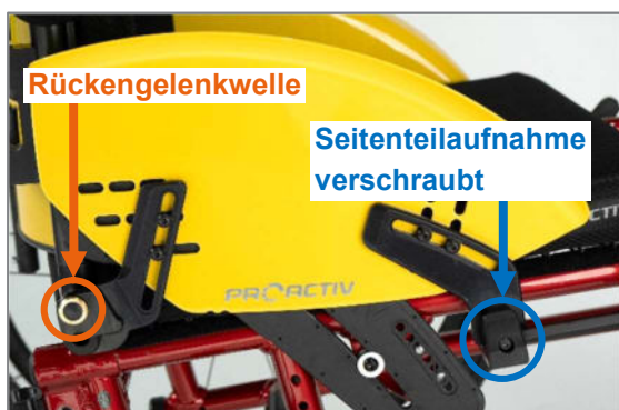
Abbildung 28: Kleiderschutz am Produkt angebracht (Ansicht ohne Antriebsrad)
