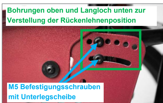
Abbildung 15: Verstellung der Rückenlehnenposition über Bohrungen im Seitenteil
