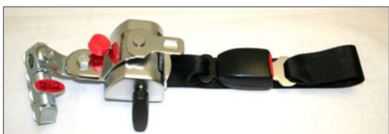
Abbildung 133: Retraktor hinten „Semi-Automatik“ mit Handrad, Gurtschloss und Schlosszunge
