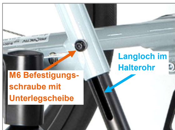
Abbildung 77: M6 Befestigungsschraube mit Unterlegscheibe und Langloch im Fußstützen-Halterohr zur Einstellung der Unterschenkelänge
