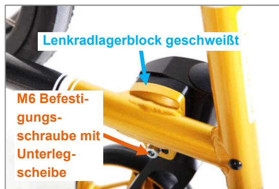
Abbildung 73: M6 Befestigungsschraube an der Rahmeninnenseite mit Unterlegscheibe
