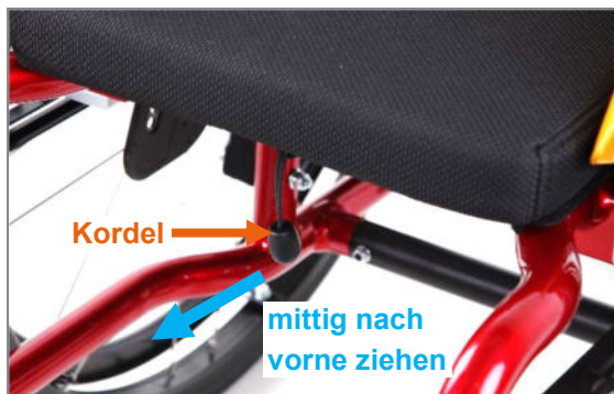
Abbildung 17: Kordel für die Betätigung der Rastbolzen und damit zur Verstellung des Rückenlehnenwinkels
