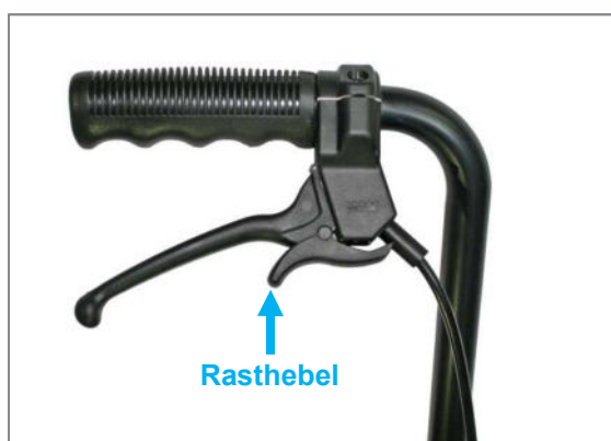
Abbildung 113: Bremsgriff an der Schiebevorrichtung mit Rasthebel
