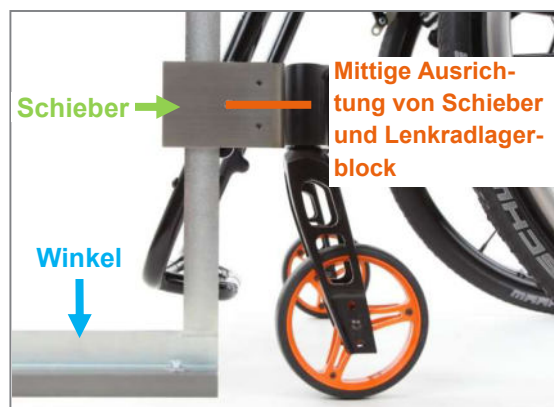
Abbildung 71: Überprüfung der Einstellung der Lenkradgabel-drehachsen
