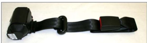
Abbildung 135: Schulterschräggurt automatisch mit Umlenkung und Gurtschloss
