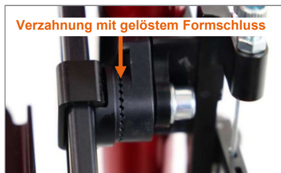
Abbildung 93: Verzahnung am Fußbügelspanner, gelöster Formschluss
