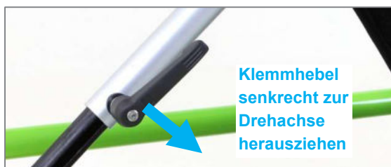
Abbildung 36: Klemmhebel durch Herausziehen in andere Winkelposition bringen
