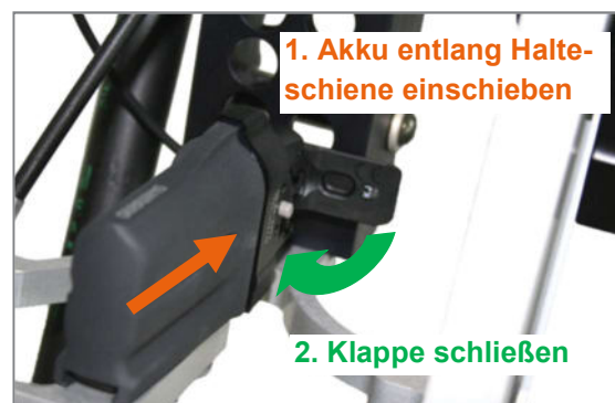
Abbildung 18: Akku nach dem Laden wieder anschließen
