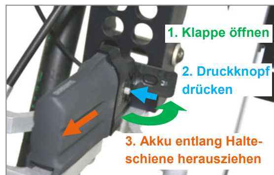
Abbildung 16: Akku zum Laden entnehmen
