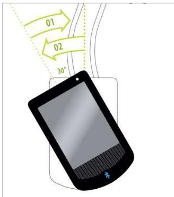
Abbildung 29: Anbringung und Abnahme des Displays
