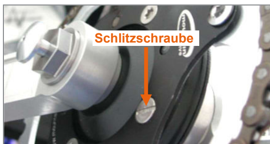
Abbildung 20: Schlitzschraube zum Fetten
