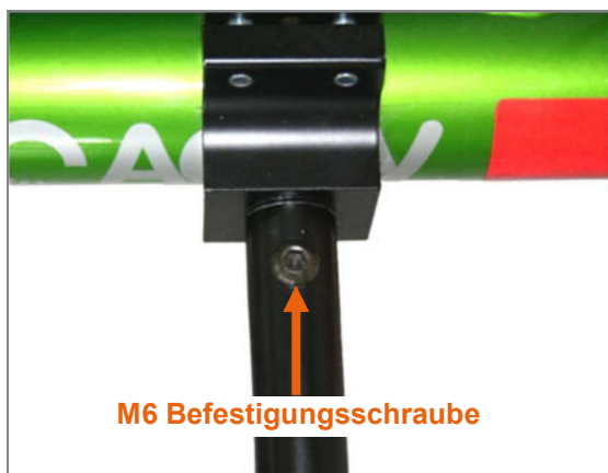
Abbildung 46: M6 Befestigungsschrauben an den Klemmschellen am Achsrohr
