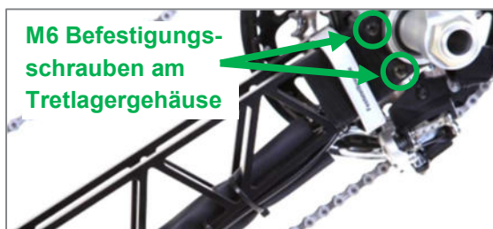
Abbildung 6: M6 Befestigungsschrauben am Tretlagergehäuse
