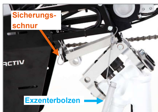
Abbildung 62: Einhängemaul der Antriebseinheit an der Einhängewelle am Chassis eingehängt, Exzenterbolzen noch nicht eingesteckt
