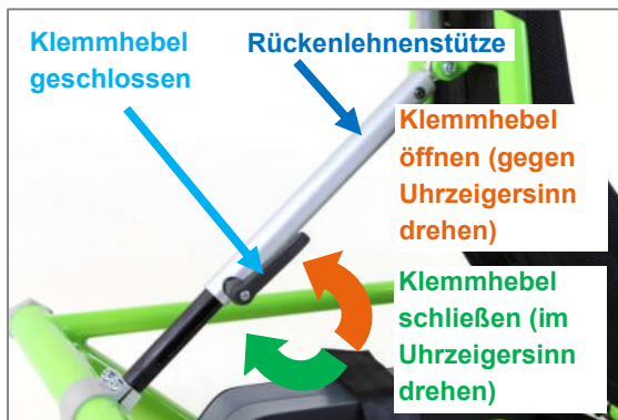
Abbildung 35: Winkelverstellung der Rückenlehne über Klemmhebel
