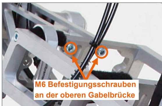
Abbildung 5: M6 Befestigungsschrauben an der oberen Gabelbrücke
