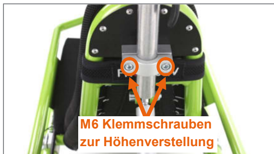
Abbildung 41: Höhenverstellung der Nackenstütze über zwei M6 Klemmschrauben am Nackenstützenhalterrohr
