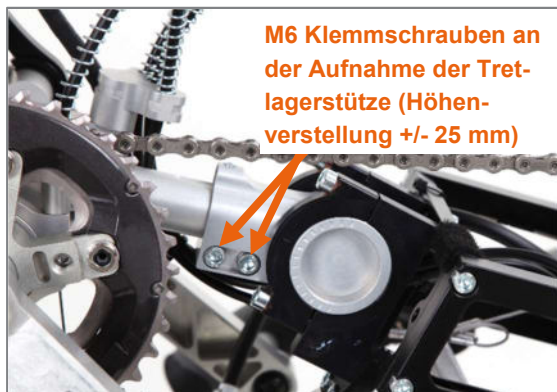
Abbildung 8: M6 Klemmschrauben für die Höhenverstellung der Tretlagerposition
