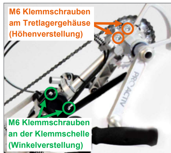
Abbildung 7: M6 Klemmschrauben für Winkel- und Höhenverstellung der Tretlagerposition
