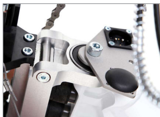
Abbildung 61: Einhängemaul der Antriebseinheit rutscht unter die Einhängewelle am Chassis
